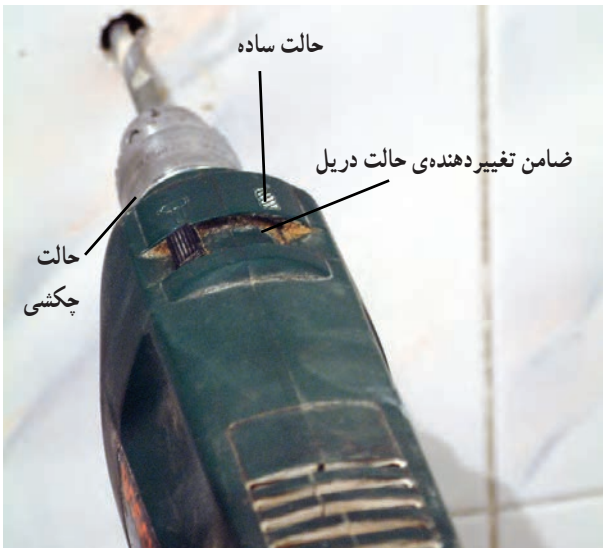
شکل ۲۱۲-۳ سوراخ کردن محل علامت‌گذاری شده
