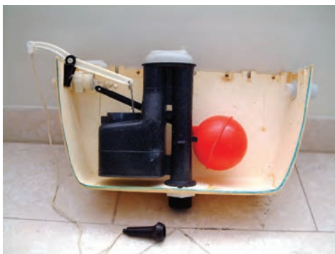
شکل ۲۳۴-۳- یک مخزن فشاری برش خورده با لوازم کامل آن
