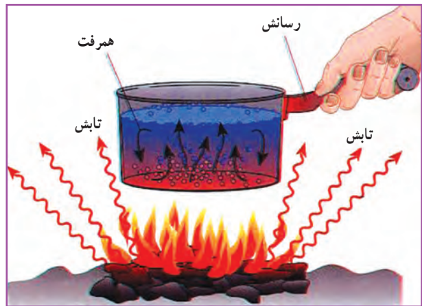
شکل ۱۱- انتقال گرما به هر سه روش
