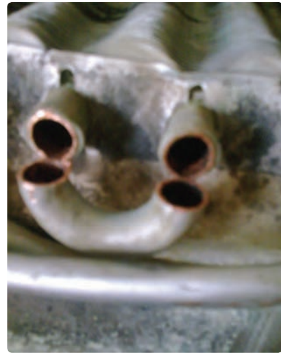
شکل ۱۳- تشکیل رسوب در نقطه بالای شمعک
