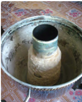
شکل ۸- تشکیل رسوب در سماور و لوله‌ها
