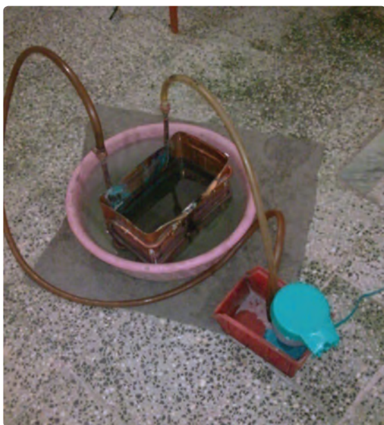
شکل ۱۹- رسوب‌زدایی با پمپ
