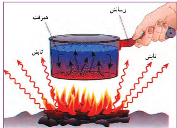
شکل ۱۱- انتقال گرما به هر سه روش
