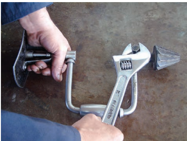
شکل ۲-۱۷ - محکم کردن پیچ اتصال پارچه‌ی برقو به بدنه
