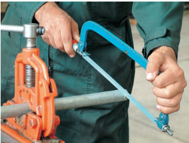
شکل ۵۰-۱- عدم رعایت فاصله‌ی مناسب از لب گیره
