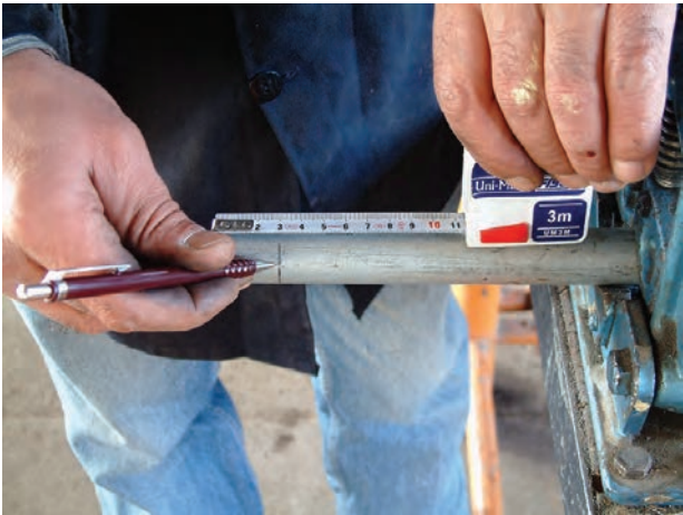
شکل ۱-۵۳ - مشخص کردن محل برش
