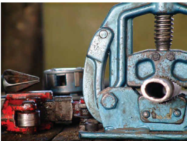
شکل ۲-۱۶ - لوله‌ی دو پهن شده
