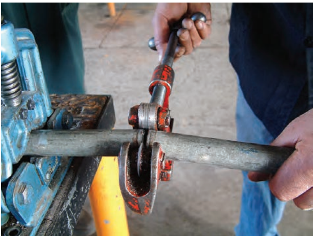
شکل ۱-۵۹- انتهای عمل بُرش‌کاری
