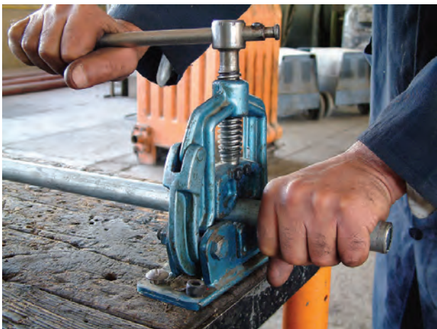
شکل ۱-۳۵ - بستن لوله به گیره برای ارّه کاری
