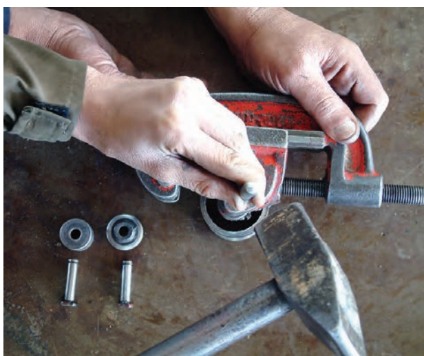
شکل ۱-۱۹- خارج کردن بین‌ها به وسیله‌ی سنبه‌نشان و چکش فلزی
