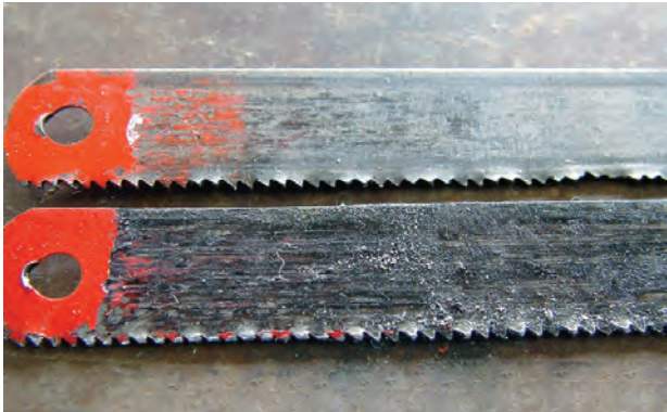
شکل ۱-۴۷- تیغه اره‌های دندان‌های شکسته شده
