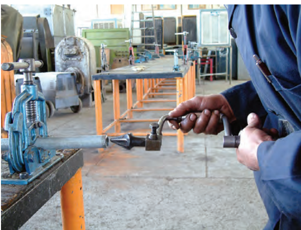
شکل ۱۸-۲- قرار دادن برقو در داخل لوله‌ی بسته شده به گیره
