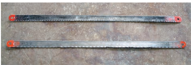
شکل ۱-۴۰ - از بین رفتن دندان‌های تیغه اژه
