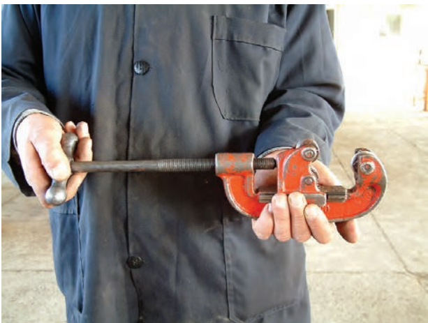
شکل ۱-۵۴ - باز کردن دهانه‌ی لوله‌بر
