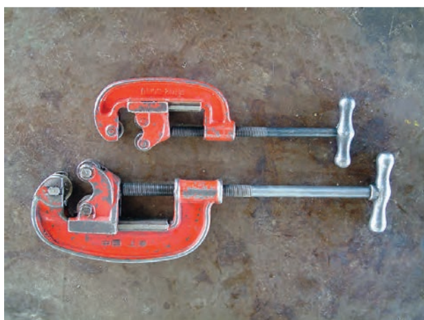
شکل ۱-۶۳- لوله‌بر در دو اندازه‌ی متفاوت
