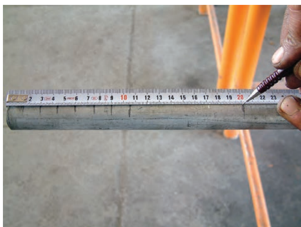
شکل ۱-۶۴- خط کشی کردن لوله
