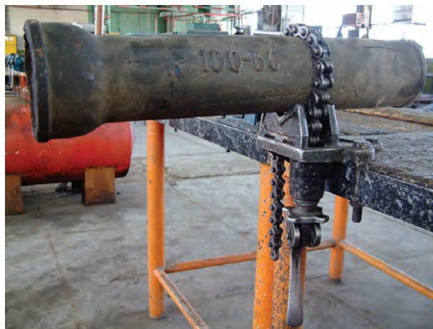
شکل ۱-۳۴- بستن لوله به گیره‌ی زنجیری
