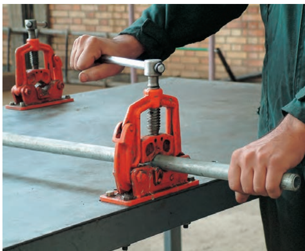
شکل ۱-۲۸- بستن لوله به گیره‌ی لوله
