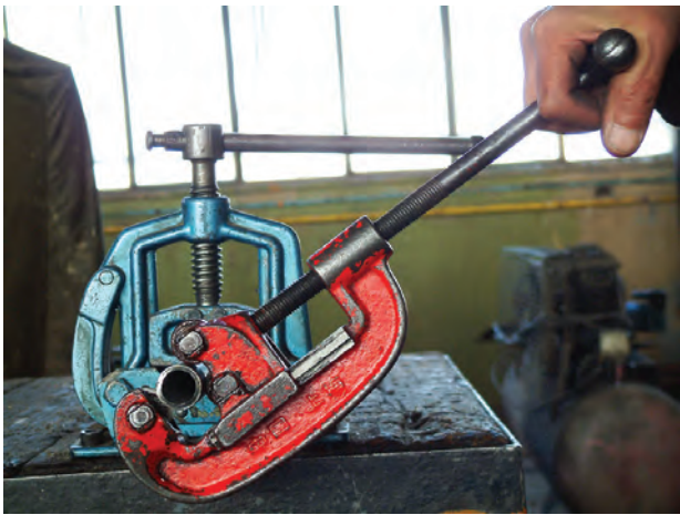
شکل ۱-۵۶- گرداندن لوله‌بر به دور لوله
