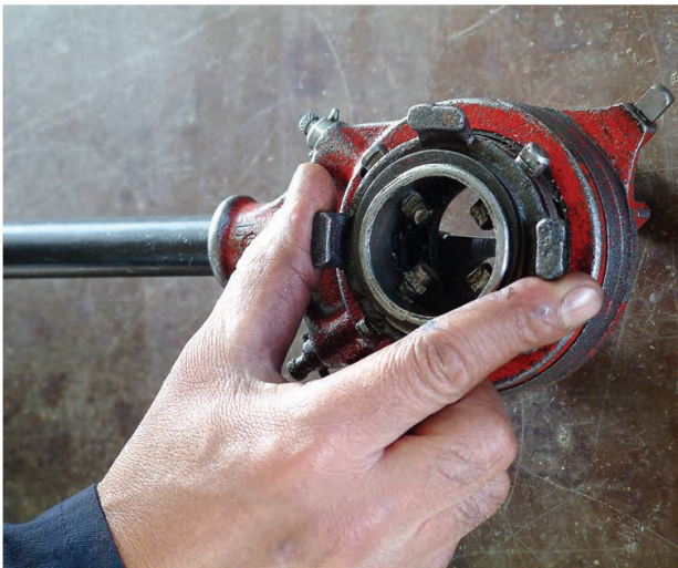
شکل ۴-۲۱- فلکه‌ی چهار نظام حدیده‌ی دستی دو پارچه
