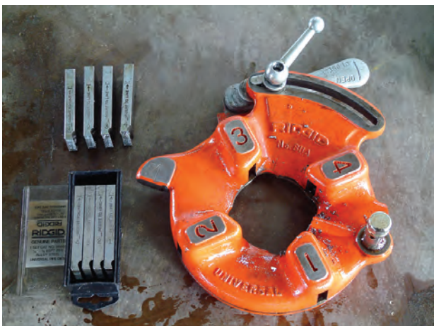
شکل ۸۸-۴- تنه‌ی حدیده و پارچه‌های آن
