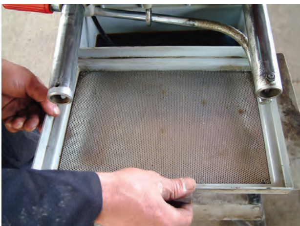
شکل ۸۷-۴- گذاردن صفحه‌ی مشبک پس از تمیز کردن آن بر روی مخزن روغن
