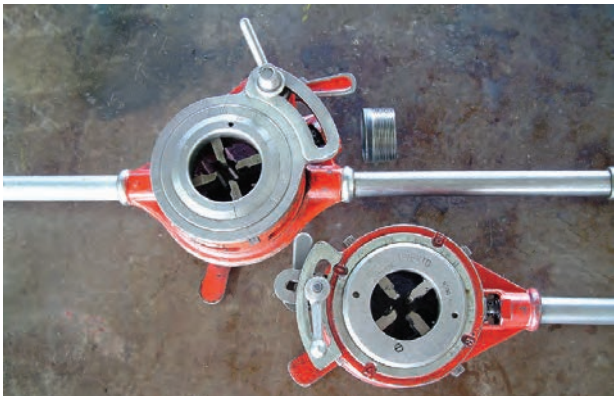
شکل ۴-۵۱- حديد‌هاي دستي چهارپارچه‌ي يك دسته و دو دسته
