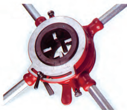
شکل ۴-۵۲- حديد‌ي چهار پارچه‌ي چهار دسته
