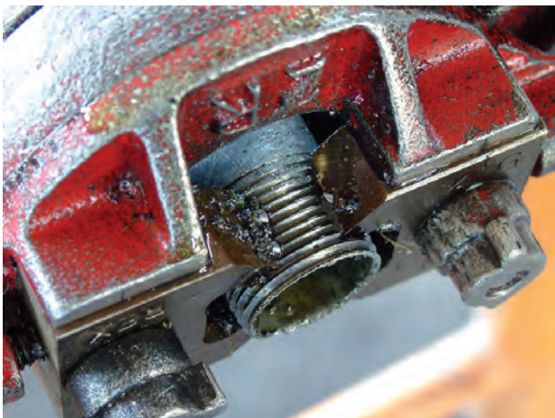
شکل ۴-۳۶- عبور دو دندانه از انتهای پارچه
