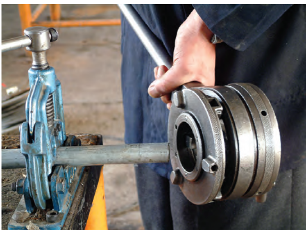
شکل ۴-۶۳- شروع حدیده کاری
