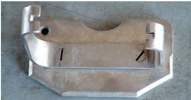
شکل ۴-۵- اتصال موقت با استفاده از پیچ
