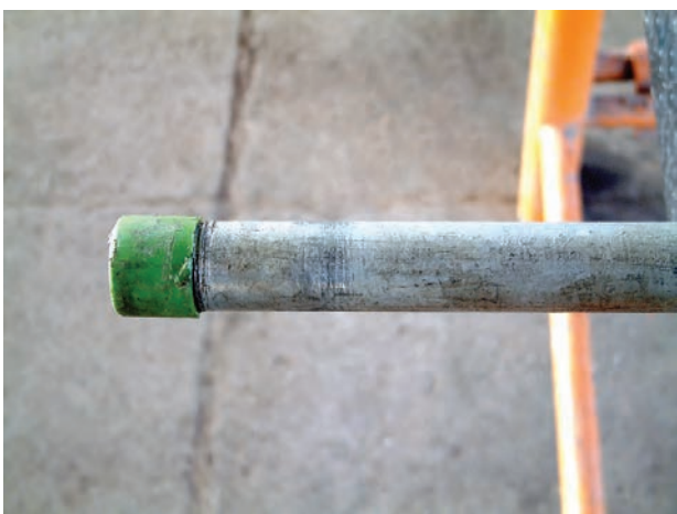
شکل ۴-۱۶ اتصال بوشن پلاستیکی به سردنده‌ی لوله
