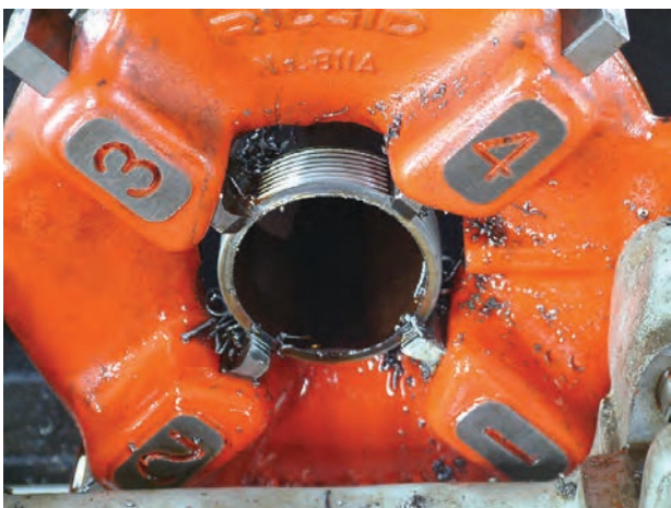
شکل ۴-۸۰- لوله در حال باز شدن از پارچه‌ها
