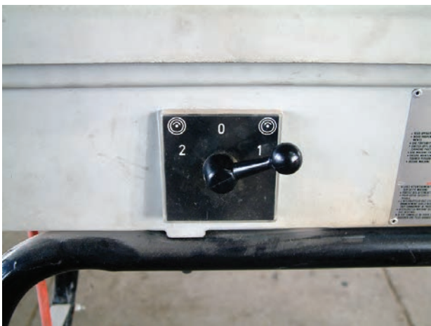
شکل ۴-۷۹- کلید خاموش و روشن کردن حدیده‌ی ماشینی
