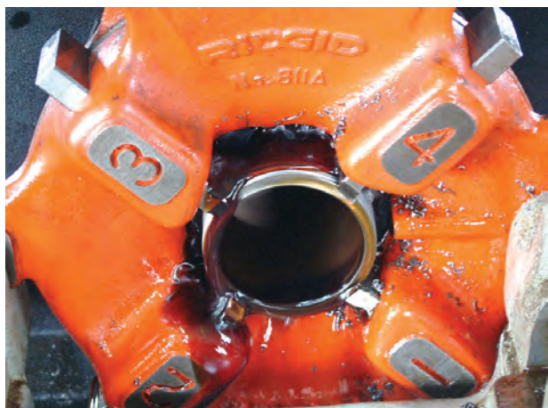
شکل ۴-۹۵- عمل حدیده‌کاری به وسیله حدیده‌ی ماشینی
