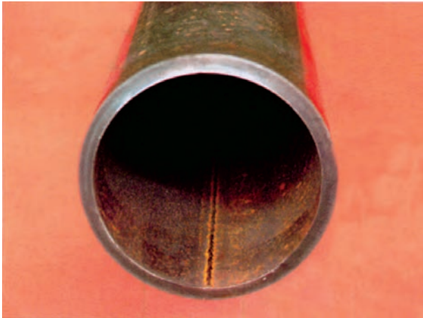
شکل ۴-۱۱- لوله‌ی فولادی سیاه درزدار
