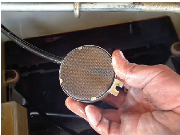
شکل ۸۴-۴- پمپ روغن حدیده‌ی ماشینی
