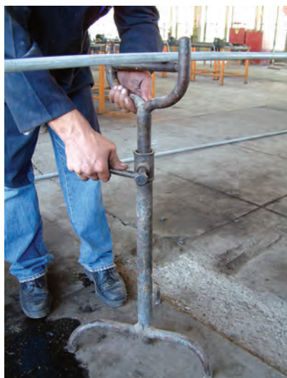
شکل ۴-۷۶- طرز تنظیم خرک به زیر لوله
