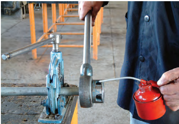
شکل ۴-۴۹- روغن کاری محل تماس پارچه‌ها با لوله
