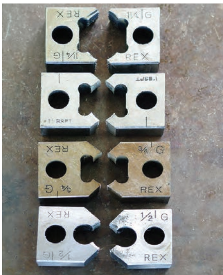
شکل ۴-۲۳- پارچه‌های حدیده‌ی دستی دو پارچه
