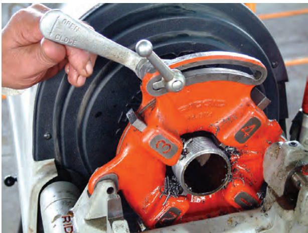
شکل ۴-۷۸- عمل حدیده‌کاری با حدیده‌ی ماشینی
