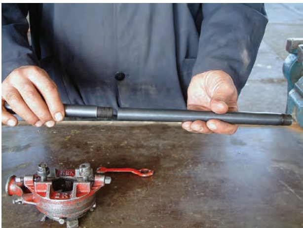
شکل ۴-۲۴- اتصال دسته‌ی دو تکه به یک‌دیگر
