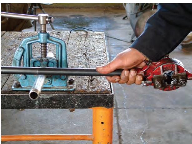
شکل ۴-۴۰- جدا کردن پلیسه‌ها از سردنده
