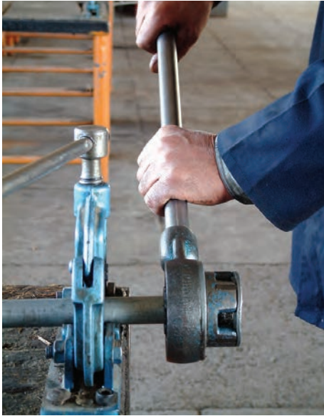
شکل ۴-۴۸- عمل حدیده کاری
