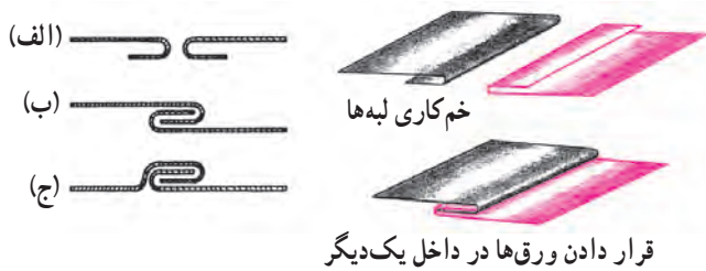
شکل ۴-۲- مراحل مختلف اتصال پیچک
