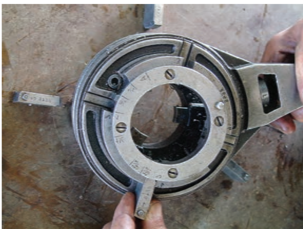
شکل ۴-۵۹- خارج کردن پارچه‌ها از حدیده
