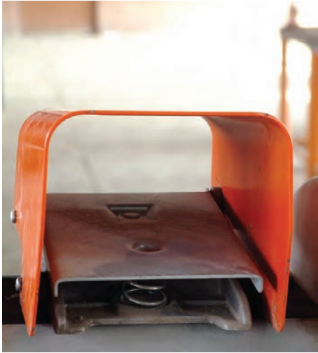
شکل ۸۱-۴- پدال خاموش و روشن کردن دستگاه در بعضی از حدیده‌های ماشینی
