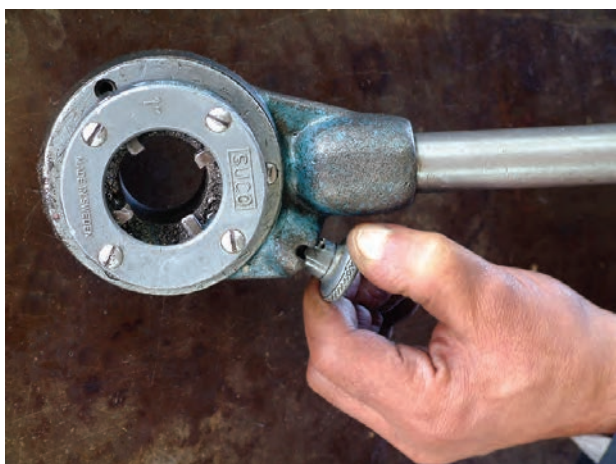
شکل ۴-۴۳- خارج کردن ضامن از شیار
