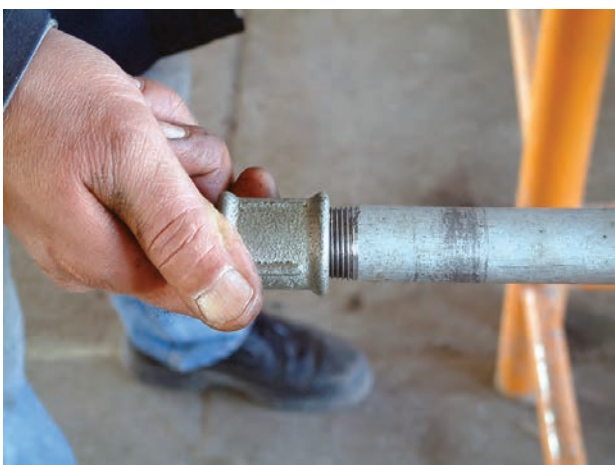
شکل ۴-۴۱- کنترل بار سردنده به وسیله‌ی یک فیتینگ
