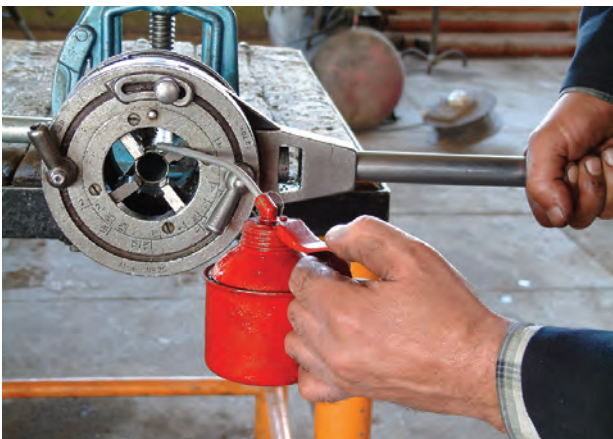
شکل ۴-۶۸- عمل روغن کاری در حین حدیده کاری
