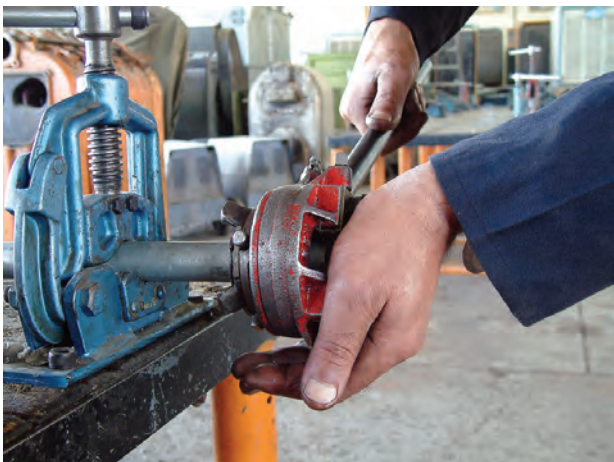
شکل ۴-۳۳- درگیر نمودن پارچه‌های حدیده با لوله
