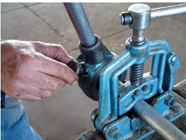
شکل ۴-۴۶- قرار دادن ضامن در جهت حدیده کردن
