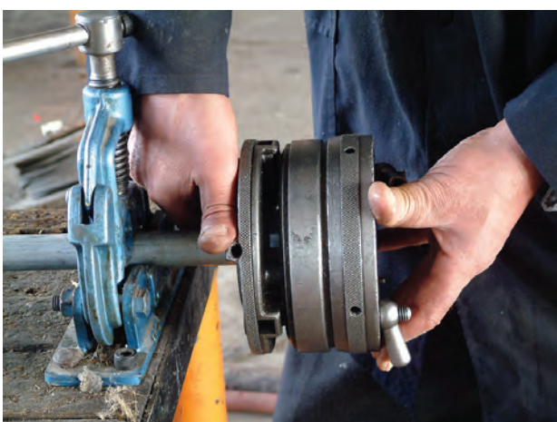
شکل ۴-۶۴- سفت کردن سه نظام حدیده
