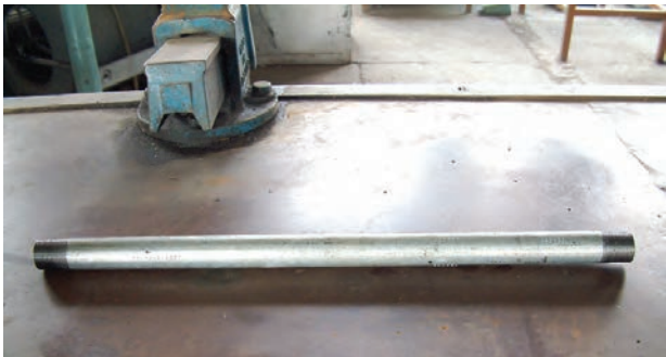
شکل ۴-۶- لوله‌ی دو سر دنده شده
