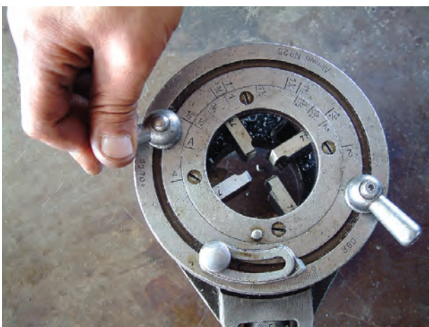
شکل ۴-۶۲- سفت کردن مهره‌های ثابت‌کننده‌ی رینگ متحرک
