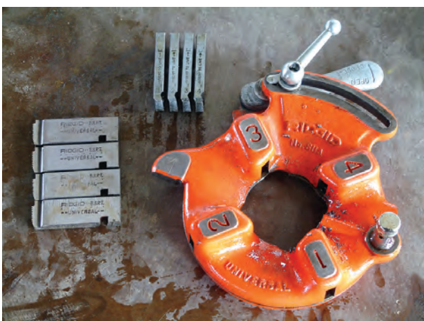
شکل ۸۹-۴- مشخصات حک شده بر روی پارچه‌های حدیده
