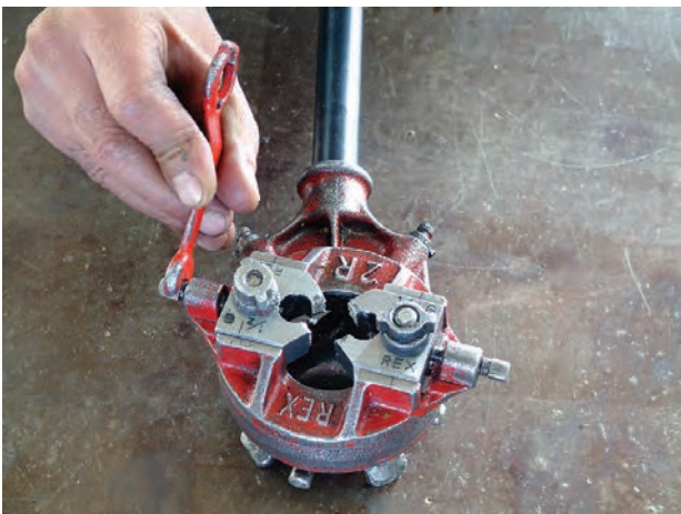
شکل ۴-۲۹- تنظیم کردن حدیده به وسیله‌ی آچار حدیده
