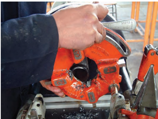
شکل ۴-۹۰- جدا کردن تنه‌ی حدیده از دستگاه
