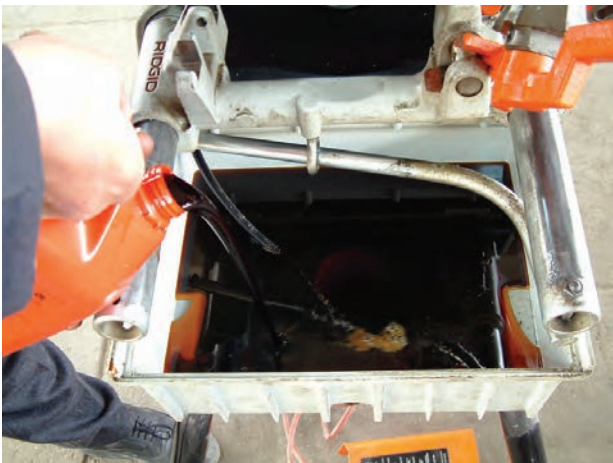
شکل ۸۳-۴- مخزن روغن حدیده‌ی ماشینی
