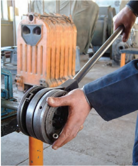
شکل ۴-۶۶- درگیر کردن حدیده با سر لوله
