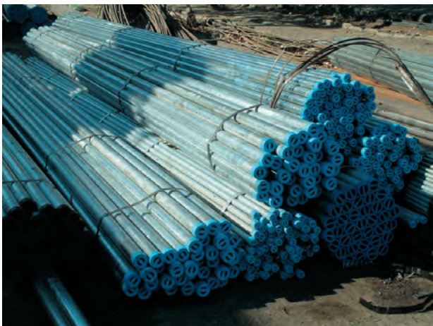
شکل ۴-۱۴ لوله‌ی فولادی گالوانیزه
