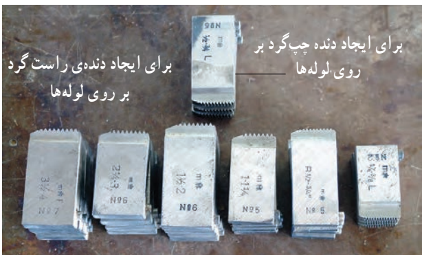
الف - چند دست پارچه‌ی حديد، حديد‌هاي چهارپارچه
