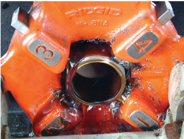
شکل ۸۲-۴- استفاده از روغن در موقع حدیده‌کاری
