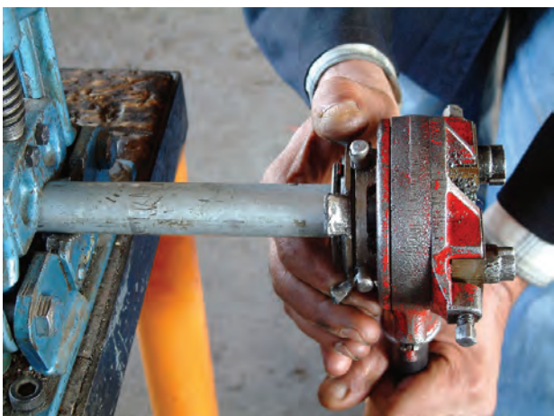
شکل ۴-۳۹- باز کردن فلکهای چهارنظام
