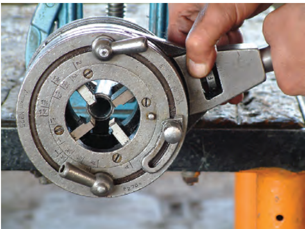
شکل ۴-۵۶- قرار دادن ضامن در حالت F
