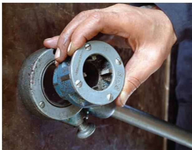
شکل ۴-۴۴- خارج کردن پارچه از بدنه‌ی حدیده
