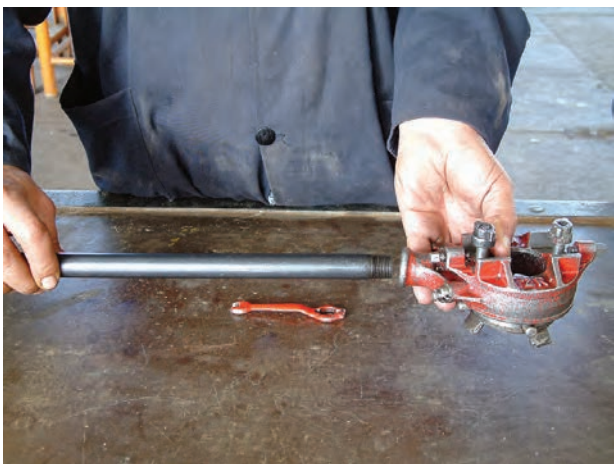
شکل ۴-۲۵- اتصال دسته‌ی حدیده به بدنه‌ی حدیده
