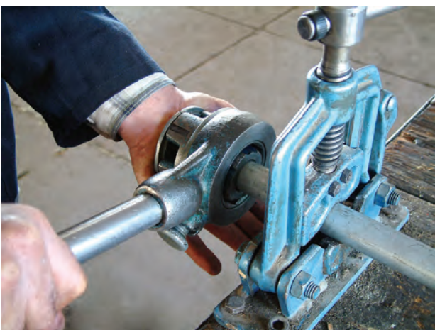
شکل ۴-۴۷- شروع دنده کردن لوله
