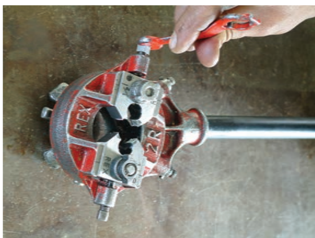
شکل ۲۰-۴- اجزای حیدیهی دستی دو پارچه
