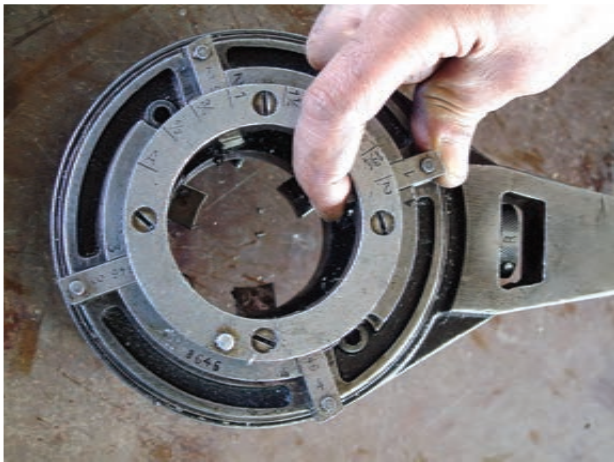
شکل ۴-۶۰- قرار دادن پارچه‌های مناسب در حدیده
