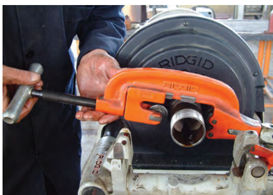
شکل ۴-۱۰۱- بریدن لوله به وسیله‌ی لوله‌بُر
