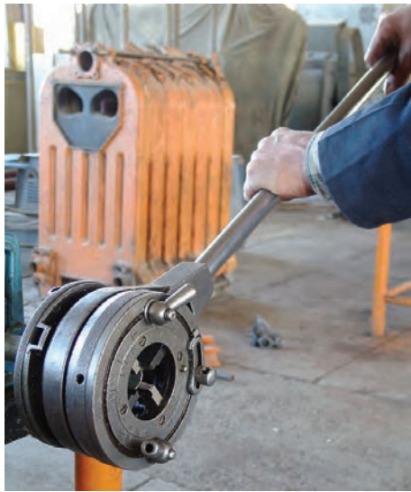
شکل ۴-۶۷- دنده کردن لوله
