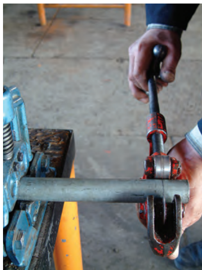
شکل ۴-۷۷- لوله‌بر در حال گردش به دور لوله
