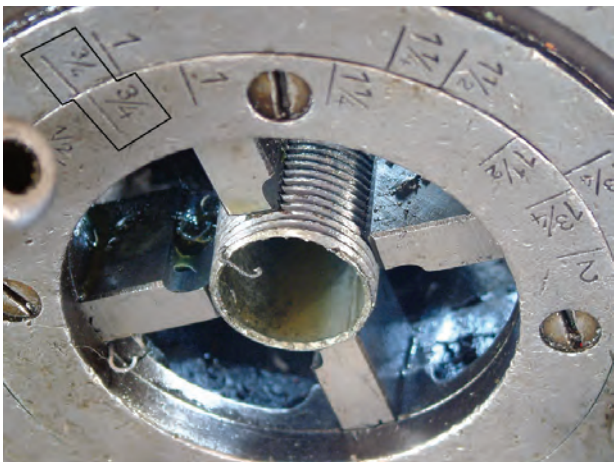
شکل ۴-۶۹- حد صحیح حدیدیه کردن لوله \frac{3}{4} "
