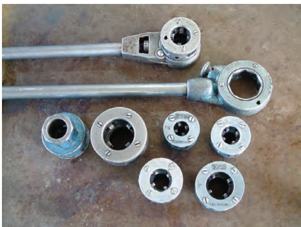
شکل ۴-۴۲- حدیده‌ی چهارپارچه‌ی غیر قابل تنظیم
