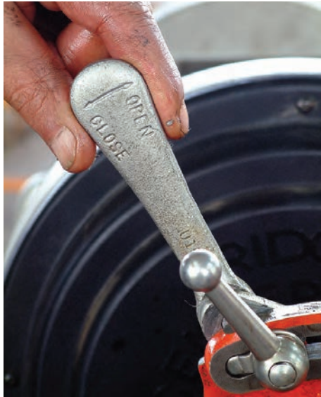
شکل ۴-۹۷- کشیدن ضامن تنظیم به عقب
