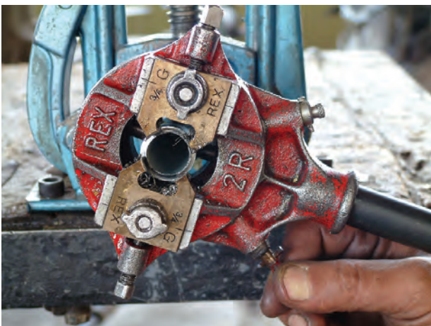
شکل ۳۲-۴- قرار دادن نوک تیز ضامن‌ها به سمت پایین
