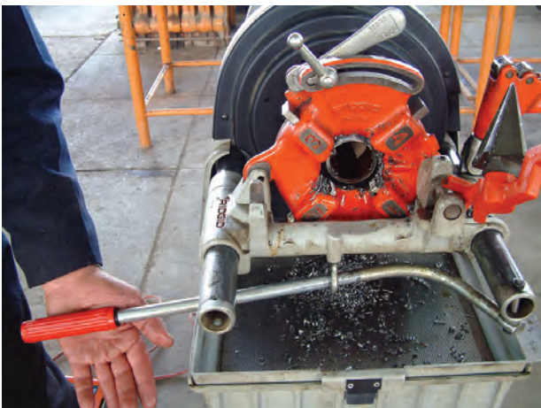
شکل ۴-۹۸- کشیدن اهرم به عقب پس از حدیده‌کاری
