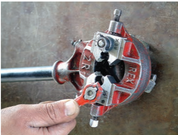
شکل ۴-۲۸- سفت کردن مهره به وسیله‌ی آچار حدیده
