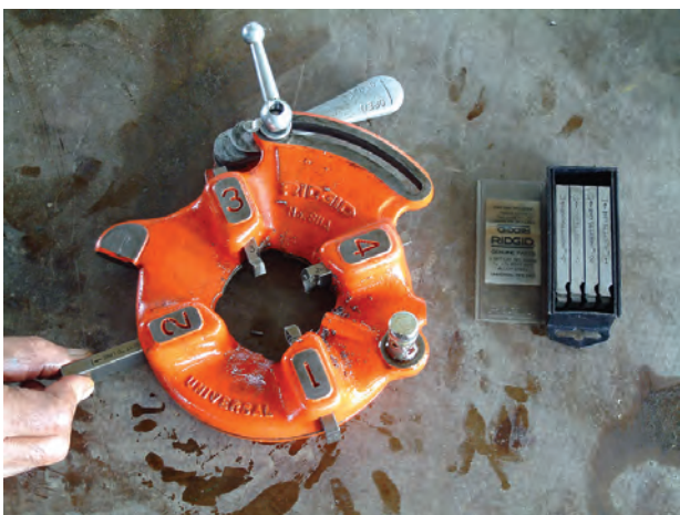
شکل ۴-۹۲- جا زدن پارچه‌ها در شیارهای تنه‌ی حدیده
