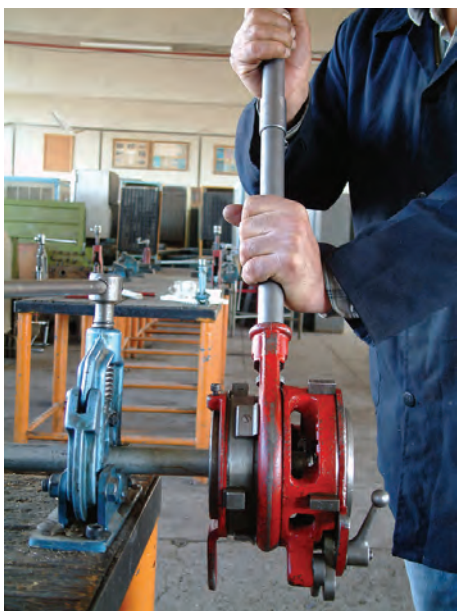
شکل ۱۲۶-۴- باز کردن حدیده از لوله
