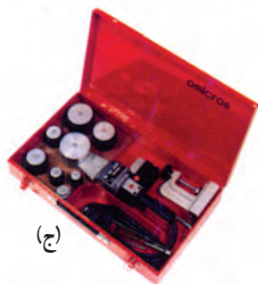
شکل ۲۶-۵- دستگاه جوش لوله‌های پلی پروپیلنی و قالب‌های مربوطه
