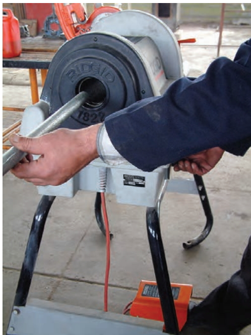
شکل ۱۳۱-۴- قراردادن لوله در حدیده‌ی ماشینی
