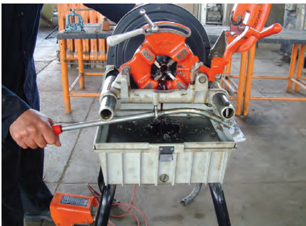
شکل ۱۳۳-۴ عمل حدیده کاری لوله
