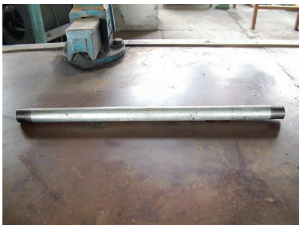
شکل ۱۴۱-۴- لوله‌ی دو سر دنده شده
