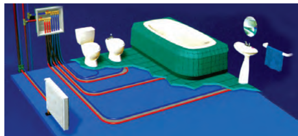
شکل ۱۹-۵- اجرای لوله‌کشی وسایل بهداشتی با استفاده از لوله‌های PE-X
