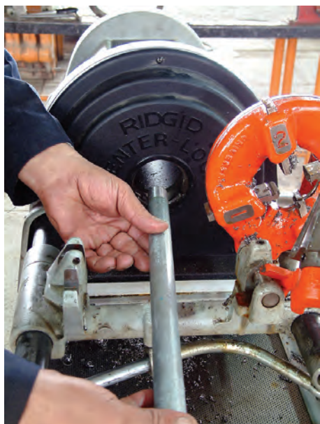
شکل ۱۳۹-۴- سر و ته کردن لوله در داخل سه نظام‌ها
