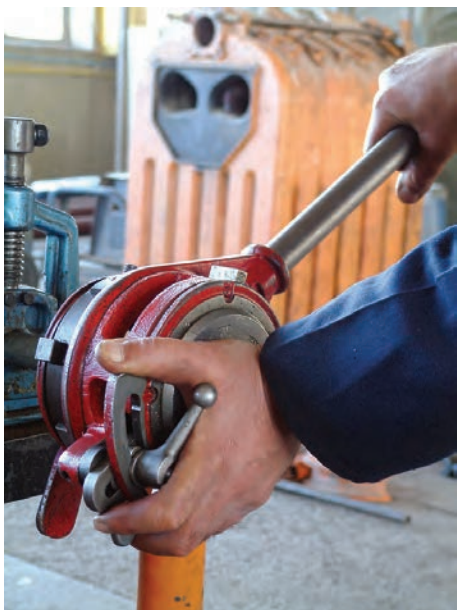
شکل ۴-۱۲۲- عمل درگیر کردن پارچه‌ها با سر لوله
