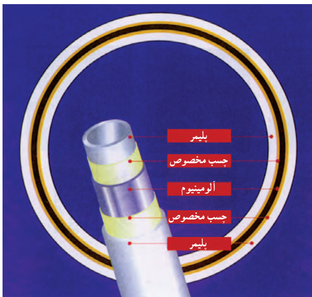
شکل ۲۰-۵- ساختار لوله‌ی پلی اتیلن پنج لایه
