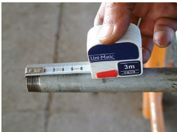
شکل ۱۲۸-۴- اندازه‌گیری لوله‌ی حدیده شده
