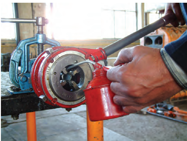
شکل ۴-۱۱۵- استفاده از روغن‌دان در جریان حدیده کاری
