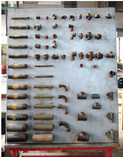
شکل ۳۵-۵- انواع لوله و فیتینگ‌های دنده‌ای
