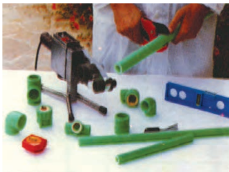
شکل ۲۷-۵- بریدن لوله به وسیله‌ی قیچی مخصوص
