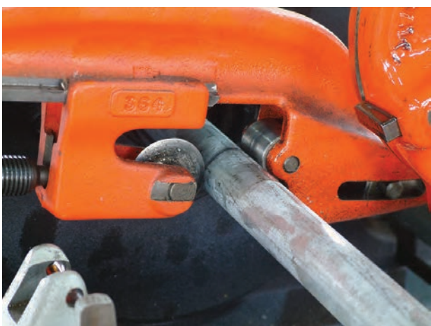
شکل ۴-۱۳۷- بریدن لوله به وسیله ی لوله بُر
