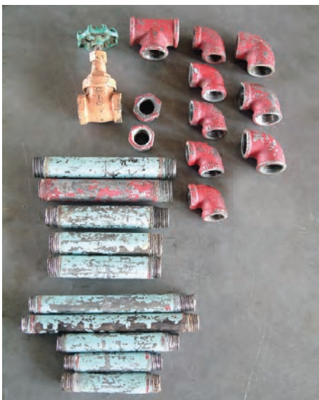
شکل ۵-۱۳۱- حدیده کردن همه‌ی لوله‌ها و آماده کردن شیرفلکه و فیتینگ‌ها
