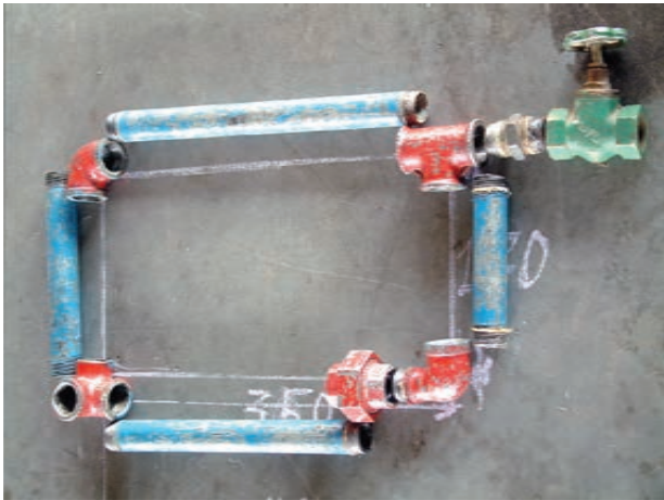
شکل ۱۱۴-۵- قرار دادن لوله‌های جدید شده در محل خود و کنترل نمودن صحت انجام کار
