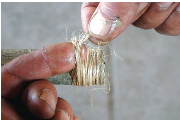
شکل ۵-۵۵- گره زدن انتهای پیچیدن کنف
