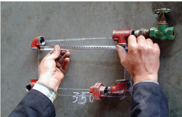
شکل ۵-۱۱۲- اندازه‌گیری طول لوله
