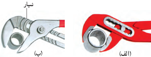
شکل ۷۰-۵- سوراخ‌ها و شیارهای متعدد آچارهای کلاغی
