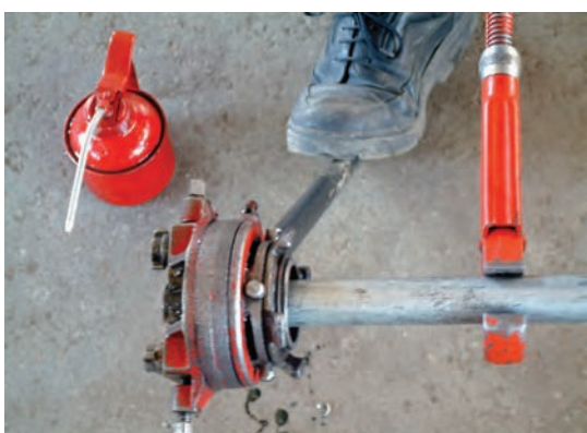
شکل ۱۲۳-۵- عمل باز کردن سردنده از پارچه‌های حدیده
