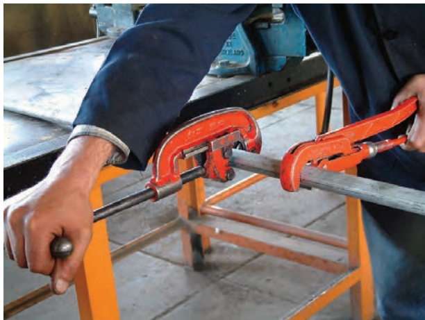
شکل ۱۱۶-۵- ادامه‌ی برش‌کاری لوله
