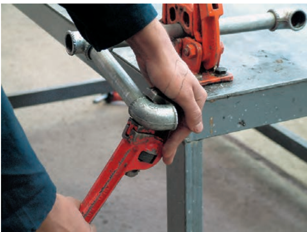
شکل ۱۰۵-۵- روش غلط سفت کردن مدار
