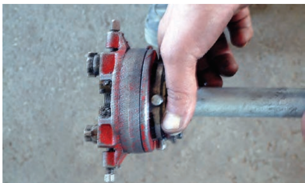
شکل ۱۲۴-۵- باز کردن فلکهای چهار نظام حدیده
