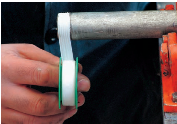
شکل ۵-۵۸- نحوه‌ی پیچیدن نوار تفلون بر روی سردنده
