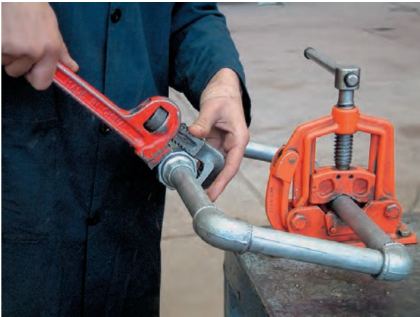
شکل ۵-۱۰۶- نحوه‌ی غلط سفت کردن مهره ماسوره
