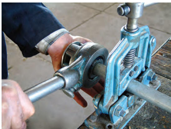
شکل ۵-۱۵۱- حدیده کردن لوله‌ها
