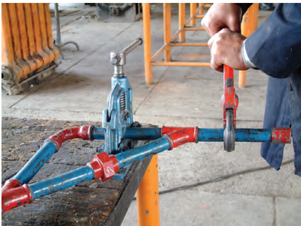
شکل ۱۴۵-۵- تکمیل نمودن مدار
