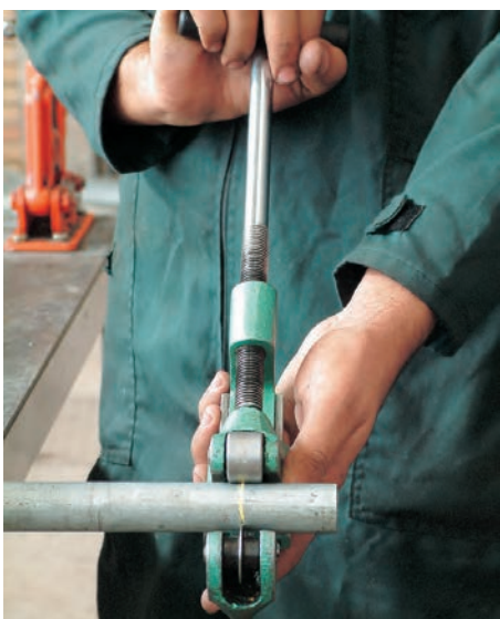
شکل ۱۳۵-۵- بریدن لوله‌های مورد نیاز
