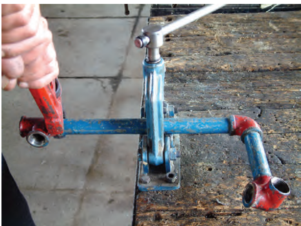
شکل ۵-۱۵۵- بستن سه‌راهی به ضلع دوم مدار
