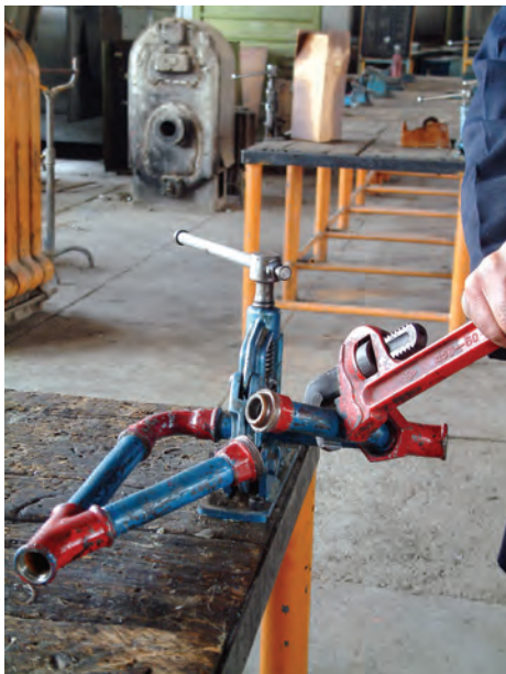
شکل ۵-۱۴۱- بستن یکی از قطعات به سهراهی
