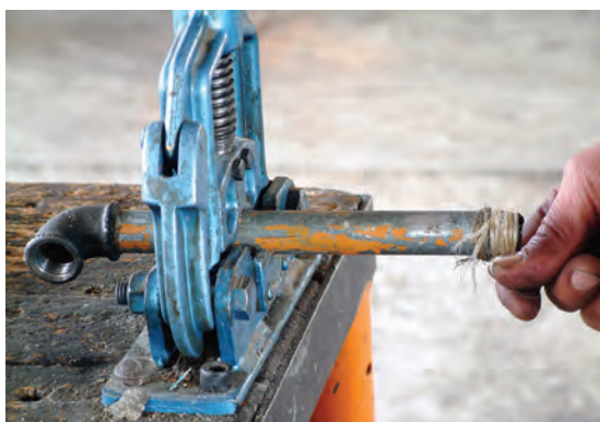
شکل ۵-۱۵۳- خمیر و کنف کردن سردنده‌ی بعدی
