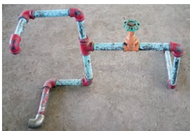
شکل ۱۳۳-۵- تکمیل شدن مدار مطابق نقشه‌ی کار
