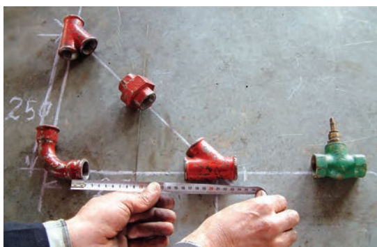
شکل ۱۳۴-۵- اندازه‌گیری لوله‌های مورد نیاز
