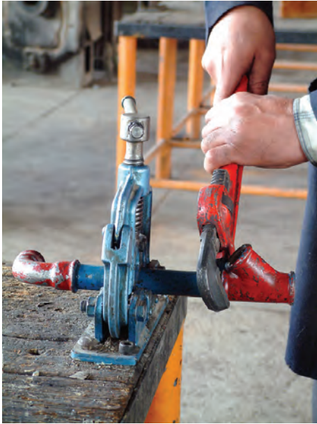
شکل ۵-۱۳۹- بستن فیتینگ‌ها به لوله‌های حدیده شده
