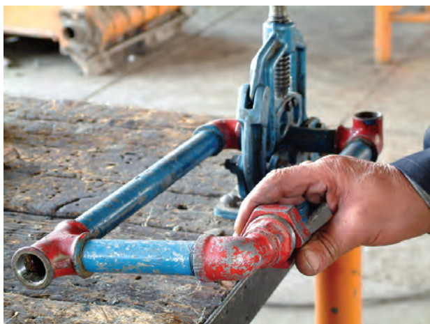
شکل ۱۶۰-۵- بستن مهره ماسوره به وسیله ی دست
