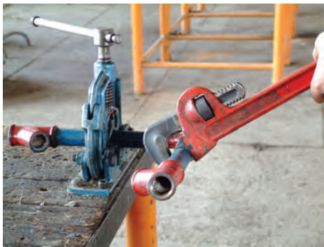
شکل ۵-۱۴۰- بستن ضلع دوم مدار مثلث شکل
