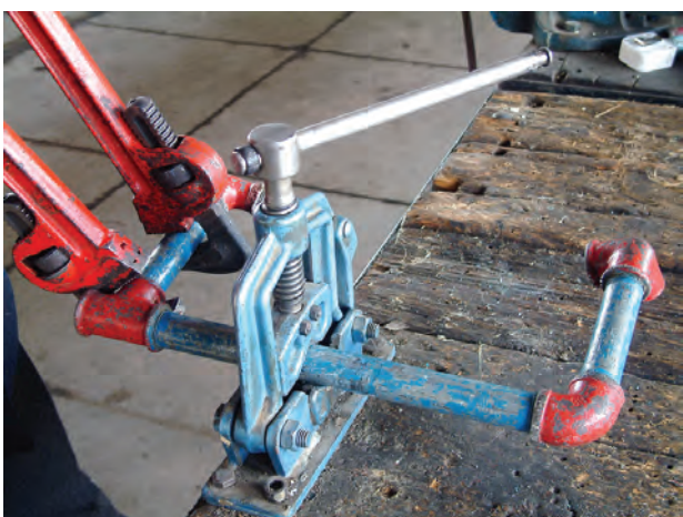
شکل ۵-۱۵۶- بستن ضلع سوم مدار به سه‌راهی
