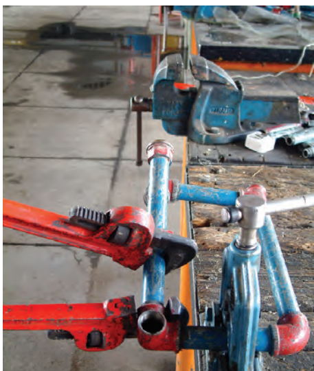
شکل ۱۵۸-۵- بستن قسمت بعدی مهره ماسوره به سهرای کنج
