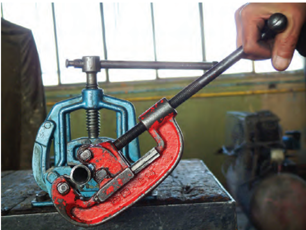
شکل ۱۵۰-۵- بریدن لوله ها
