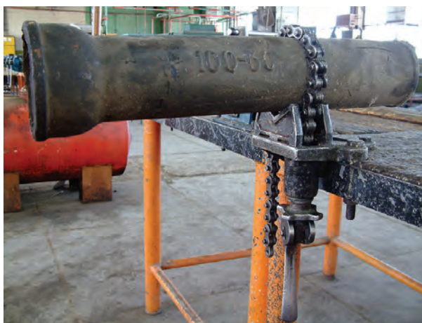
شکل ۱-۳۴- بستن لوله به گیره‌ی زنجیری
