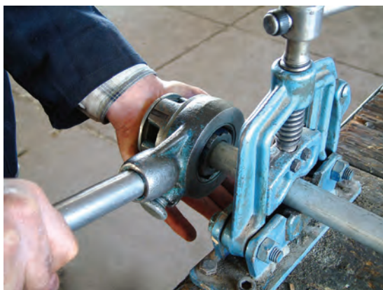
شکل ۵-۱۵۱- حدیده کردن لوله‌ها
