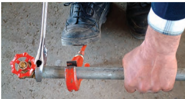
شکل ۱۲۷-۵ نحوه باز کردن شیر فلکه از لوله به وسیله یک آچار
