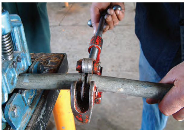
شکل ۳-۵۲- بریدن لوله‌ی محاسبه شده
