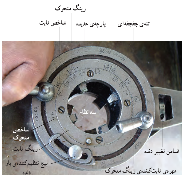
شکل ۴-۵۵- اجزای حدیده‌ی دستی چهارپارچه
