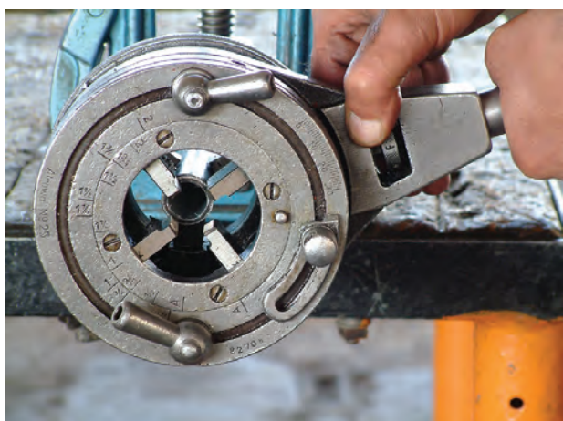
شکل ۴-۵۶- قرار دادن ضامن در حالت F
