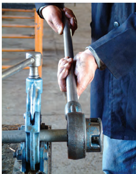
شکل ۵۰- باز کردن حدیده از لوله
