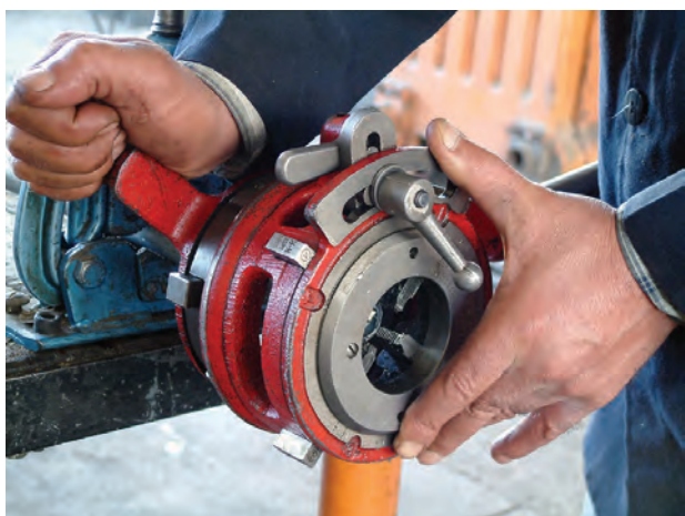
شکل ۴-۱۱۴- سفت کردن فلکه‌ی چهار نظام
