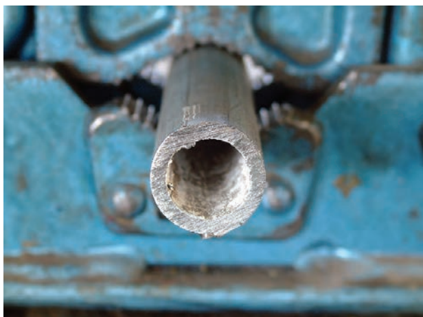
شکل ۱-۵۲ - لوله‌ی بسته شده به گیره‌ی لوله
