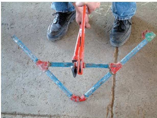
شکل ۱۲۸-۵ نحوه باز و بسته کردن مهره ماسوره با استفاده از دو عدد آچار
