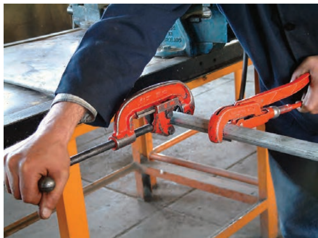
شکل ۱۱۶-۵- ادامه‌ی برش‌کاری لوله
