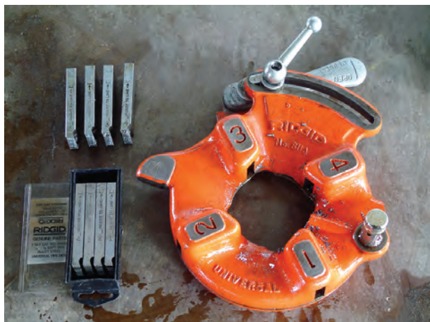
شکل ۸۸-۴- تنه‌ی حدیده و پارچه‌های آن
