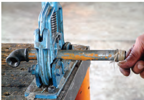
شکل ۵-۱۵۳- خمیر و کنف کردن سردنده‌ی بعدی
