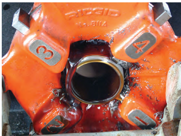
شکل ۴-۸۲- استفاده از روغن در موقع حدیده‌کاری
