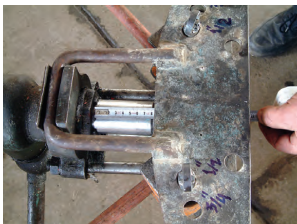
شکل ۲۷-۳- اندازه‌گیری طول پیستون خارج شده از سیلندر
