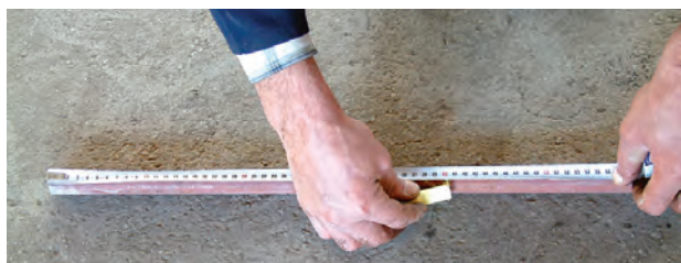
شکل ۳-۵۴- خط‌کشی لوله و تعیین محل‌های خم
