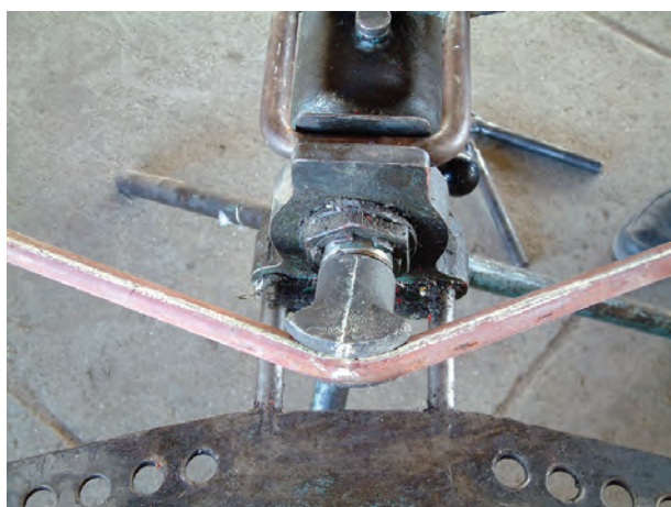
شکل ۳-۲۵- پایان عمل خم‌کاری
