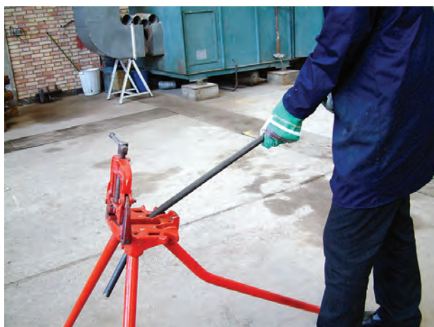
شکل ۳-۹- خم کاری لوله به وسیله‌ی گیره‌ی صحرایی
