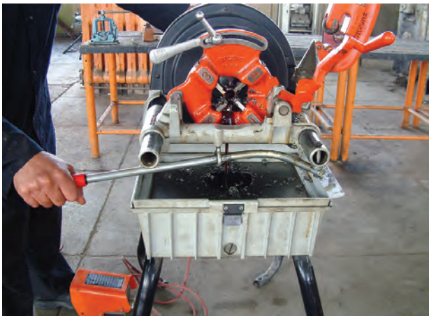
شکل ۱۳۳-۴ عمل حدیده کاری لوله
