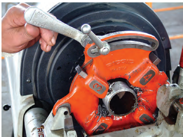
شکل ۴-۷۸- عمل حدیده‌کاری با ماشین
