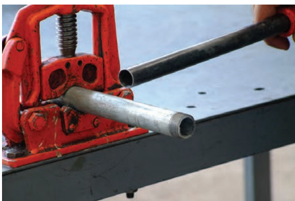
شکل ۴-۱۱۷- جداسازی پلیسه از سر دنده
