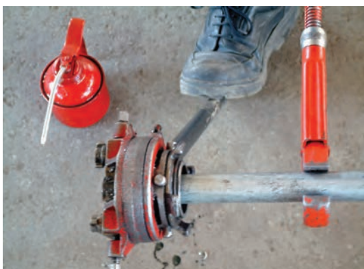
شکل ۵-۱۲۳- عمل باز کردن سردنده از پارچه‌های حدیده
