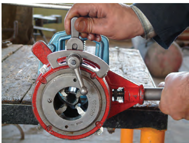
شکل ۱۲۵-۴- کم کردن بار پارچه‌های حدیده
