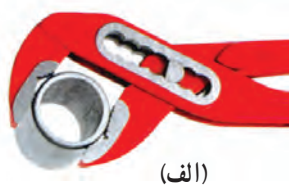
شکل ۵-۷۰- سوراخ‌ها و شیارهای متعدد آچارهای کلاغی
