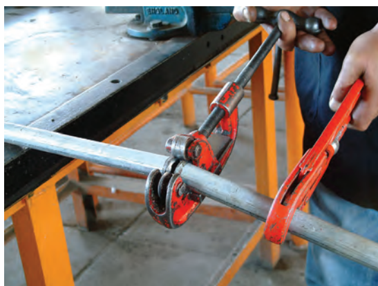
شکل ۵-۱۱۷- بریده شدن لوله و خاتمه‌ی کار
