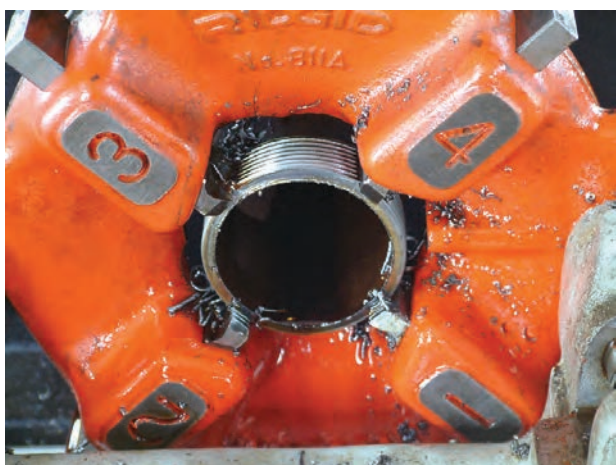
شکل ۴-۸۰- لوله در حال باز شدن از پارچه‌ها
