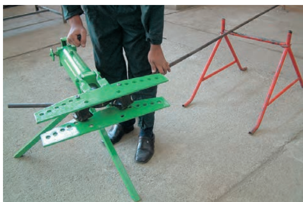
شکل ۳-۴۲- استفاده از خرک در خم کاری
