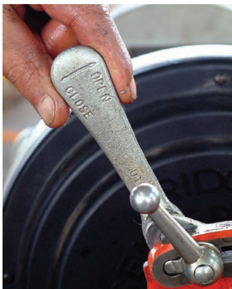
شکل ۴-۹۷ - کشیدن ضامن تنظیم به عقب
