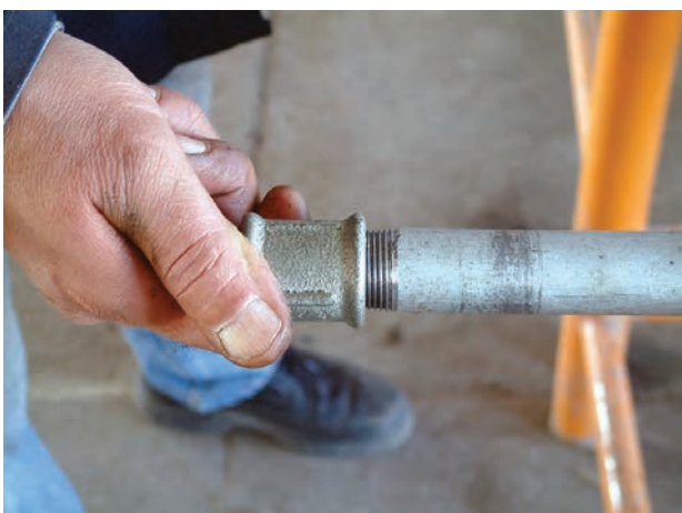
شکل ۴-۴۱- کنترل بار سردنده به وسیله‌ی یک فیتینگ
