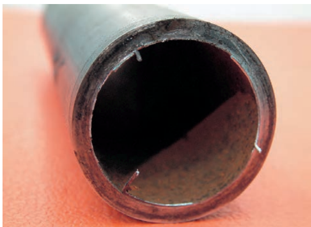
الف - لوله‌ی بریده شده به وسیله‌ی لوله‌بر
