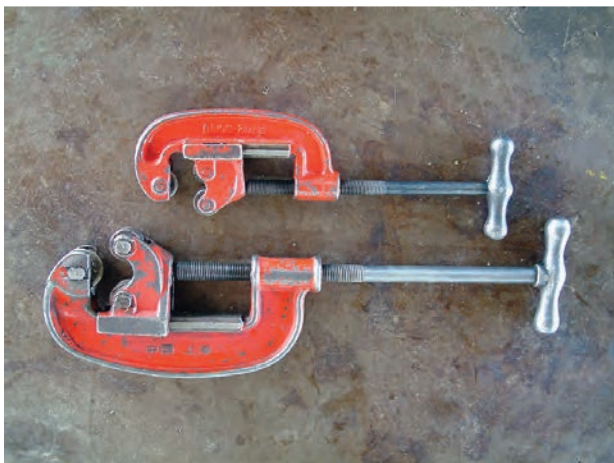
شکل ۱-۶۳- لوله‌بر در دو اندازه‌ی متفاوت
