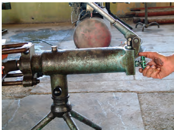
شکل ۳-۲۳- بستن شیر قطع و وصل
