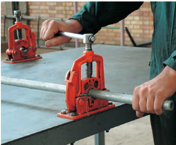
شکل ۱-۲۸- بستن لوله به گیره‌ی لوله
