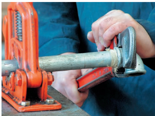
شکل ۵-۹۲- سفت کردن فیتینگ به وسیله‌ی آچار لوله‌گیر
