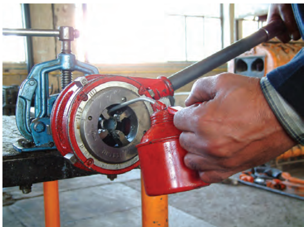
شکل ۱۲۳-۴- استفاده از روغن‌دان در جریان حدیده‌کاری
