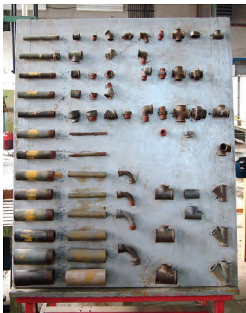
شکل ۳۵-۵- انواع لوله و فیتینگ‌های دنده‌ای
