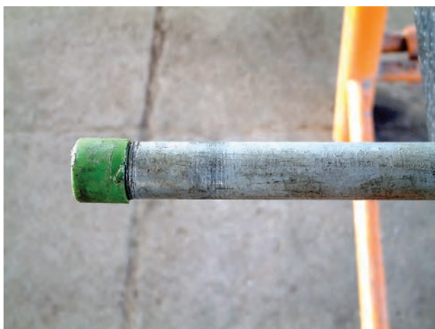
شکل ۴-۱۶ اتصال بوشن پلاستیکی به سردنده‌ی لوله
