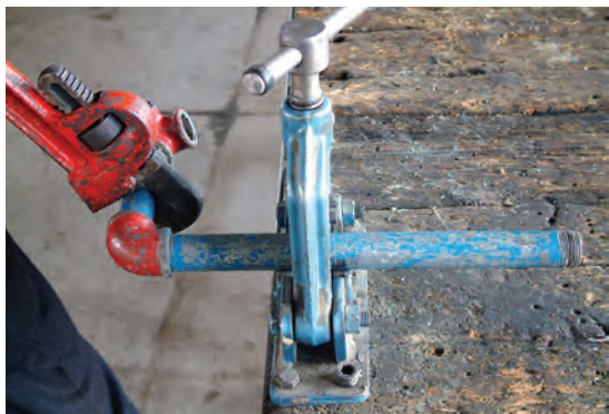
شکل ۵-۱۵۴- بستن لوله‌ی ضلع دوم مدار
