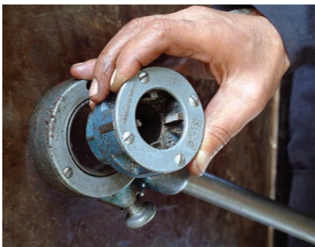
شکل ۴-۴۴- خارج کردن پارچه از بدنه‌ى حديد
