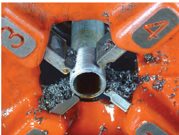
شکل ۴-۱۱۶- طول مناسب دنده
