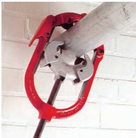
شکل ۱-۲۳- لوله‌بر دستی چهار تیغه
