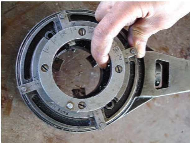
شکل ۴-۶۰- قرار دادن پارچه‌های مناسب در حدیده
