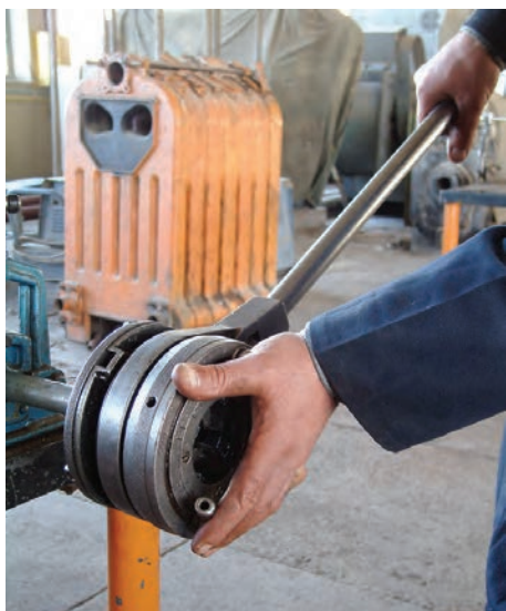
شکل ۴-۶۶- درگیر کردن حدیده با سر لوله
