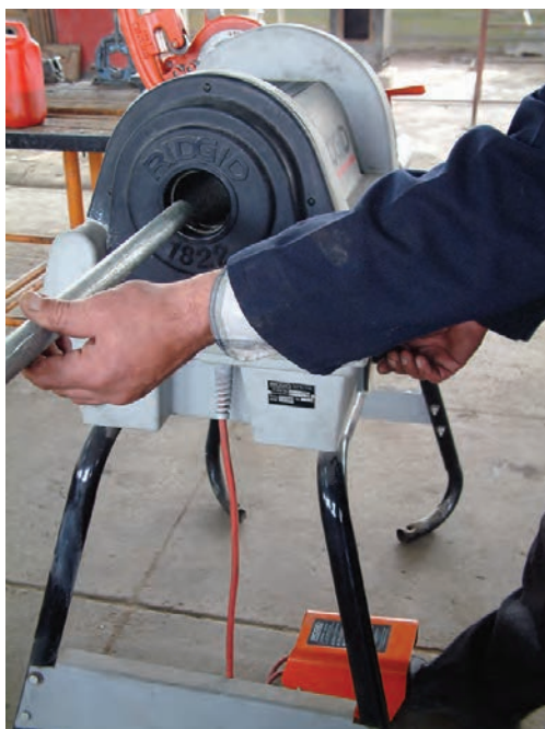
شکل ۱۳۱-۴- قراردادن لوله در حدیده‌ی ماشینی
