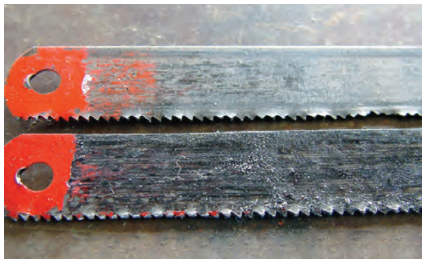
شکل ۱-۴۷- تیغه اره‌های دندان‌های شکسته شده
