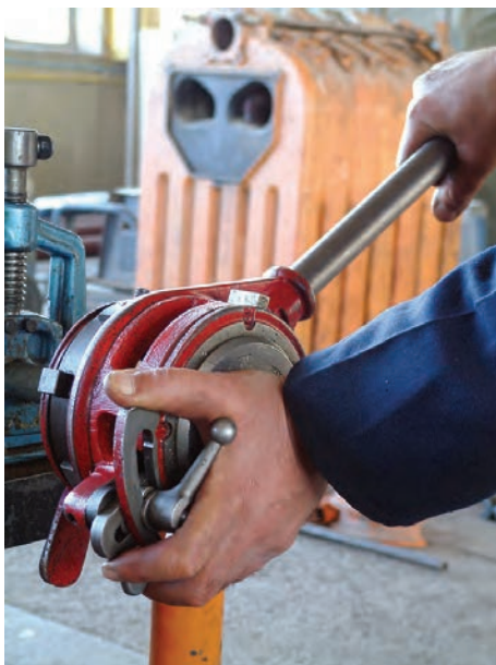
شکل ۴-۱۲۲- عمل درگیر کردن پارچه‌ها با سر لوله
