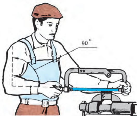
الف - ارّه کاری به وسیله کمان ارّه
