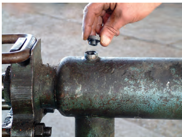
شکل ۳-۱۵ سرپوش مجرای ورودی روغن
