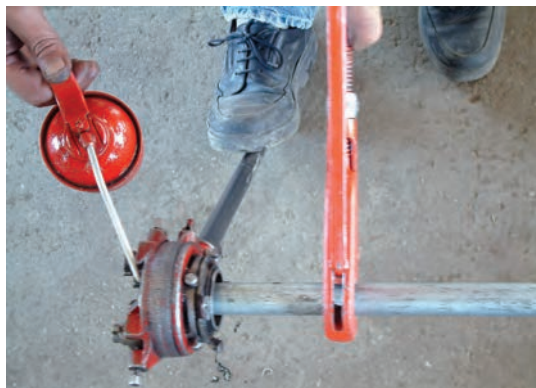
شکل ۵-۱۲۱- استفاده از روغن در جریان حدیده‌کاری
