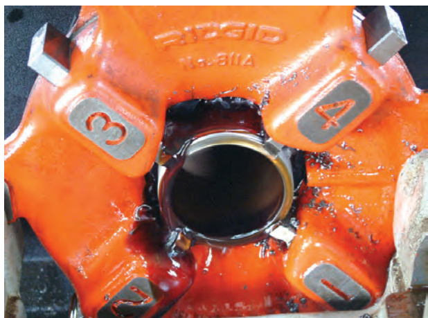
شکل ۴-۹۵- عمل حدیده‌کاری به وسیله حدیده‌ی ماشین
