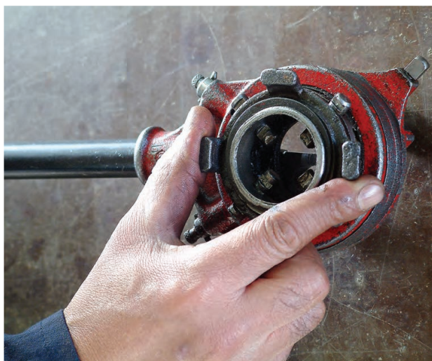
شکل ۴-۲۱- فلکه‌ی چهار نظام حدیده‌ی دستی دو پارچه
