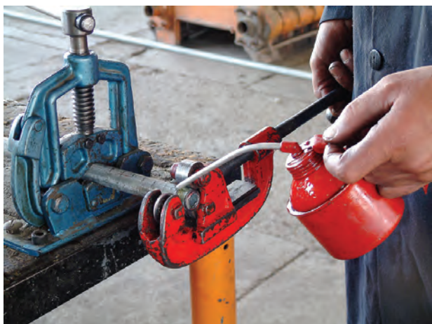
شکل ۱-۵۷ - ریختن روغن در محل تماس
