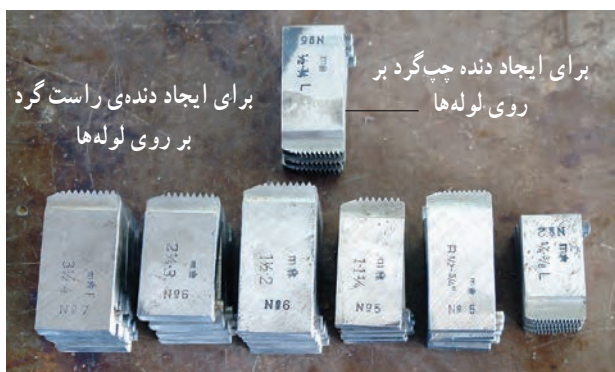
الف - چند دست پارچهي حديد، حديد‌هاي چهارپارچه
