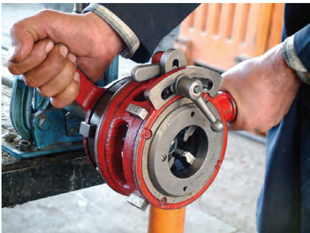
شکل ۴-۱۲۰- بستن اهرم فلک‌های چهار نظام
