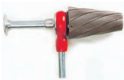
شکل ۲-۴- بُرقوی چند شیاره‌ی ماریج
