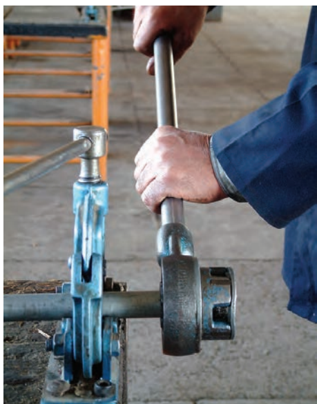
شکل ۴۸- عمل حدیده کاری
