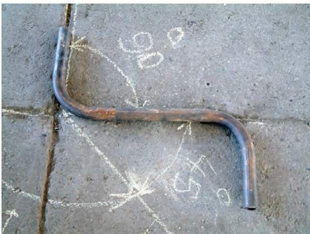
شکل ۵۸-۳- ادامه ی عمل خم کاری
