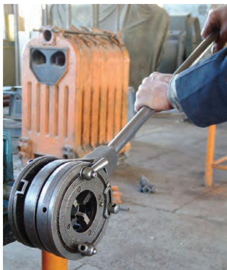
شکل ۴-۶۷- دنده کردن لوله
