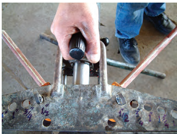
شکل ۱۲-۳- بعد از عمل خم کاری
