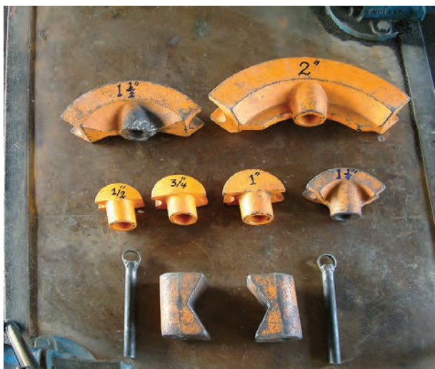
شکل ۳-۲۰ پارچه‌ها و لقمه‌های خم‌کن هیدرولیکی
