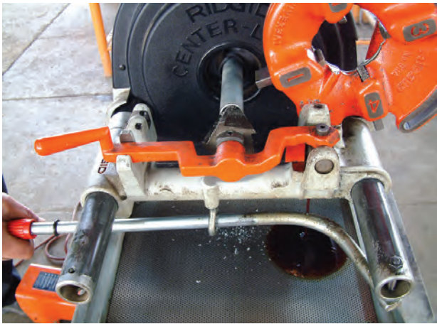
شکل ۱۳۲-۴ عمل بُرقوکاری
