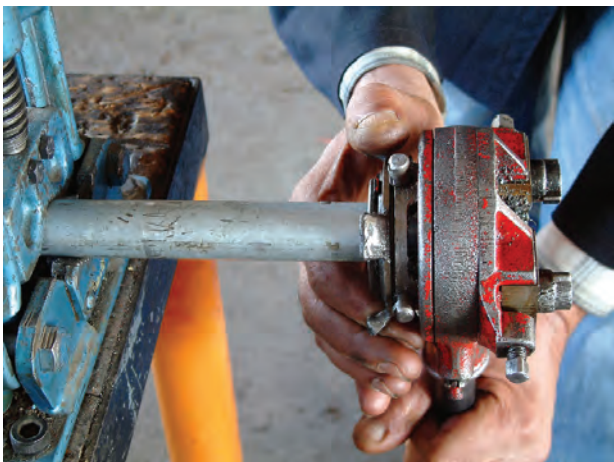
شکل ۴-۳۹- باز کردن فلکهای چهارنظام
