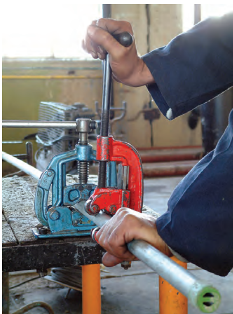
شکل ۱-۵۸- ادامه‌ی عمل بُرش‌کاری
