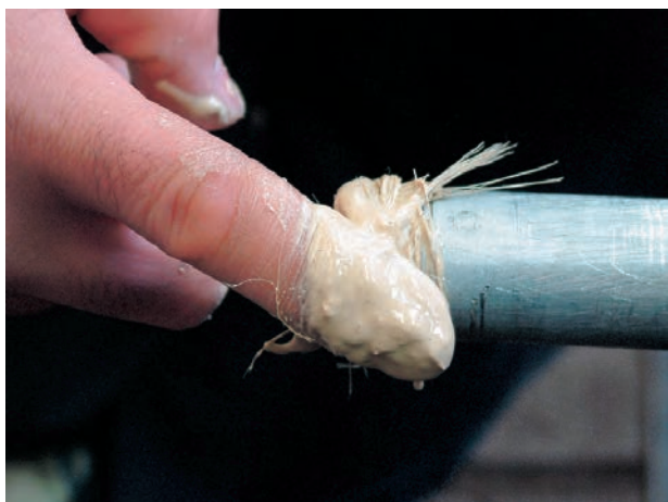
شکل ۵-۹۰- خمیر و کنف کردن سردنده
