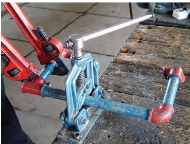
شکل ۵-۱۵۶- بستن ضلع سوم مدار به سه‌راهی
