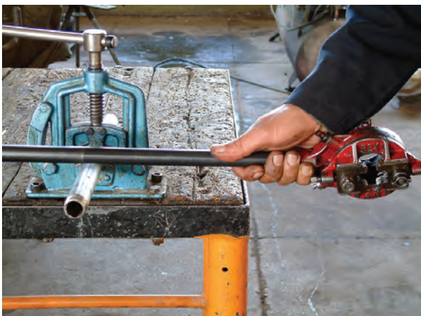
شکل ۴-۴۰- جدا کردن پلیسه‌ها از سردنده
