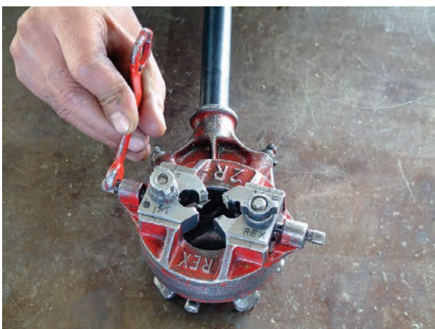
شکل ۴-۲۹- تنظیم کردن حدیده به وسیله‌ی آچار حدیده
