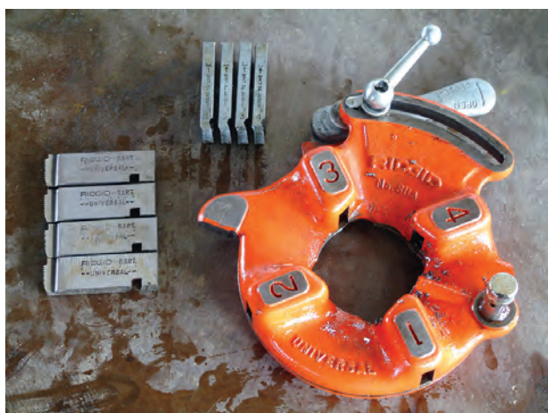
شکل ۸۹-۴- مشخصات حک شده بر روی پارچه‌های حدیده
