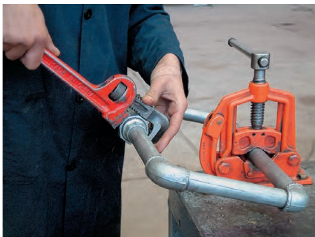
شکل ۵-۱۰۶- نحوه‌ی غلط سفت کردن مهره ماسوره
