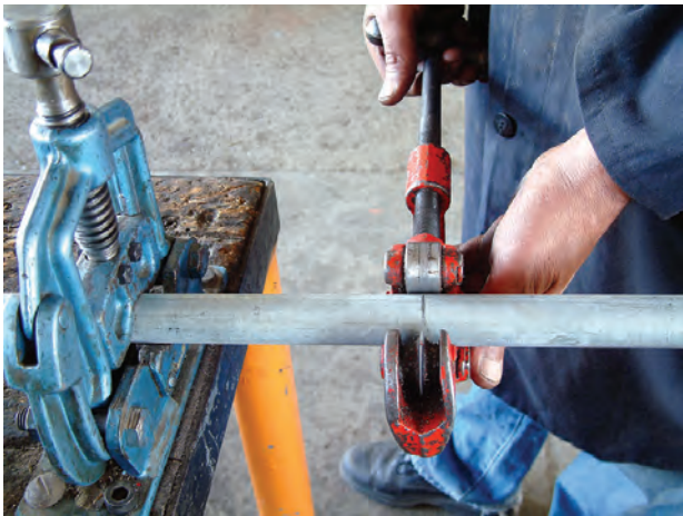
شکل ۱-۶۲- سفت کردن دسته‌ی لوله‌بر به اندازه‌ی لازم
