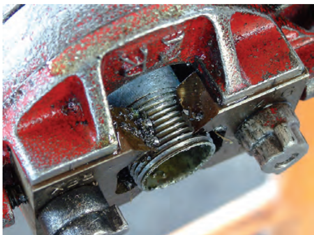
شکل ۴-۳۶- عبور دو دندانه از انتهای پارچه
