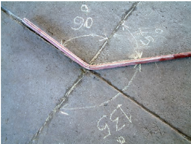
شکل ۲۹-۳- کنترل خم لوله های ۴۵ درجه
