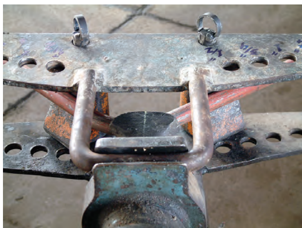
ب- باز کردن خم لوله‌ی خم شده
