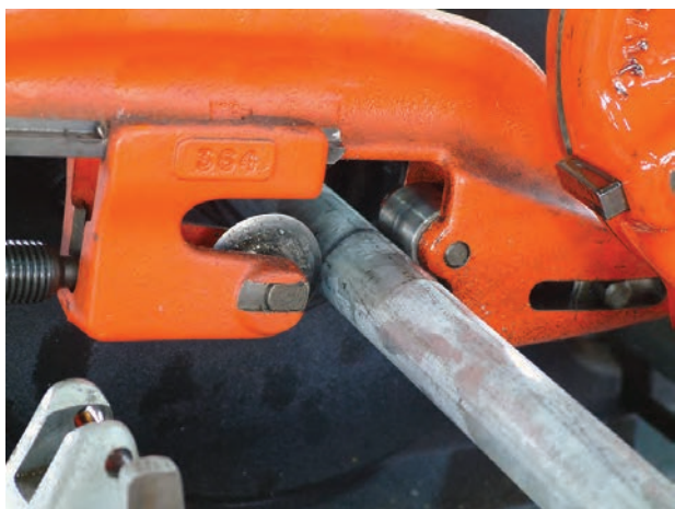
شکل ۴-۱۳۷- بریدن لوله به وسیله ی لوله بُر
