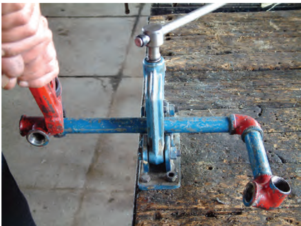
شکل ۵-۱۵۵- بستن سه‌راهی به ضلع دوم مدار
