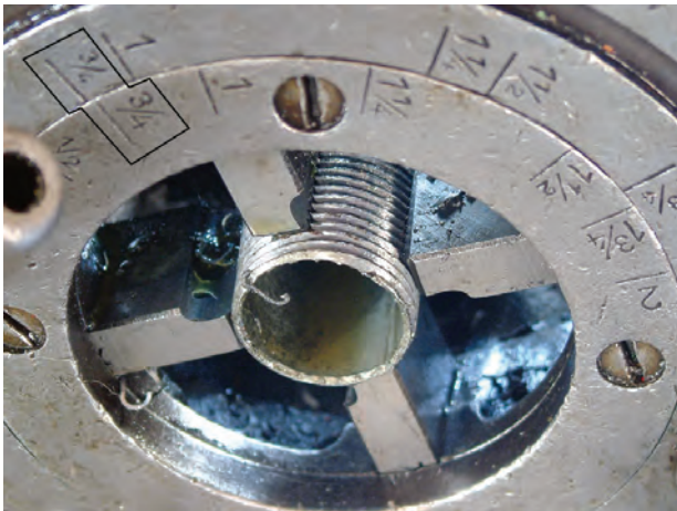
شکل ۴-۶۹- حد صحیح حدیده کردن لوله \frac{3}{4} "
