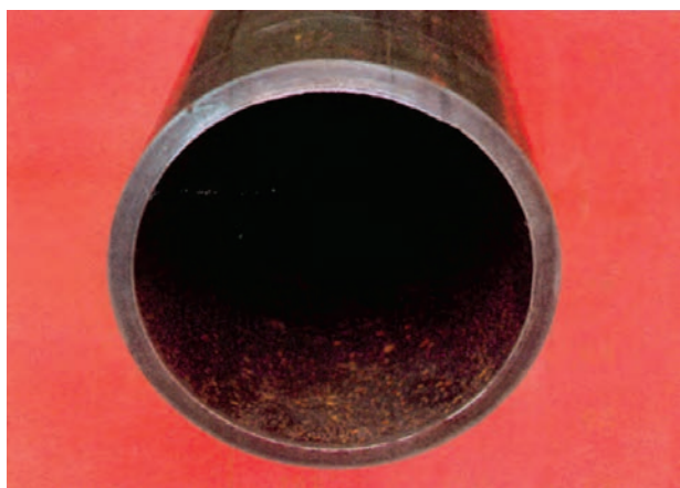
شکل ۴-۱۳- لوله‌ی فولادی بدون درز
