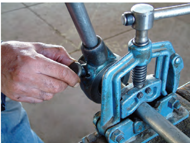
شکل ۴-۴۶- قرار دادن ضامن در جهت حدیده کردن
