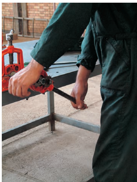
شكل ۴-۱۱۲- حديدكاري متناسب با قطر لوله
