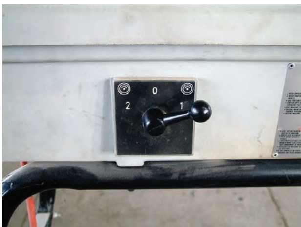
شکل ۴-۷۹- کلید خاموش و روشن کردن حدیده‌ی ماشینی
