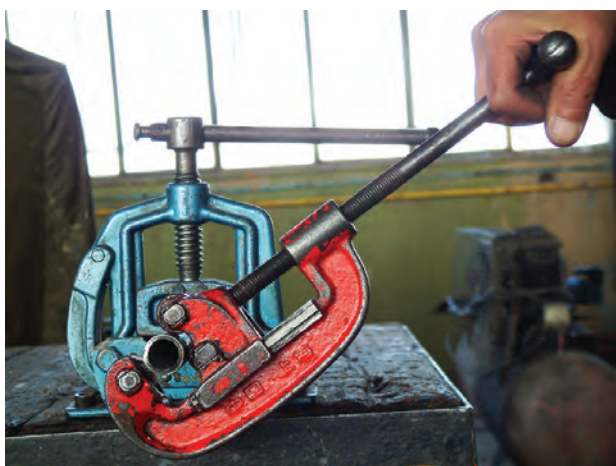
شکل ۱-۵۶ - گرداندن لوله‌بُر به دور لوله
