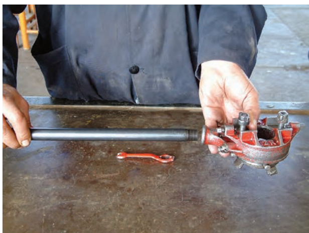
شکل ۴-۲۵ اتصال دسته‌ی حدیده به بدنه‌ی حدیده
