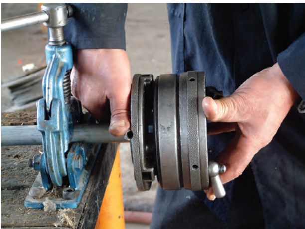
شکل ۴-۷۱- باز کردن سه نظام حدیده
