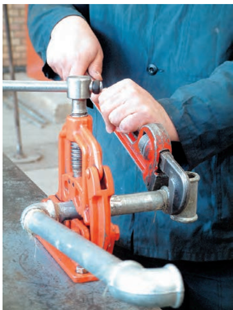
شکل ۵-۱۰۳- نحوه‌ی صحیح سفت کردن فیتینگ به لوله
