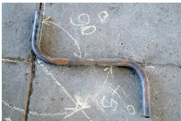
شکل ۳-۴۱- عدم دویدگی لوله‌ی دو خم
