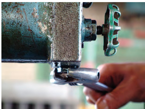
شکل ۳-۱۴ باز کردن درپوش تخلیه ی روغن
