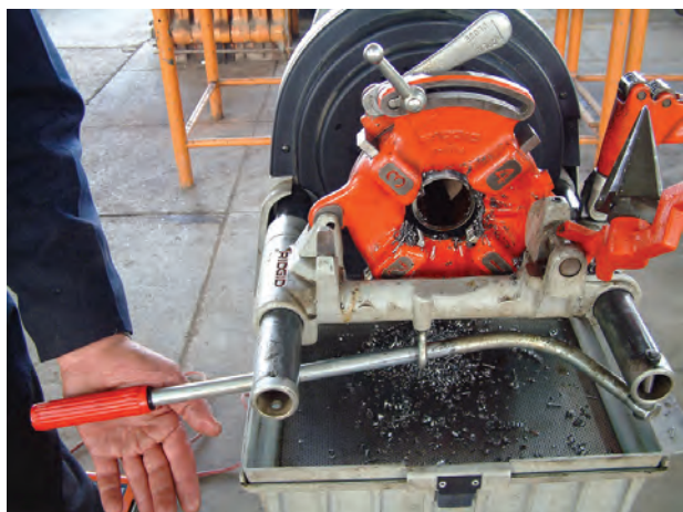
شکل ۴-۹۸ - کشیدن اهرم به عقب پس از حدیده‌کاری
