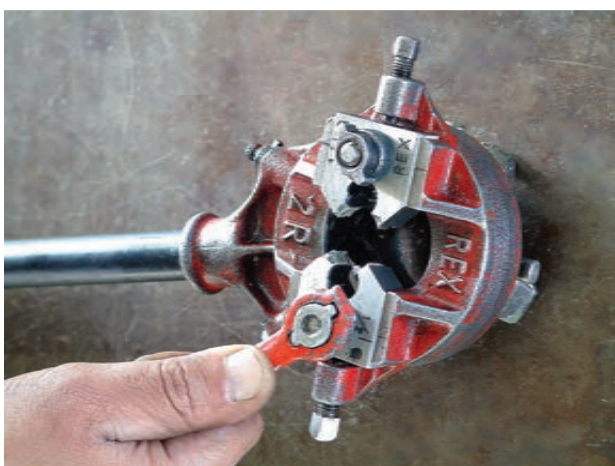
شکل ۴-۲۸- سفت کردن مهره به وسیله‌ی آچار حدیده
