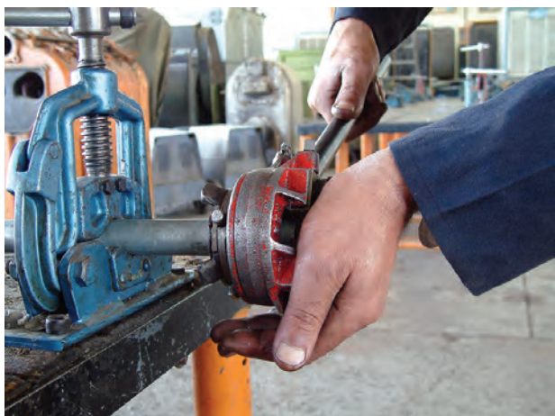
شکل ۴-۳۳- درگیر نمودن پارچه‌های حدیده با لوله
