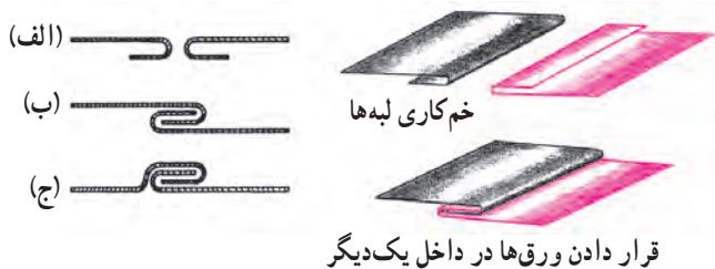
شکل ۴-۲- مراحل مختلف اتصال پیچک
