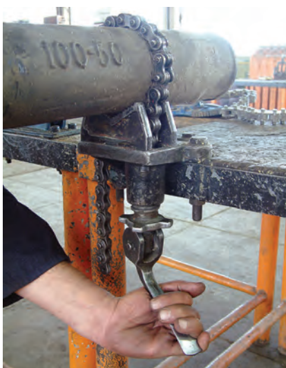
شکل ۱-۳۳- کشیدن اهرم قفل کننده
