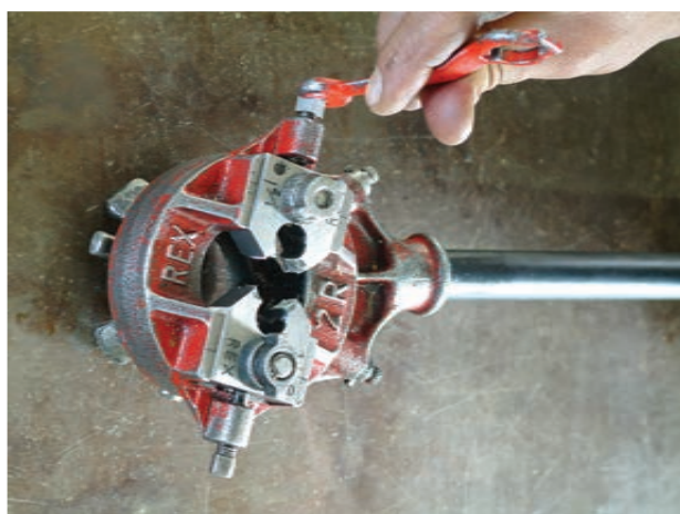
شکل ۲۰-۴- اجزای حیدیه دستی دو پارچه
