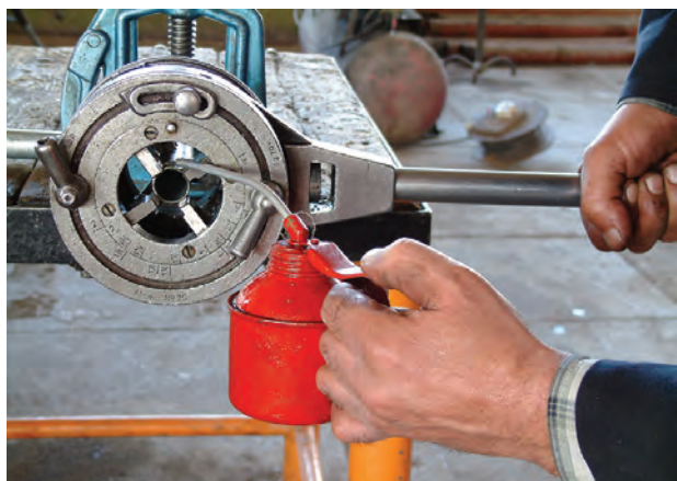
شکل ۴-۶۸- عمل روغن کاری در حین حدیده‌کاری
