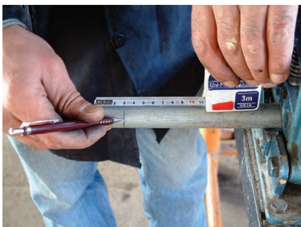
شکل ۱-۵۳ - مشخص کردن محل برش
