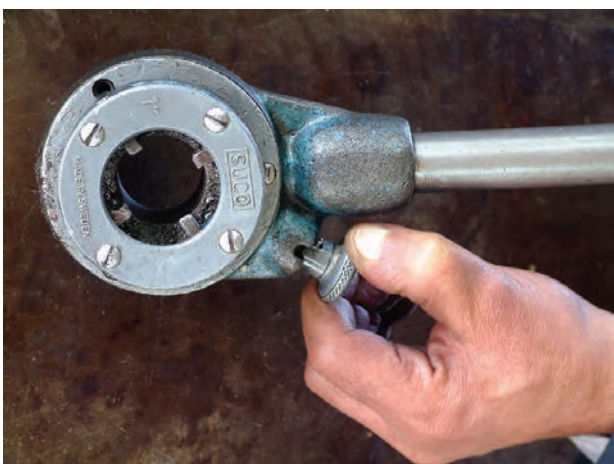
شکل ۴-۴۳- خارج کردن ضامن از شيار
