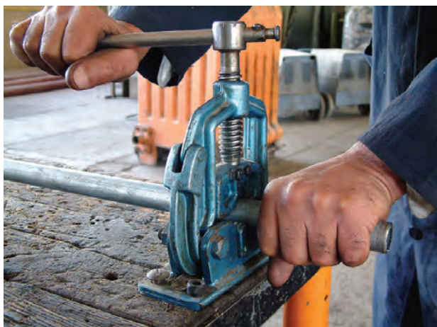
شکل ۱-۳۵ - بستن لوله به گیره برای ارّه کاری
