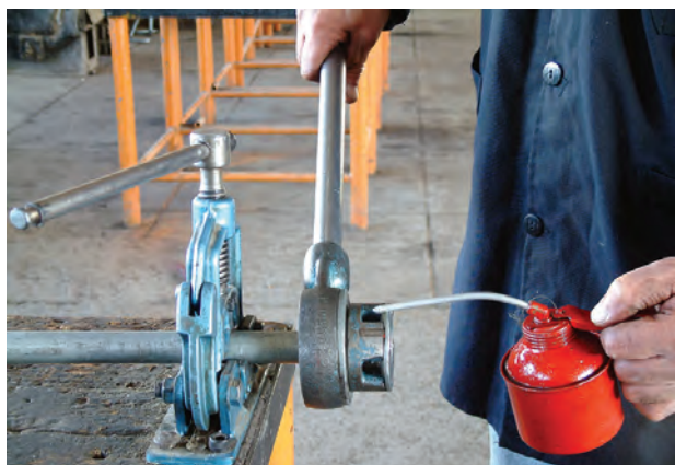
شکل ۴۹- روغن کاری محل تماس پارچه‌ها با لوله
