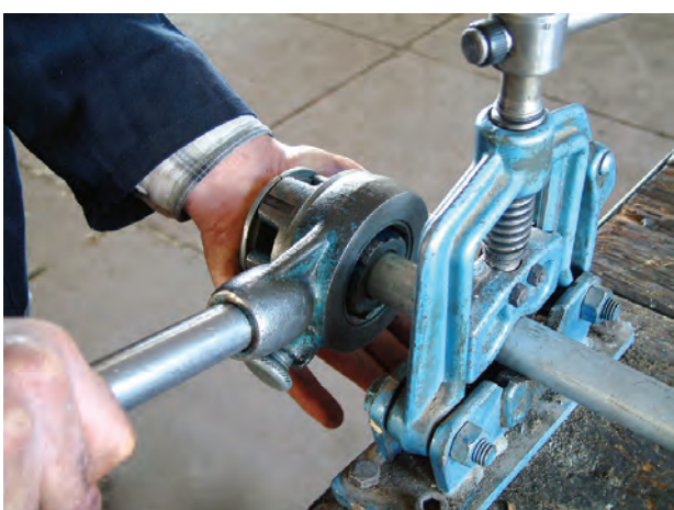
شکل ۴-۴۷- شروع دنده کردن لوله
