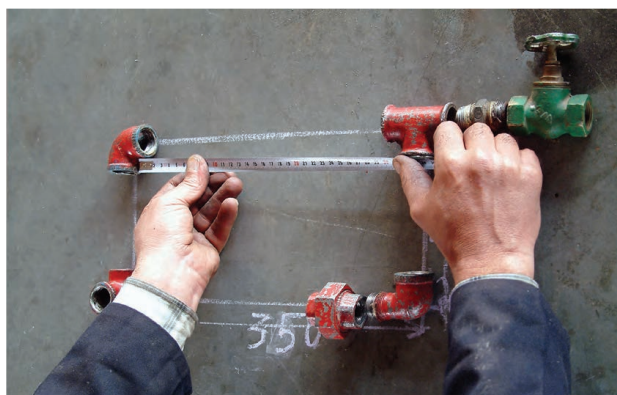
شکل ۵-۱۱۲- اندازه‌گیری طول لوله
