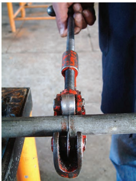
شکل ۱-۵۵ - بریدن لوله
