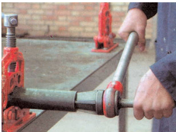
شکل ۱۲-۲- عمل بُرقوکاری
