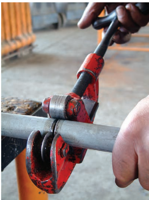
شکل ۴-۱۲۹- بریدن لوله
