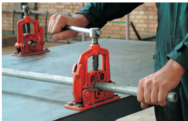
شکل ۳-۵۳- باز کردن شاخه‌ی لوله از گیره‌ی لوله
