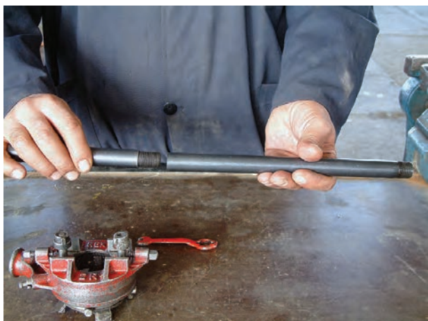
شکل ۴-۲۴ اتصال دسته‌ی دو تکه به یک‌دیگر
