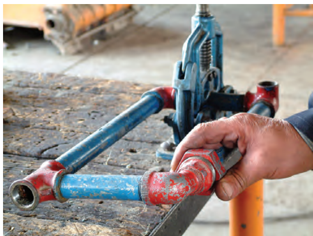
شکل ۱۶۰-۵- بستن مهره ماسوره به وسیله‌ی دست
