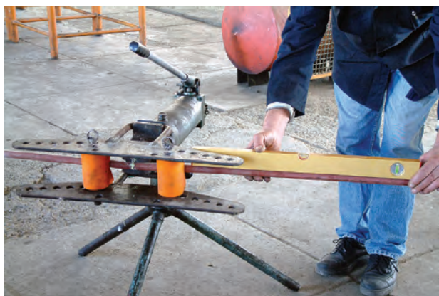
شکل ۳-۴۳- کنترل افقی بودن لوله در خم کاری
