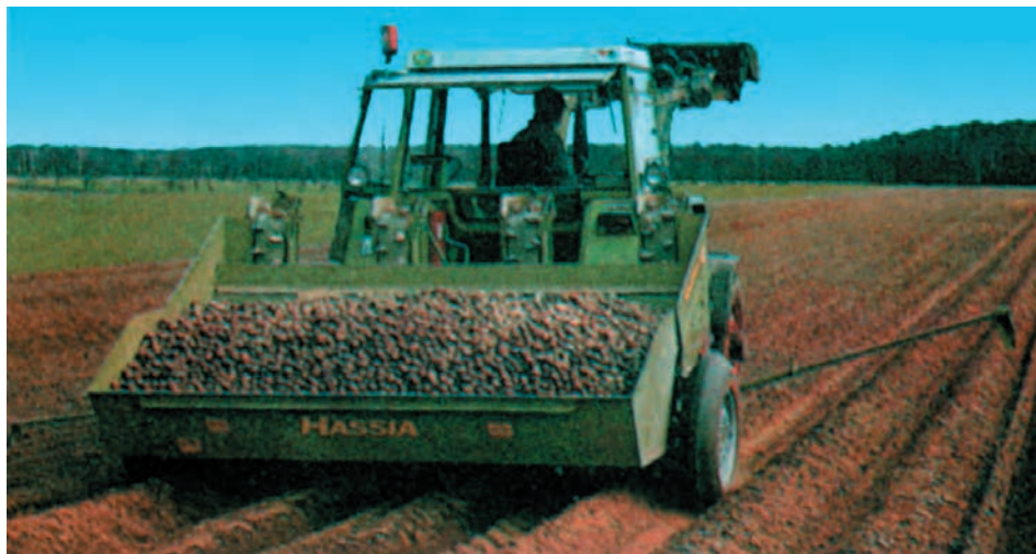
شکل ۲-۷- یک غده کار خودکار در حین کاشت سبب زمینی
