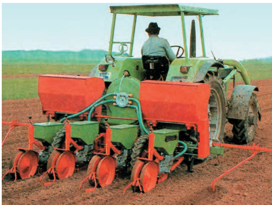
شکل ۲-۴- یک ردیفکار پنوماتیکی حین انجام کار
