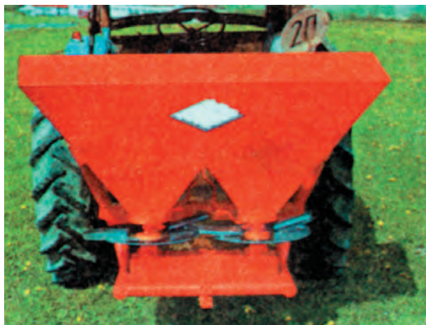
شکل ۱-۲- بذریاش سانتریفوژ با دو صفحه پرتاب کننده
