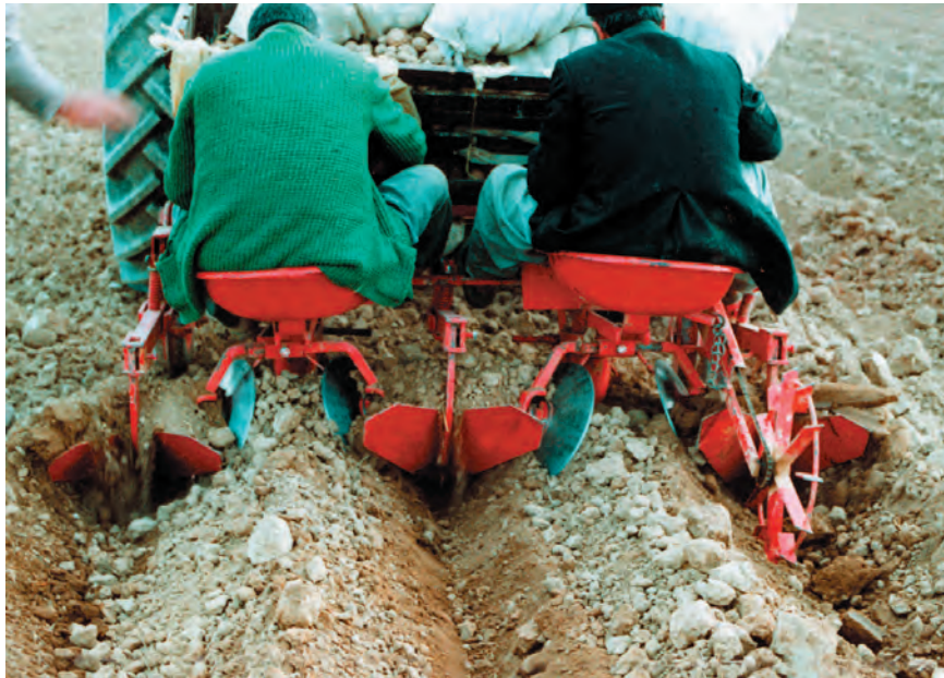
شکل ۲-۶- یک غده کار نیمه خودکار در حین انجام کار با دو کارگر
