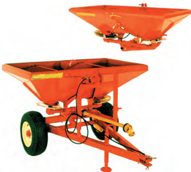
شکل ۲-۲- بذریاش سانتریفوژ با چرخهای ثابت (کششی)
