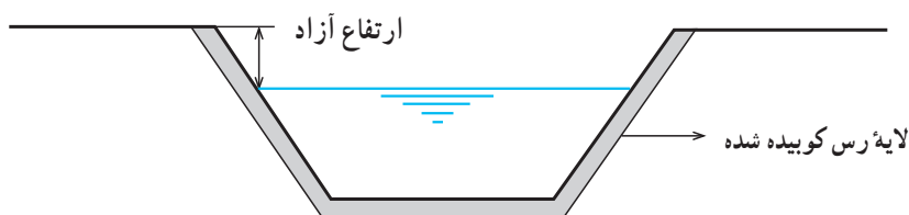
شکل ۲-۱۶- مقطع یک کانال با پوشش خاک رس
