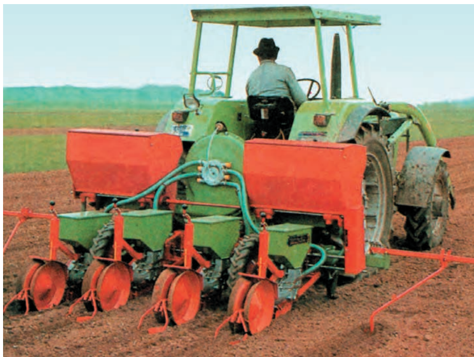
شکل ۲-۴- یک ردیفکار پنوماتیکی حین انجام کار
