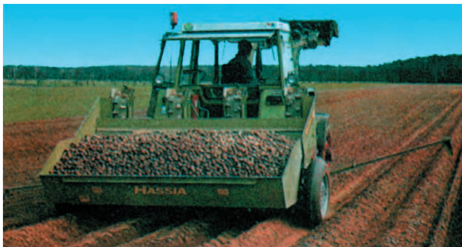
شکل ۲-۷- یک غده کار خودکار در حین کاشت سبب زمینی
