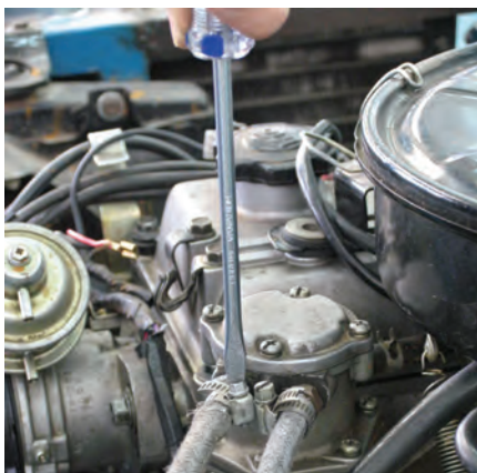
شکل ۱-۴۴-ب: نصب لوله‌ها
