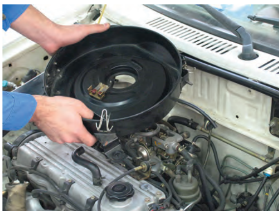
شکل ۱۱۴- ۱ پیاده کردن مجموعه هواکش
