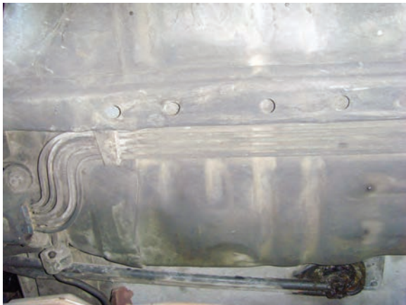
شکل ۱-۳۳ لوله سوخت از مخزن تا پمپ
