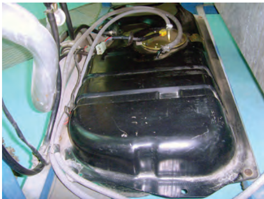
شکل ۱-۲۷ مخزن نصب شده و آماده سوخت گیری
