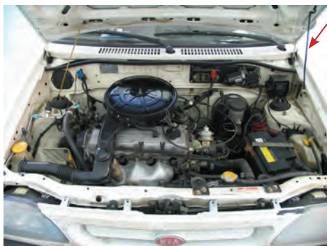
شکل ۱۱۹- ۱ نصب صحیح اهرم نگه‌دارنده درپوش موتور خودرو
