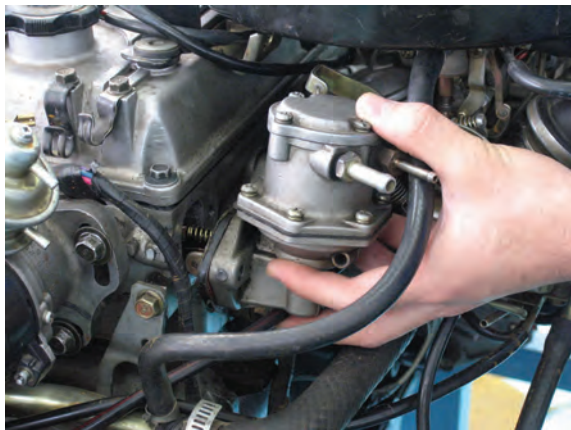
شکل ۴۴-۱ الف: نصب پمپ
