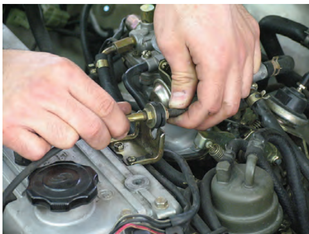
شکل ۱۱۵-۱ پیاده کردن کاربراتور
