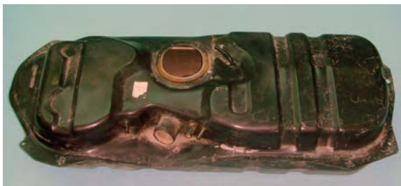
شکل ۱-۲۶ مخزن سوخت آماده نصب
