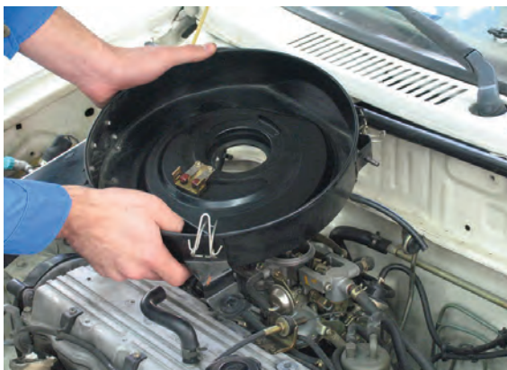
شکل ۱۰۰-۱ پیاده کردن مجموعه هواکش
