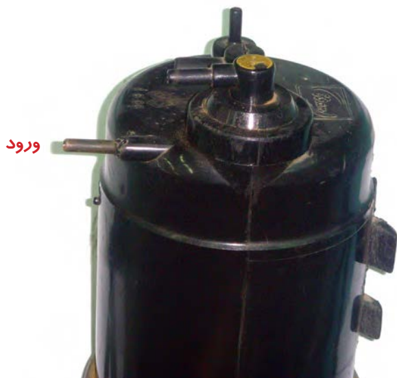
شکل ۱-۹۶ شیر ورودی سوخت‌های تبخیر شده به کنیستر
