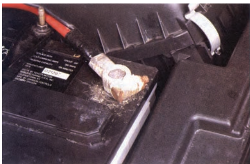
شکل (۲-۸۱) سولفاته شدن بست باتری
