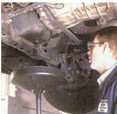
شکل (۲-۵۵) کنترل تخلیه شدن کامل روغن
