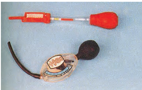
شکل (۲-۷۸) هیدرومتر اسیدسنج
