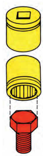
شکل (۱-۱۷) نحوه درگیری آچار بوکس
