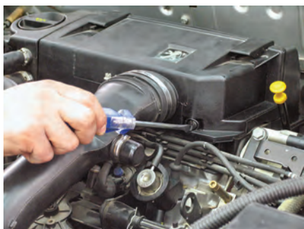
شکل (۲-۶۵) نصب در پوش محافظه فیلتر هوا
