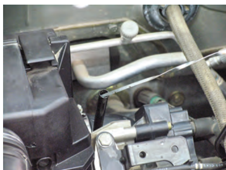
شکل (۲-۵۹) کنترل روغن
