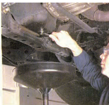
شکل (۲-۵۷) بستن پیچ تخلیه با گشتاور مناسب
