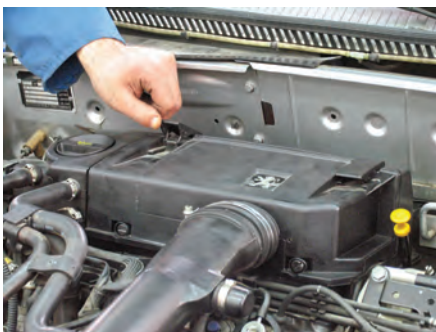
شکل (۲-۶۳) بازکردن در هواکش
