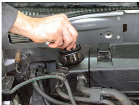
شکل (۴۵- ۲) بازکردن در قالباق موتور
