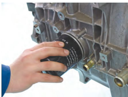
شکل (۲-۵۴) نصب و محکم کردن فیلتر
