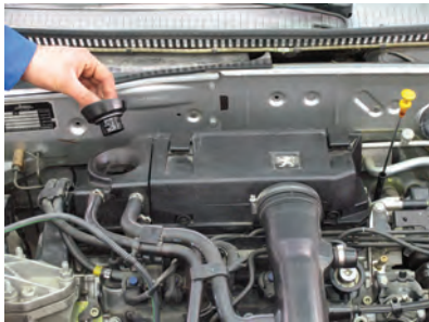
شکل (۲-۵۰) بازکردن درب قالباق موتور
