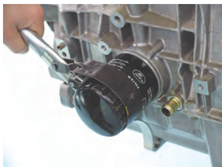
شکل (۴۸- ۲) بازکردن فیلتر با ابزار مخصوص
