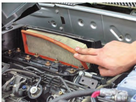
شکل (۲-۶۴) پیاده کردن فیلتر هوا
