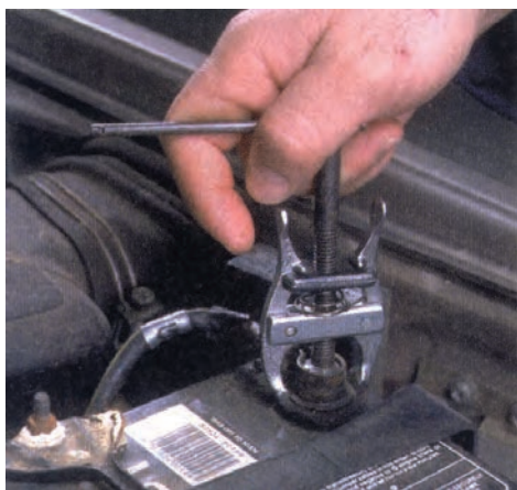
شکل (۲-۸۲) باز کردن بست باتری
