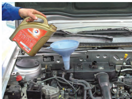
شکل (۲-۵۸) شارژ با روغن توصیه شده
