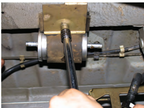
شکل (۲-۶۸) نصب فیلتر جدید
