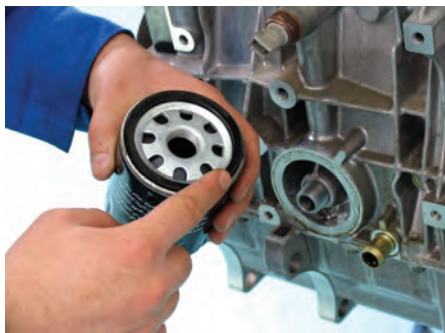
شکل (۲-۵۳) کنترل دندانه و واشر لاستیکی فیلتر
