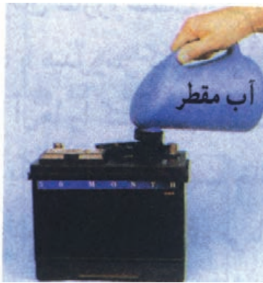
شکل (۲-۸۹) اضافه کردن مایع باتری
