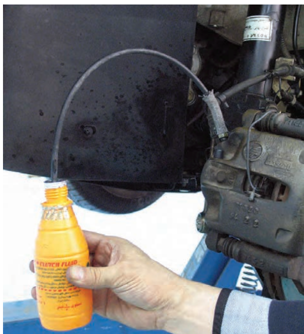
شکل ۱-۷۱- نصب لوله پلاستیکی روی پیچ هواگیری
