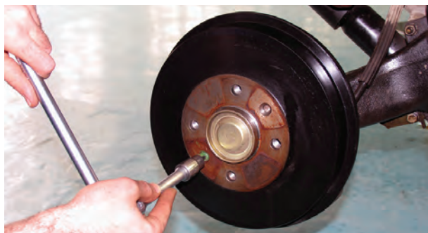
شکل ۱-۸۹ – باز کردن پیچ کاسه چرخ
