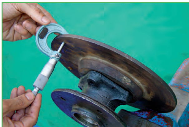
شکل ۱-۱۲۴- اندازه‌گیری ضخامت دیسک
