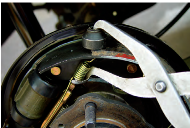
شکل ۱-۱۰۷- جازدن فنر بالایی کفشک
