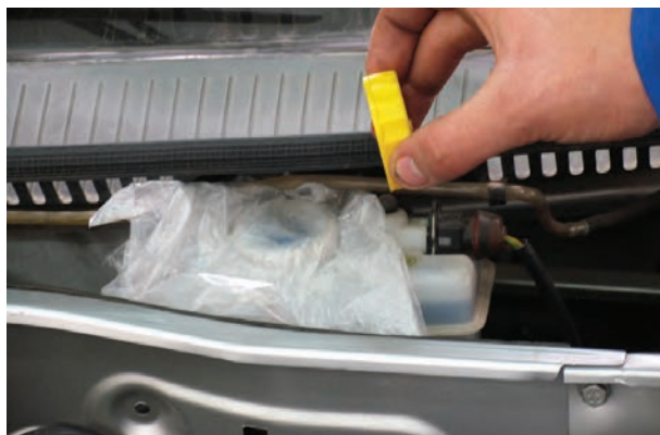
شکل ۱۳۸-۱- مسدود کردن در مخزن مایع ترمز
