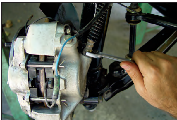
شکل ۱۱۹-۱ باز کردن شیلنگ ترمز
