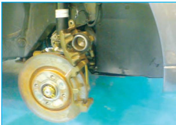
شکل ۱۱۰-۱- باز کردن پوسته نگاه‌دارنده لنت‌ها
