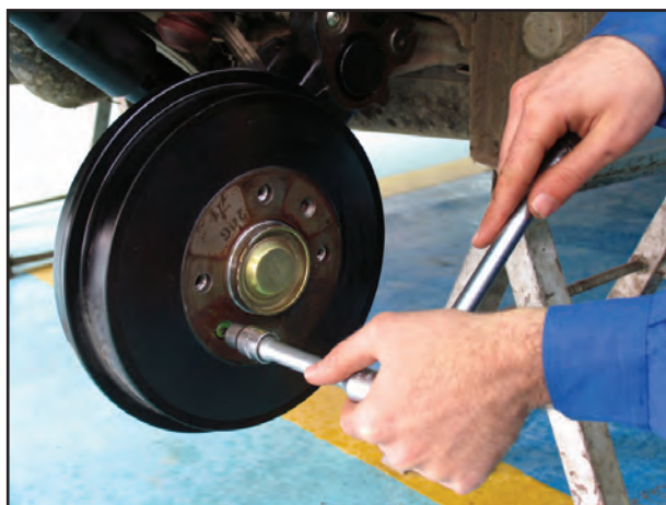
شکل ۱-۱۰۲- بستن پیچ نگه‌دارنده کاسه چرخ
