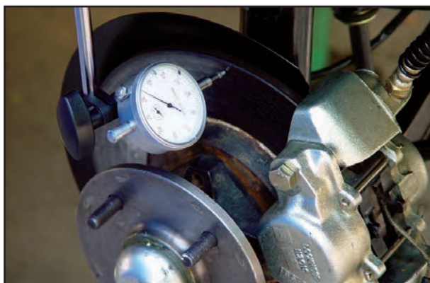
شکل ۱-۱۲۳- بررسی وضعیت دیسک
