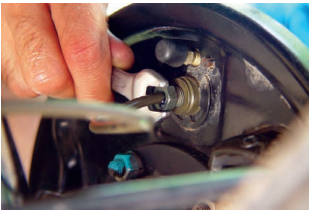
شکل ۱۰۵-۱- باز کردن مهره اتصال لوله ترمز
