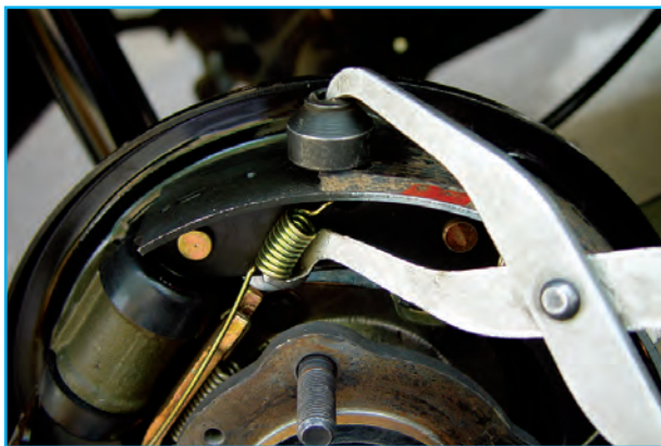
شکل ۹۱-۱- خارج کردن فنر بالایی
