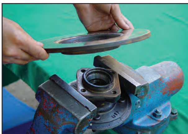
شکل ۱-۱۲۶- باز کردن دیسک ترمز
