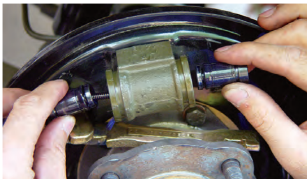
شکل ۹۴-۱- خارج کردن پیستون‌ها
