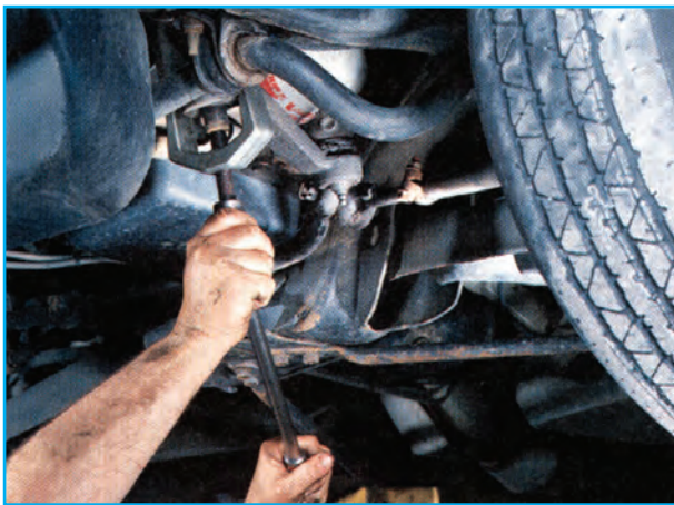
شکل ۲-۴۷- نحوه استفاده از نوعی سیبک کش
