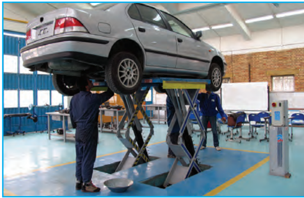
شکل ۲-۴۶- استقرار خودروی روی بالابر
