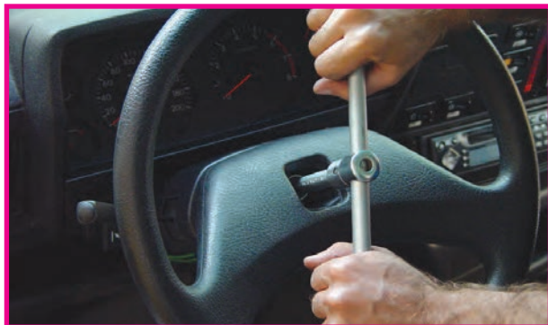
شکل ۲-۳۳- پیاده کردن فلکه فرمان
