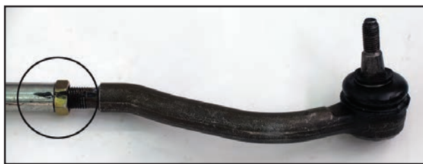
شکل ۲-۷۴- علامت گذاری سبیک و میل رابط
