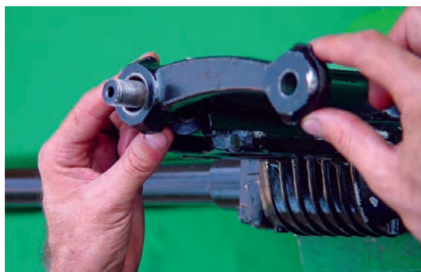
شکل ۲-۵۹- پیاده کردن اهرم هزار خار
