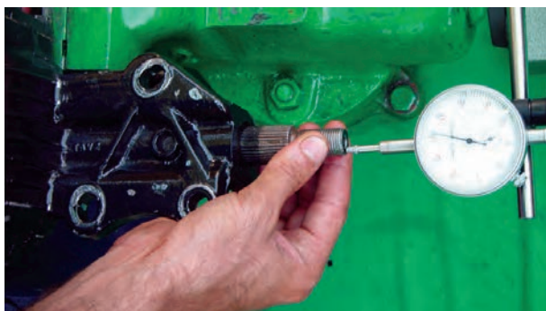
شکل ۷۰-۲- اندازه‌گیری لقی طول محور هزار خار
