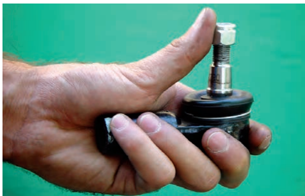
شکل ۸۴-۲- کنترل لقی سیبک‌ها
