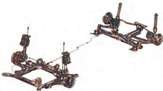
شکل ۳-۴۱- سیستم تعلیق عقب و جلو خودرو
