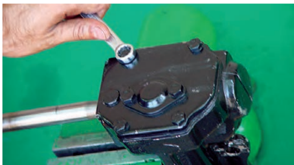
شکل ۲-۶۲- باز کردن درپوش بالایی جعبه فرمان
