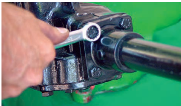
شکل ۲-۶۰- باز کردن پیچ‌های لوله فرمان
