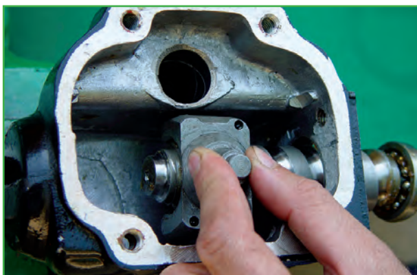
شکل ۲-۶۳- خارج کردن محفظه ساچمه‌ها
