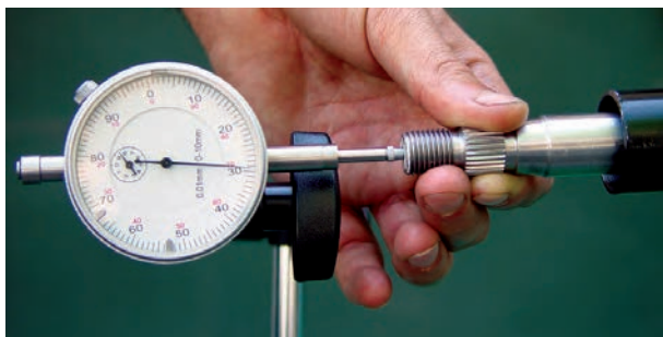
شکل ۶۸-۲- اندازه‌گیری لقی طولی میل فرمان
