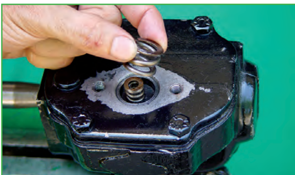
شکل ۲-۶۱- خارج کردن فنرها
