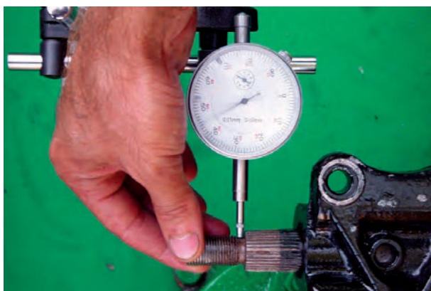
شکل ۷۱-۲- اندازه‌گیری لقی جانبی محور هزار خار
