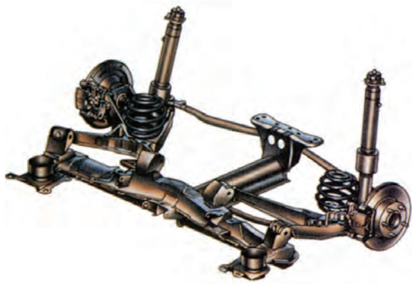
شکل ۳-۴۸- سیستم تعلیق مستقل عقب با چرخ‌های متحرک
