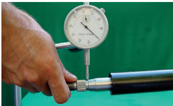
شکل ۶۹-۲- اندازه‌گیری لقی جانبی میل فرمان
