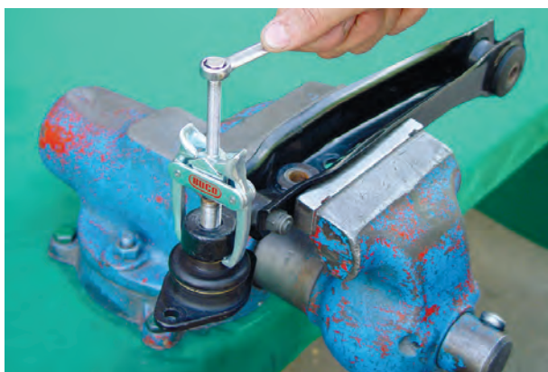
شکل ۳-۸۵- جدا کردن سیبک از بازوی اتصال
