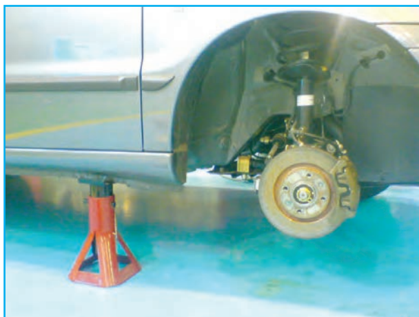
شکل ۳-۶۱- خودروی مستقر بر پایه قابل تنظیم
