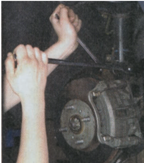
شکل ۳-۱۰۰ نصب مجموعه سیستم تعلیق روی خودرو
