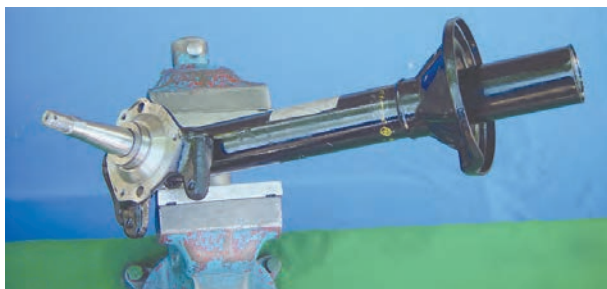
شکل ۳-۹۷- پوسته کمک فنر و محور چرخ
