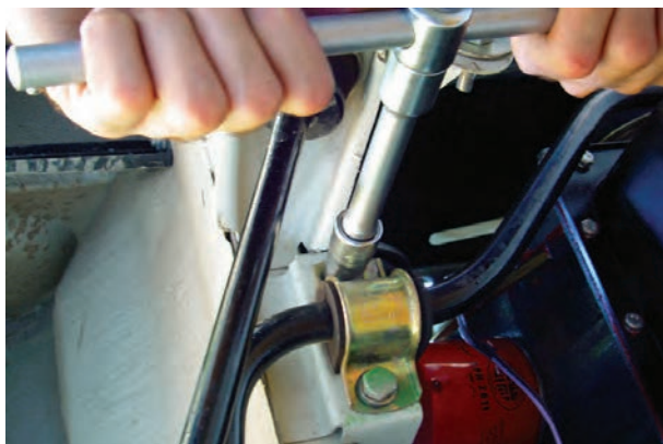
شکل ۳-۸۶- باز کردن میله ضد غلتش (موج گیر)
