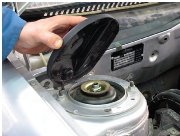
شکل ۳-۱۰۳- برداشتن پوشش بالای تکیه‌گاه کمک فنر
