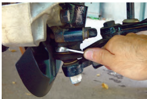
شکل ۳-۷۸- باز کردن سبک زیر کمک فنر
