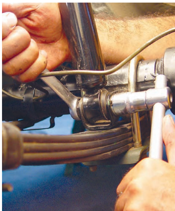
شکل ۳-۶۴ – باز کردن پیچ و مهره اتصال پایینی کمک فتر
