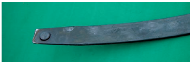
شکل ۷۰-۳- لاستیک‌های محافظ انتهایی لایه‌های فنر شمش
