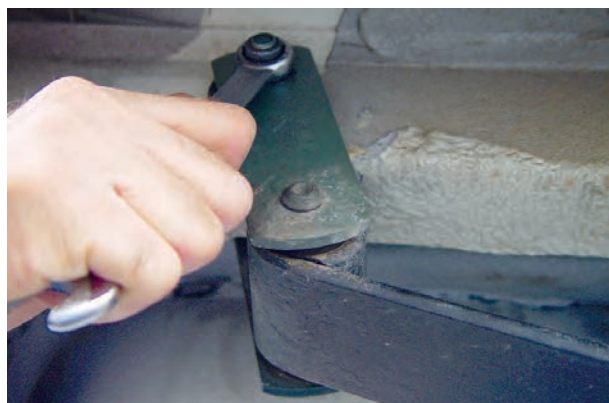
شکل ۳-۶۴ – باز کردن پیچ و مهره اتصال پایینی کمک فتر
