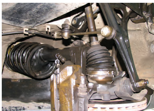
شکل ۱۳۱-۳- نصب میل موج گیر کوتاه
