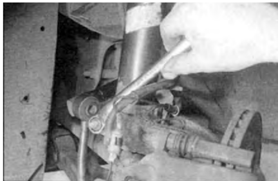
شکل ۱۱۸-۳- بستن پیچ نگه‌دارنده کمک فنر
