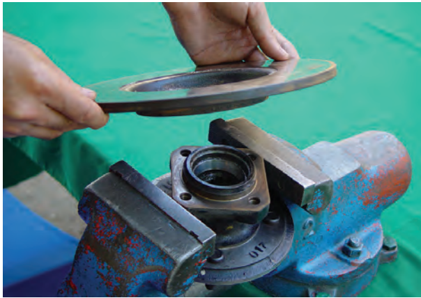
شکل ۳-۹۸- جدا کردن دیسک ترمز از تویی چرخ
