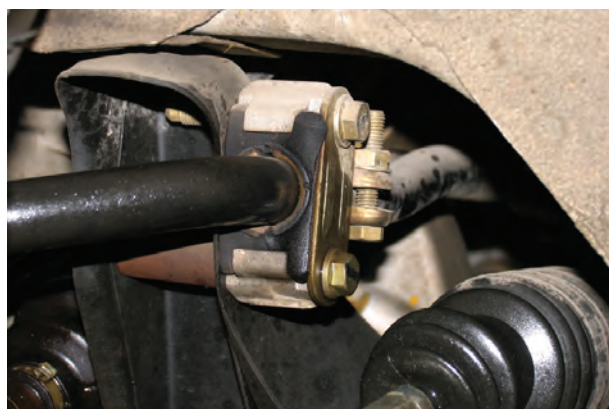
شکل ۱۳۲-۳- نصب بست های میل موج گیر بلند
