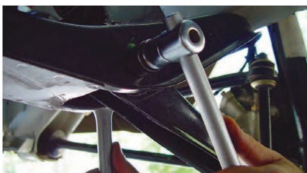
شکل ۳-۸۳- باز کردن طبق از رام
