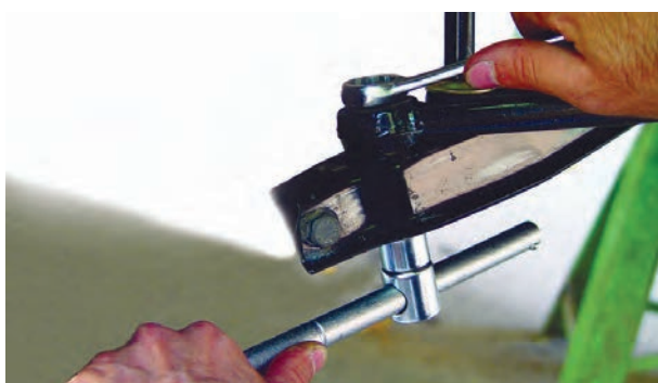
شکل ۳-۸۱ باز کردن میل تعادل از طبق
