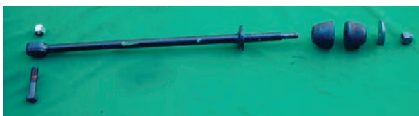
شکل ۳-۸۴- اجزای میل تعادل
