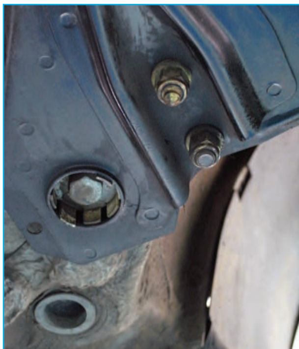
شکل ۱۳۰-۳- پیاده کردن میل موج گیر بلند
