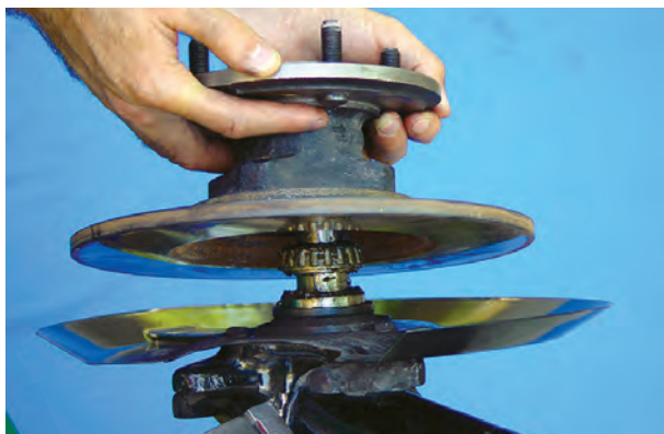
شکل ۳-۹۴- خارج کردن دیسک ترمز و تویی از روی محور چرخ
