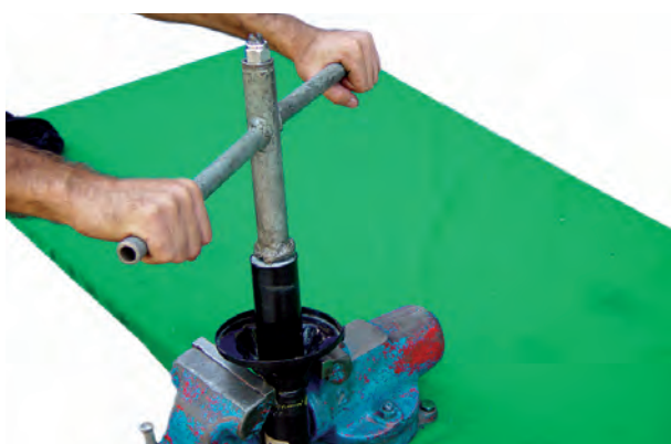
شکل ۳-۹۱- باز کردن مهره نگه‌دارنده کمک فنر
