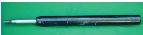
شکل ۳-۹۲- کمک فنر قابل تعویض
