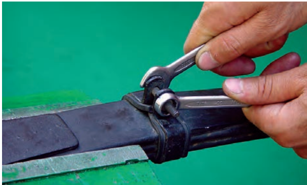
شکل ۳-۶۷- باز کردن بست‌های مجموعه فنر شمش
