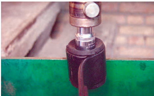
شکل ۳-۶۹- بوش لاستیکی فلزی محل اتصال شاه فنر
