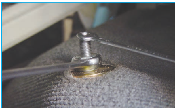
شکل ۳-۶۳- باز کردن مهره اتصال بالای کمک فنر
