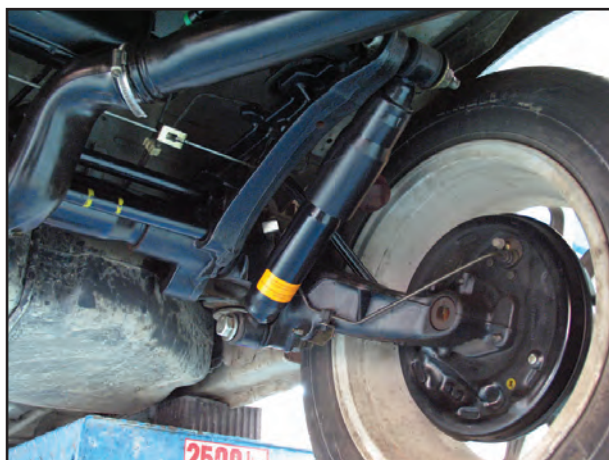
شکل ۱۶۱-۳- محل استقرار کمک فنر و پیچ‌های بالا و پایین آن
