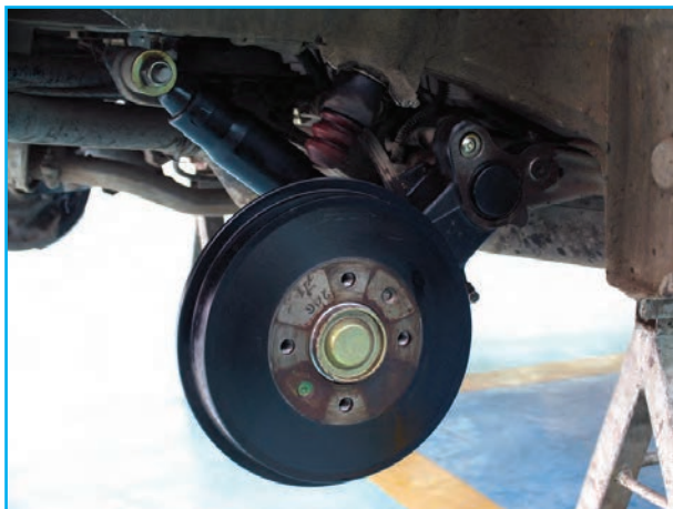
شکل ۱۸۳-۳- نصب ژامبون و متعلقات چرخ عقب
