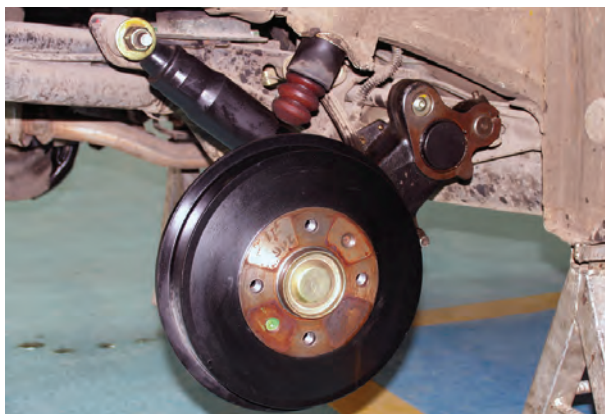
شکل ۱۷۷-۳- نصب کمک فنر
