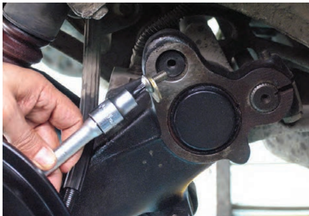
شکل ۱۷۶-۳- نصب واشر فشار و بیج‌های انتهای میله‌ها
