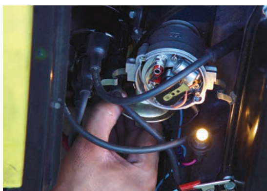
شکل ۳-۹۲- لحظه باز شدن دهانه پلاتین و روشن شدن لامپ
