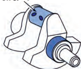
دو شاتون روی یک محور
