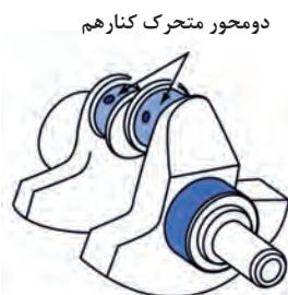
دو شاتون روی یک محور
