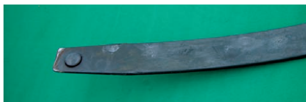
شکل ۳-۷۰- لاستیک‌های محافظ انتهایی لایه‌های فنر شمش
