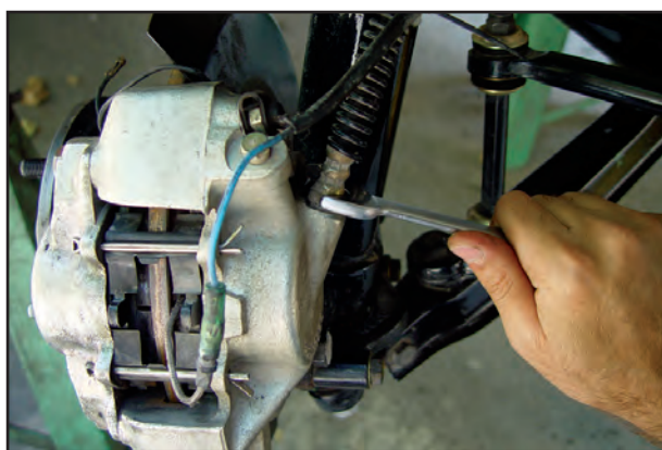
شکل ۱-۱۱۹- باز کردن شیلنگ ترمز
