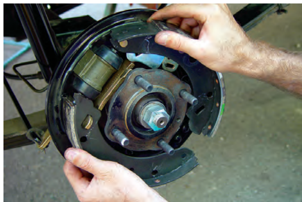
شکل ۹۳-۱- خارج کردن کفشک‌ها
