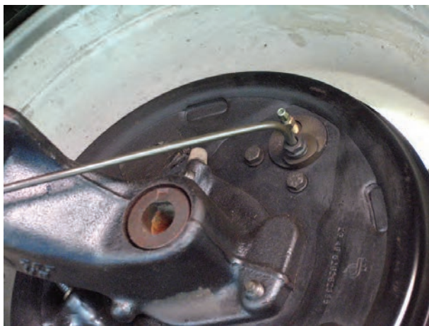
شکل ۱۰۳-۱- پاک کردن اطراف اتصالات
