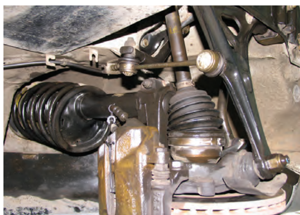
شکل ۱۳۱- نصب میل موج گیر کوتاه
