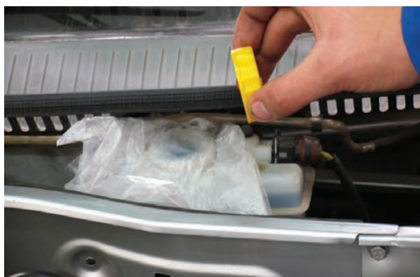
شکل ۱۳۸-۱- مسدود کردن در مخزن مایع ترمز
