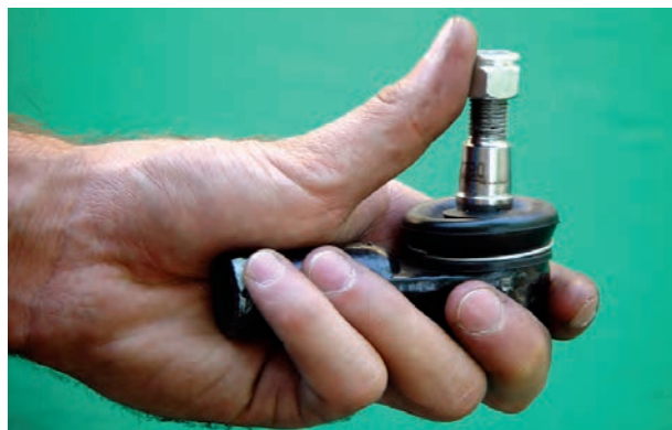
شکل ۸۴-۲ کنترل لقی سیبک‌ها
