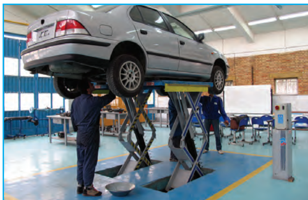
شکل ۴۶-۲ استقرار خودروی روی بالابر
