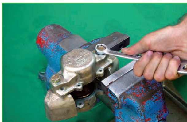
شکل ۱-۱۲۰- باز کردن پیچ های کالیپر
