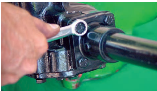
شکل ۲-۶۰ باز کردن پیچ‌های لوله فرمان
