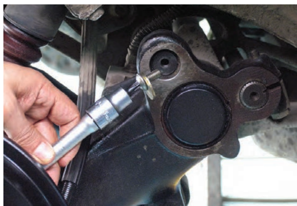
شکل ۱۷۶-۳- نصب واشر فشار و پیچ های انتهای میله ها
