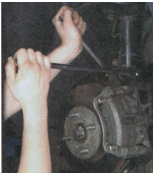
شکل ۳-۱۰۰ نصب مجموعه سیستم تعلیق روی خودرو
