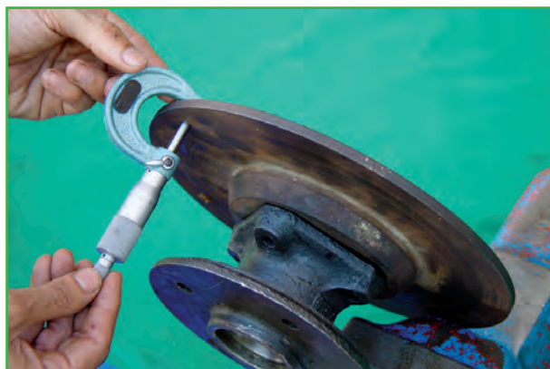
شکل ۱۲۴-۱ اندازه‌گیری ضخامت دیسک
