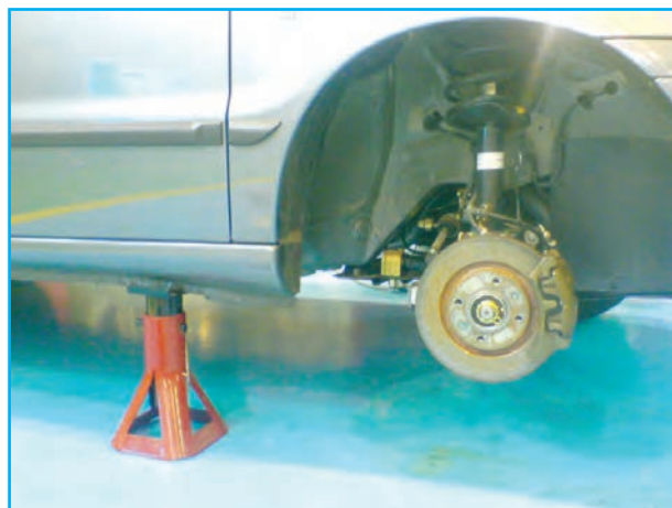
شکل ۳-۶۱- خودروی مستقر بر پایه قابل تنظیم
