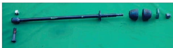
شکل ۳-۸۴ اجزای میل تعادل
