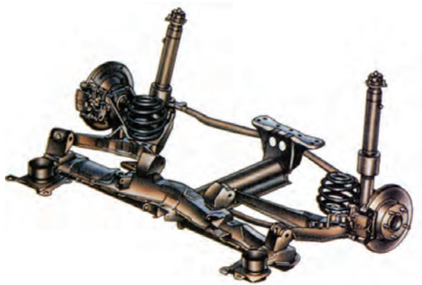
شکل ۳-۴۸ سیستم تعلیق مستقل عقب با چرخ‌های متحرک
