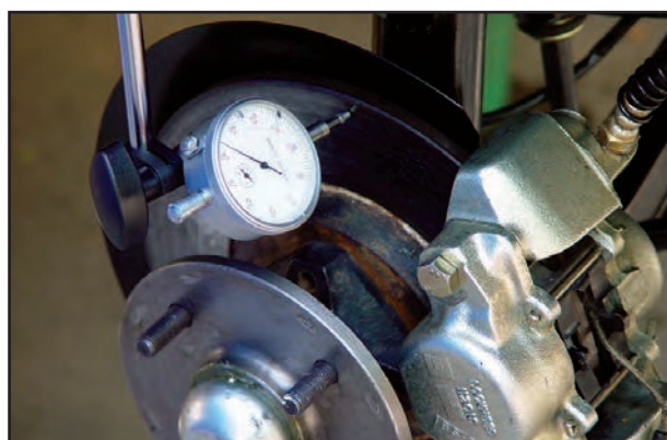
شکل ۱-۱۲۳- بررسی وضعیت دیسک
