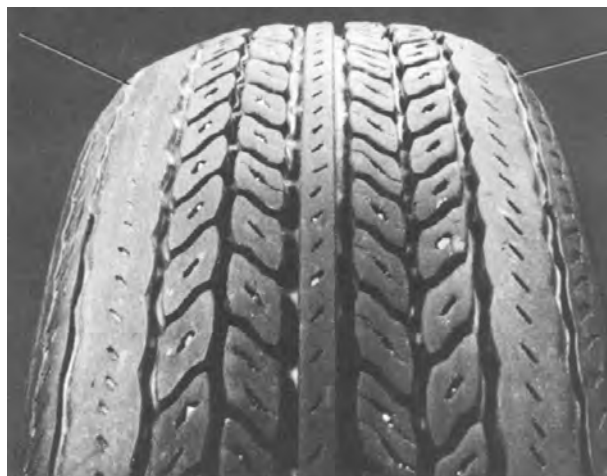
شکل ۲۱۴-۳- ساییش در اثر رانندگی غلط (پیچیدن تند)
