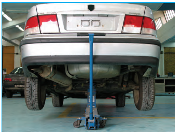
شکل ۳-۱۵۶ تنظیم ارتفاع و کنترل رام لوله‌ای
