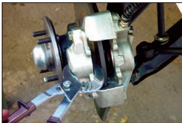
شکل ۱۱۴-۱- عقب راندن پیستون ترمز دیسکی
