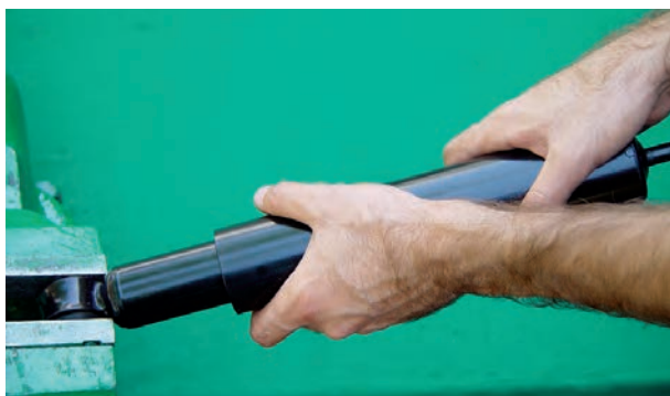
شکل ۳-۷۴- آزمایش کمک فنر
