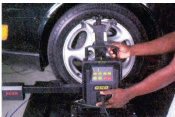
شکل ۳-۲۲۰ - نصب مجموعه حسگر دستگاه اندازه‌گیر رایانه‌ای
