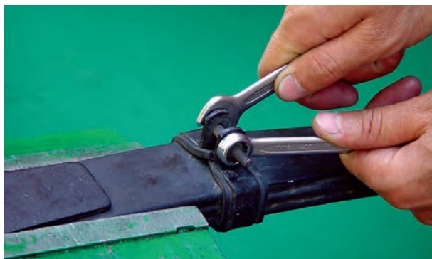
شکل ۳-۶۷- باز کردن بست‌های مجموعه فنر شمش
