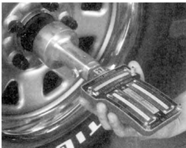
شکل ۲۱۷-۳- دستگاه اندازه‌گیری زوایای مکانیکی (ترازی)
