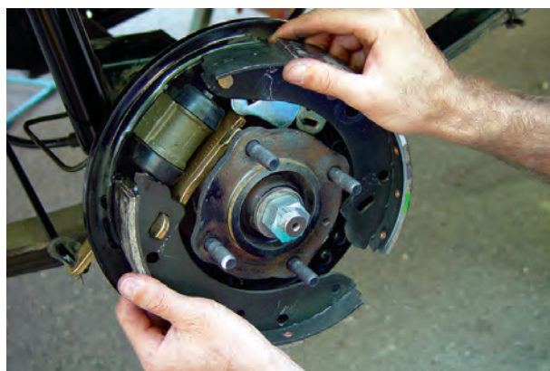
شکل ۱۰۴-۱- خارج کردن کفشک‌ها
