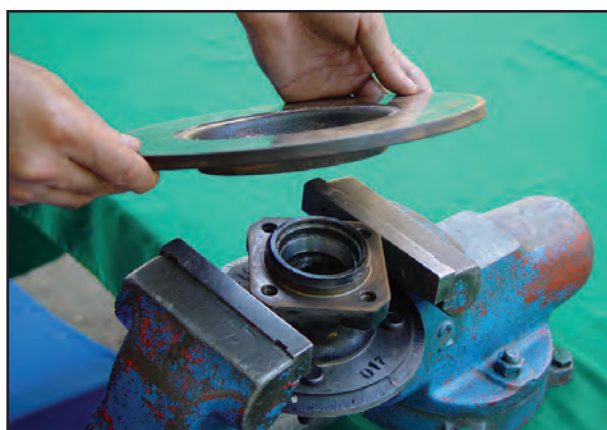
شکل ۱۲۶-۱ بازکردن دیسک ترمز
