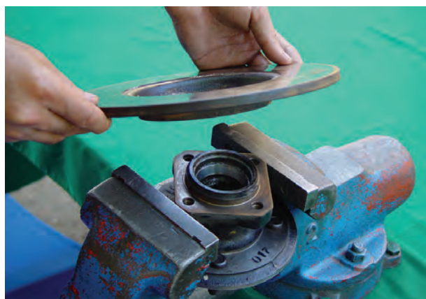
شکل ۳-۹۸- جدا کردن دیسک ترمز از تویی چرخ
