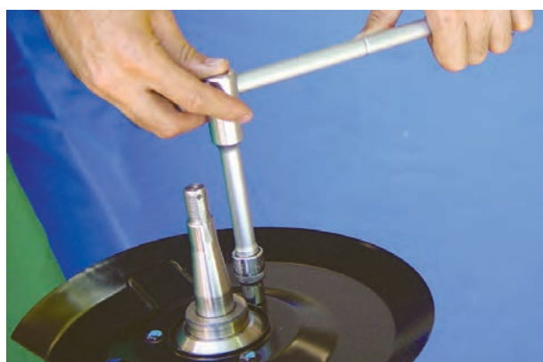
شکل ۳-۹۶- باز کردن صفحه پشت توپی چرخ
