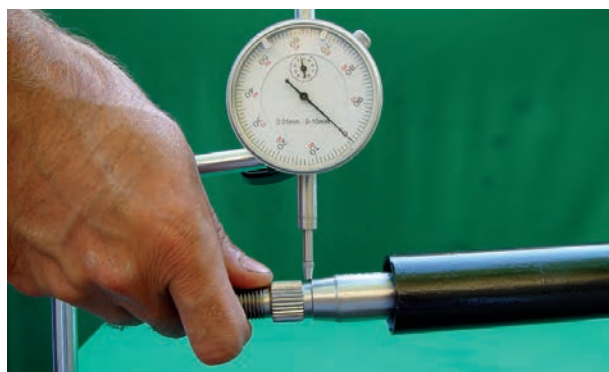
شکل ۶۹-۲ اندازه‌گیری لقی جانبی میل فرمان
