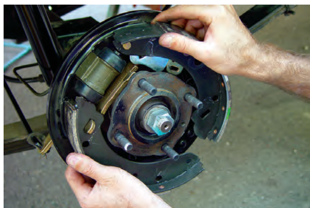
شکل ۱-۱۰۶- نصب کفشک‌ها
