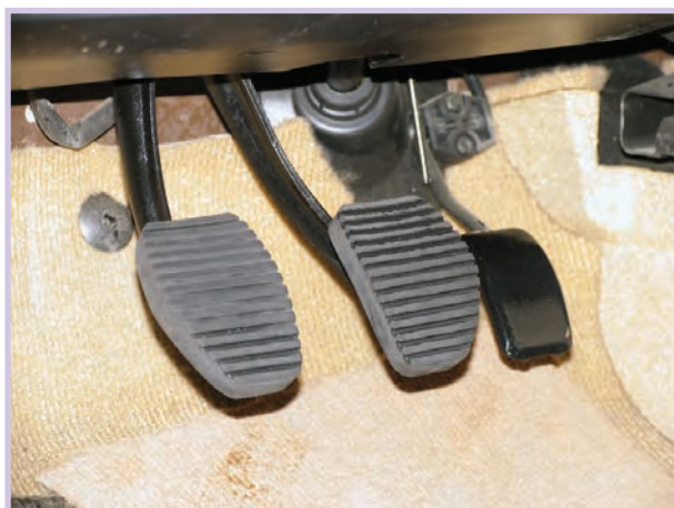
شکل ۱-۱۵ مجموعه پدال‌های ترمز و کلاچ
