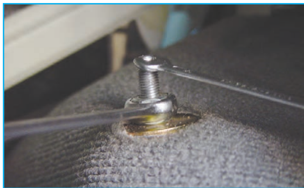
شکل ۳-۶۳- باز کردن مهره اتصال بالای کمک فنر
