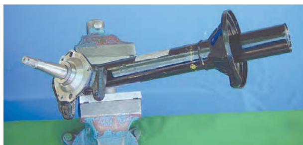
شکل ۳-۹۷- پوسته کمک فنر و محور چرخ
