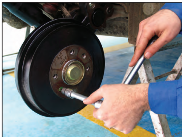
شکل ۱-۱۰۲ – بستن پیچ نگه‌دارنده کاسه چرخ
