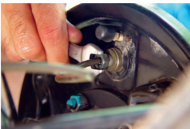
شکل ۱۰۵-۱- باز کردن مهره اتصال لوله ترمز
