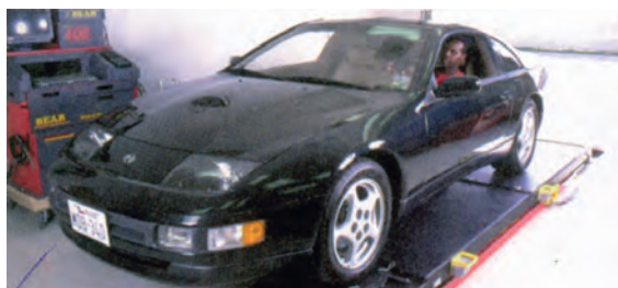
شکل ۳-۲۱۹ - دستگاه اندازه‌گیری زوایای رایانه‌ای (کامپیوتری)
