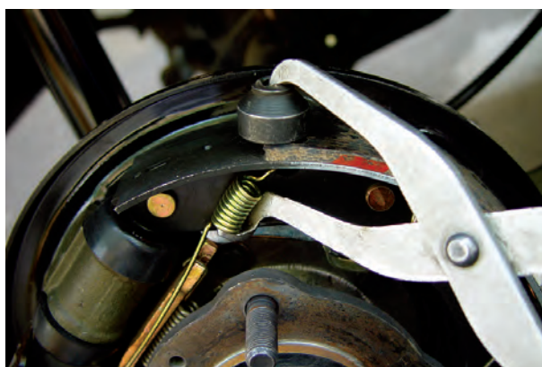
شکل ۱-۱۰۷- جا زدن فنر بالایی کفشک
