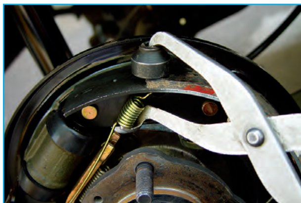
شکل ۹۱-۱- خارج کردن فنر بالایی
