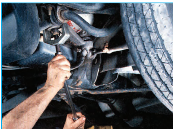
شکل ۴۷-۲ نحوه استفاده از نوعی سیبک کش
