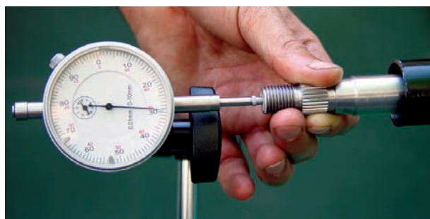
شکل ۶۸-۲ اندازه‌گیری لقی طولی میل فرمان
