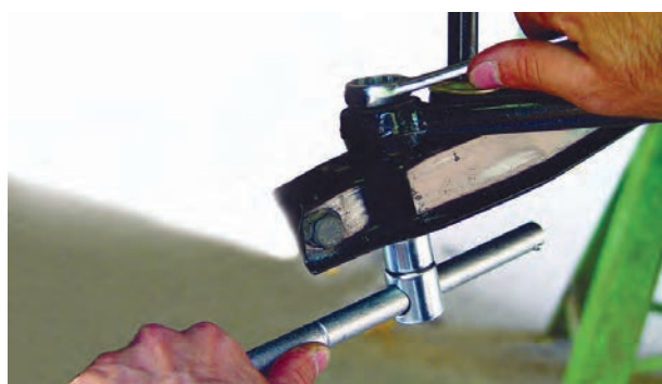
شکل ۳-۸۱- باز کردن میل تعادل از طبق
