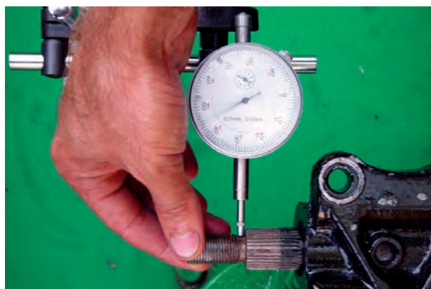
شکل ۷۱-۲ اندازه‌گیری لقی جانبی محور هزار خار
