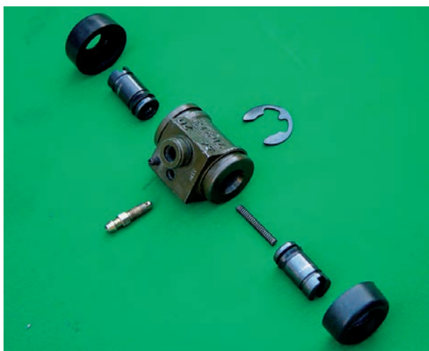
شکل ۹۵-۱- اجزای پمپ ترمز چرخ
