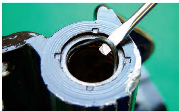
شکل ۶۵-۲- تعویض لاستیک
