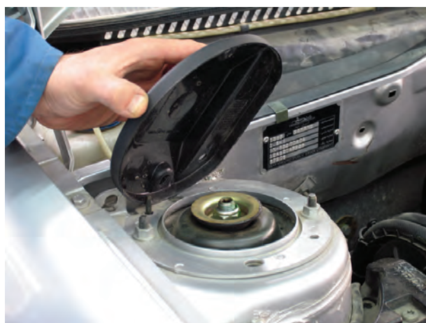
شکل ۳-۱-۳- برداشتن پوشش بالای تکیه‌گاه کمک فنر
