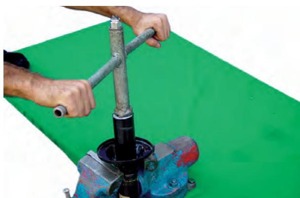
شکل ۳-۹۱- باز کردن مهره نگه‌دارنده کمک فنر
