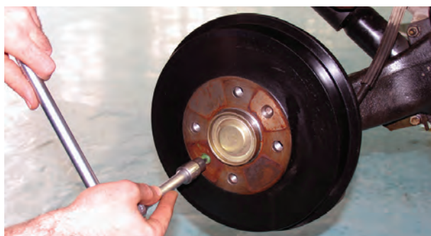
شکل ۸۹-۱ – باز کردن پیچ کاسه چرخ
