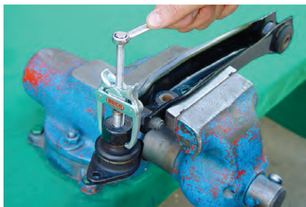
شکل ۳-۸۵ جدا کردن سیبک از بازوی اتصال
