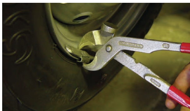
شکل ۲۳۳-۳- تمیز کردن و پیاده کردن سرب‌های قبلی
