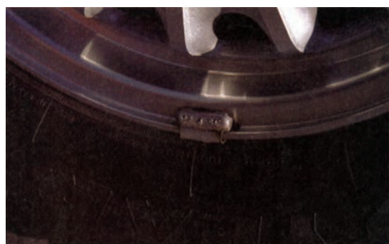
شکل ۳-۲۳۱- نصب وزنه روی رینگ
