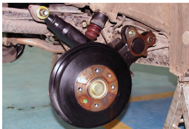
شکل ۱۷۷-۳- نصب کمک فنر
