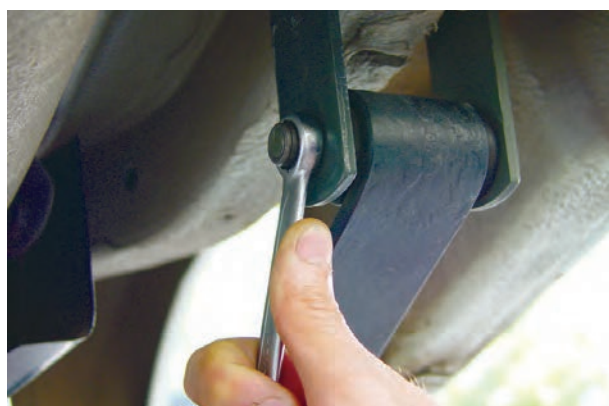
شکل ۳-۶۵ – باز کردن مهره‌های گوشواره فنر شمش
