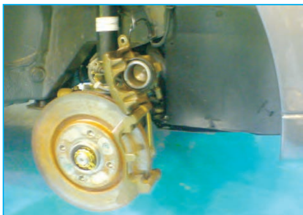
شکل ۱۱۰-۱- باز کردن پوسته نگه‌دارنده لنت‌ها
