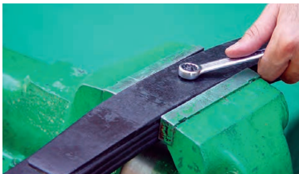
شکل ۳-۶۸- باز کردن پیچ مرکز فنرهای شمش
