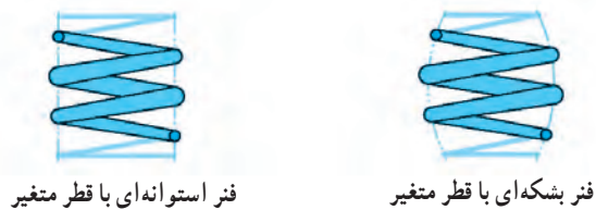
شکل ۲۷-۳ انواع فنر مارپیچی
