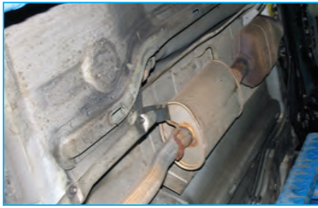
شکل ۱-۵۱ – سپر حرارتی آگزوز
