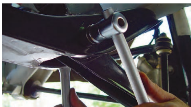
شکل ۳-۸۳ باز کردن طبق از رام
