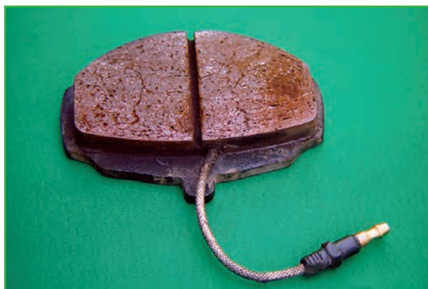
شکل ۱۱۲-۱- لنت ترمز دارای سیم هشدار
