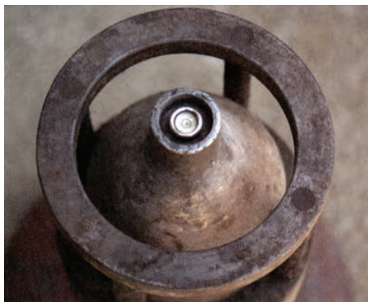
شکل ۳-۲۳۰- دستگاه بالانس حباب‌دار
