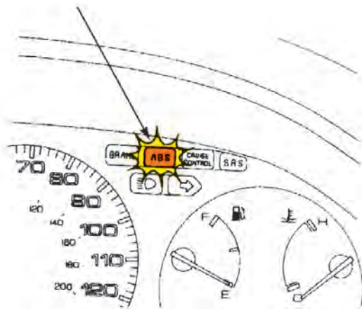
شکل ۱۶۱- چراغ اخطار ترمز ضد قفل (ABS)
