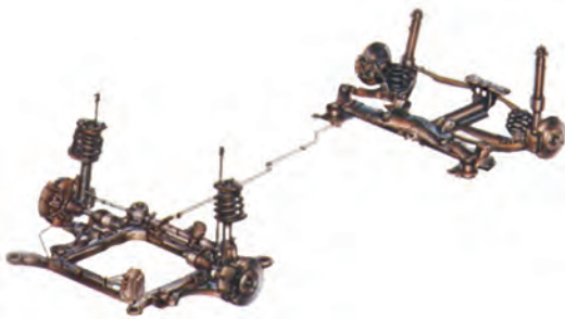
شکل ۴۱-۳ سیستم تعلیق عقب و جلو خودرو
