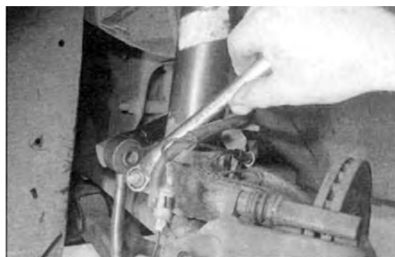
شکل ۱۱۸-۳- بستن پیچ نگه‌دارنده کمک فنر
