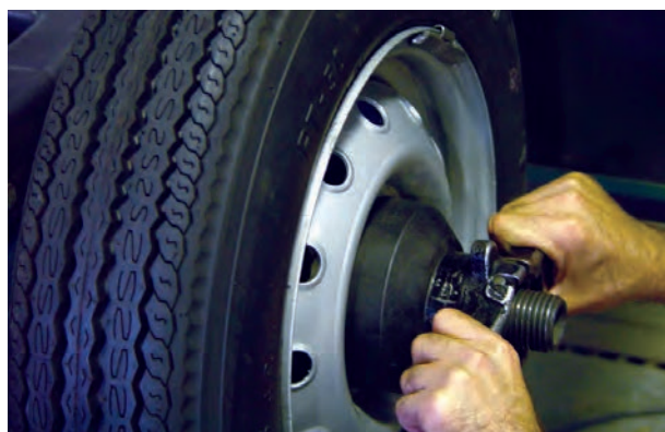
شکل ۲۳۴-۳- نصب چرخ روی دستگاه
