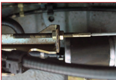
شکل ۴۸-۱- باز کردن مهره تنظیم کننده
