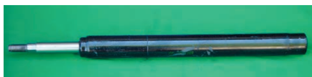
شکل ۳-۹۲- کمک فنر قابل تعویض
