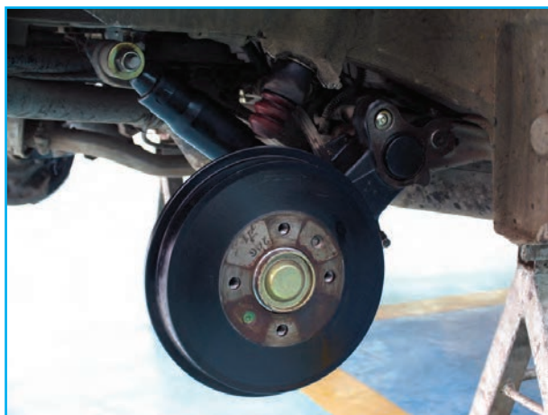
شکل ۱۸۳-۳- نصب ژامبون و متعلقات چرخ عقب
