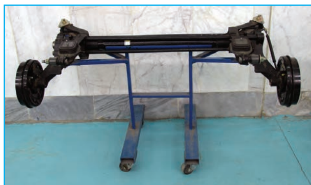
شکل ۳-۱۵۹- مجموعه تعلیق عقب
