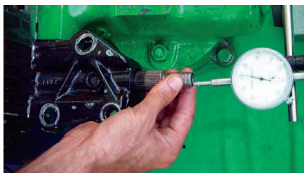
شکل ۷۰-۲ اندازه‌گیری لقی طول محور هزار خار
