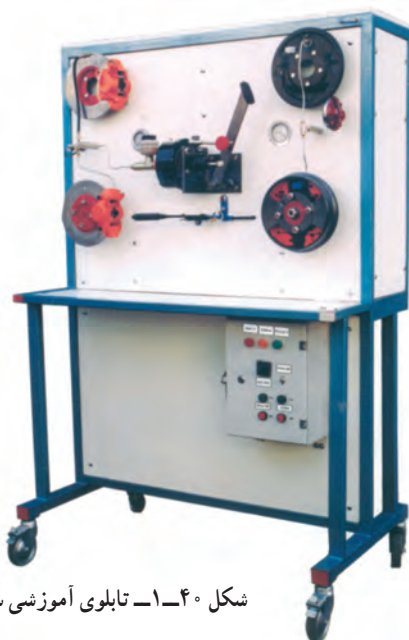
شکل ۱-۳۹- مجموعه ترمز دیسکی
