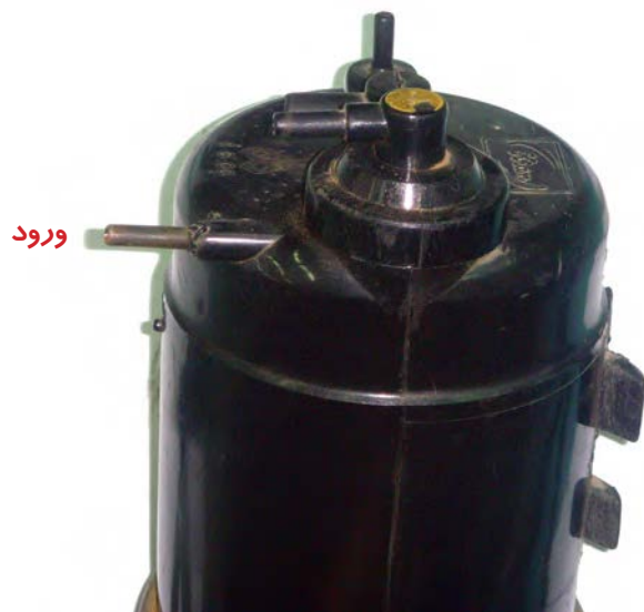
شکل ۱-۹۶ شیر ورودی سوخت‌های تبخیر شده به کنیستر
