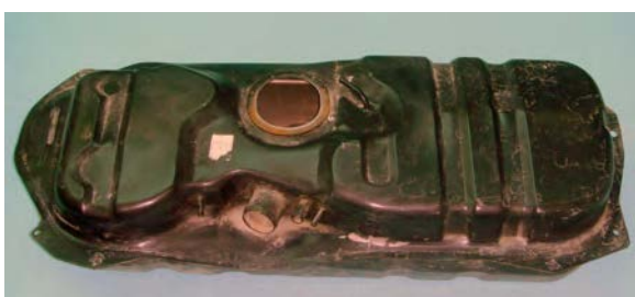
شکل ۱-۲۶ مخزن سوخت آماده نصب
