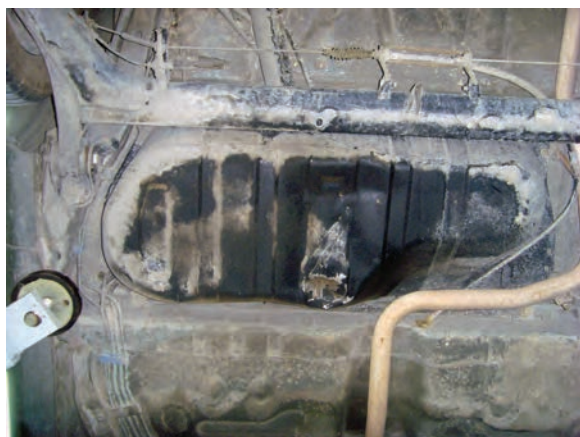
شکل ۱-۲۴ مخزن سوخت از قسمت زیر اتومبیل
