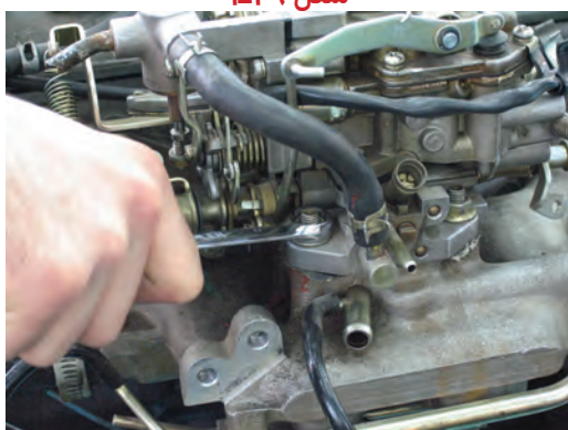
شکل ۱-۱۱۰ باز کردن پیچهای اتصال کاربراتور به موتور
