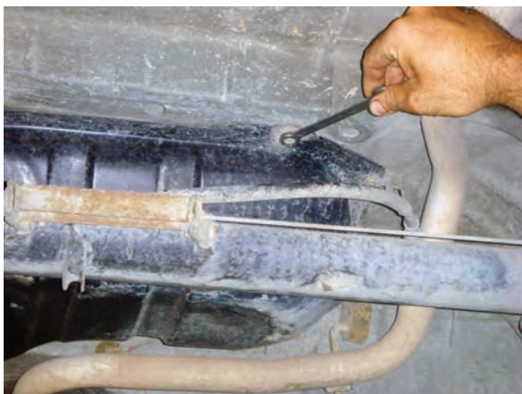
شکل ۱-۲۵ باز کردن پیچهای دور باک
