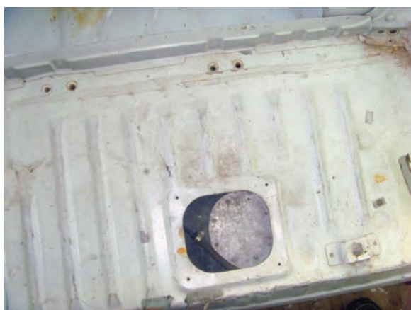
شکل ۱-۲۳ مخزن سوخت از داخل صندوق عقب
