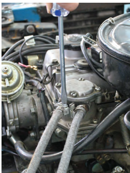
شکل ۱-۳۲ اتصال لوله سوخت به پمپ
