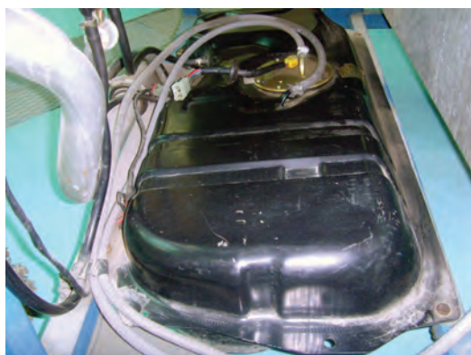
شکل ۱-۲۷ مخزن نصب شده و آماده سوخت گیری
