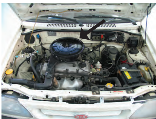
شکل ۵۰-۱ هواکش موتور کاربراتوری
