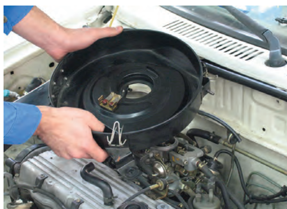
شکل ۱۰۰-۱ پیاده کردن مجموعه هواکش
