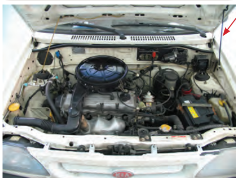
شکل ۱۱۹- ۱ نصب صحیح اهرم نگه‌دارنده درپوش موتور خودرو
