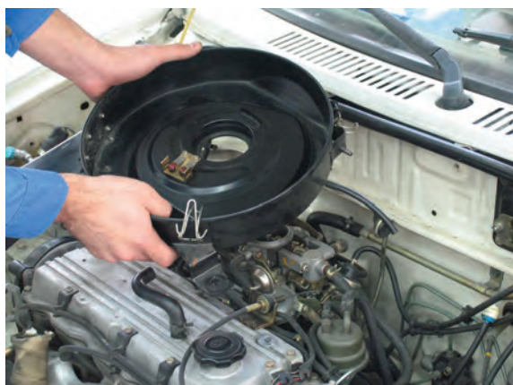
شکل ۱۱۴- ۱ پیاده کردن مجموعه هواکش
