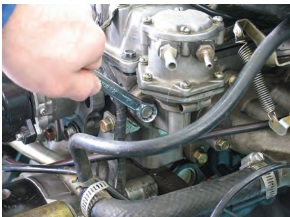
شکل ۴۲-۱ پیاده کردن پمپ
