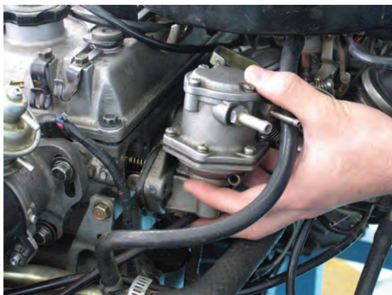
شکل ۴۴-۱ الف: نصب پمپ
