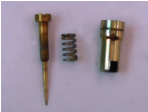
شکل ۱-۷۴ پیچ مخروطی و فجر تثبیت کننده سوخت دور آرام
