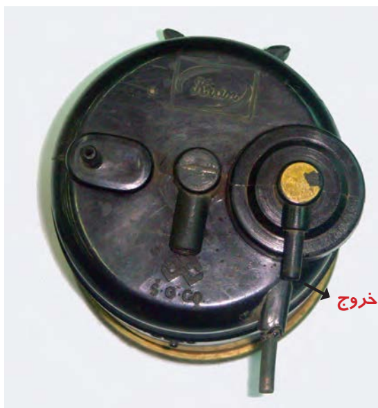
شکل ۱-۹۷ شیر خروجی سوخت‌های دمای تبخیر شده از کنیستر
