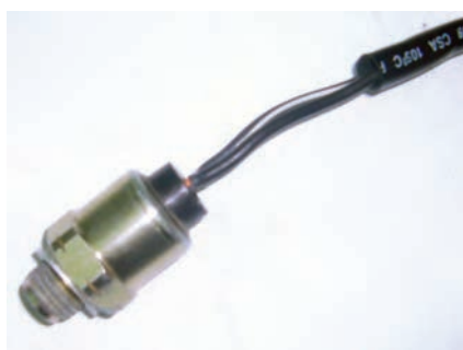
شکل ۱-۹۲ سلونوئید مدار دور آرام
