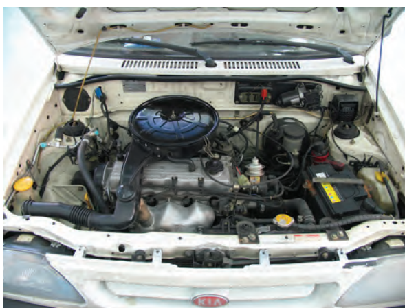
شکل ۱۱۳- ۱ موتور کاربراتورهای روی پایه
