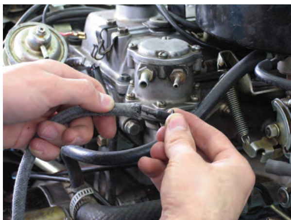
شکل ۱-۴۱ جدا کردن لوله‌ها
