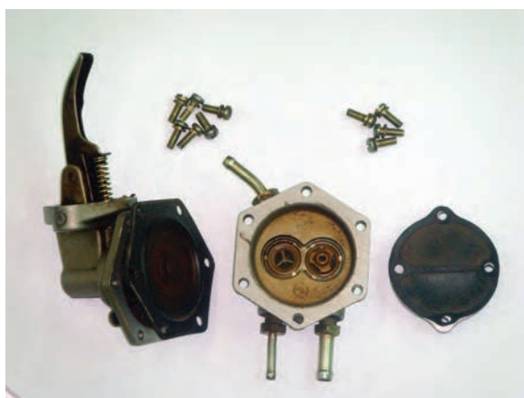
شکل ۴۳-۱ اجزای پمپ سوخت
