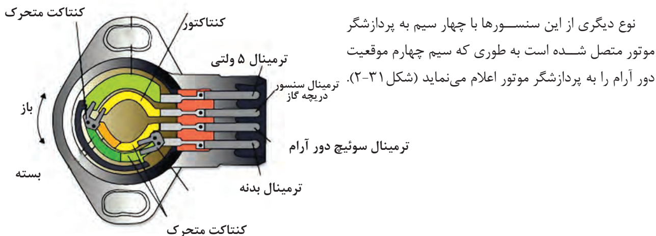
شکل ۲-۳۱- سنسور موقعیت دریچه گاز
