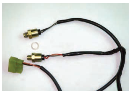
شکل ۱-۹۱ اجزای الکتریکی در یک نوع کاربراتور
