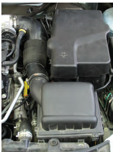
شکل ۵۱-۱ هواکش موتور انژکتوری
