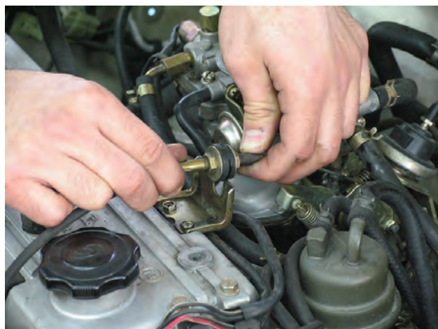
شکل ۱۱۵-۱ پیاده کردن کاربراتور
