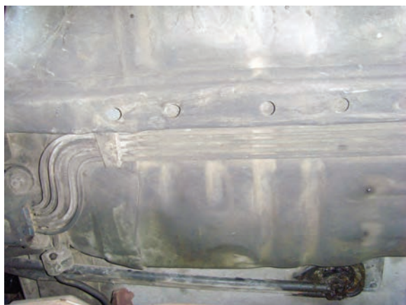
شکل ۱-۳۳ لوله سوخت از مخزن تا پمپ
