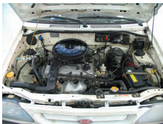
شکل ۹۹-۱ خودرو با سیستم سوخت‌رسانی کاربراتوری
