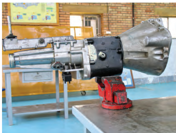
شکل ۱۶۳- جعبه دنده خودروی محرک عقب
