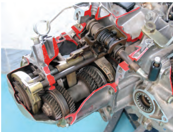
شکل ۱۶۲- جعبه دنده خودروی محرک جلو
