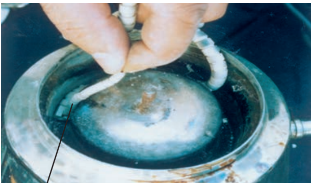
شکل ۲-۲۱ محلی که عایق‌بندی ضعیف است
