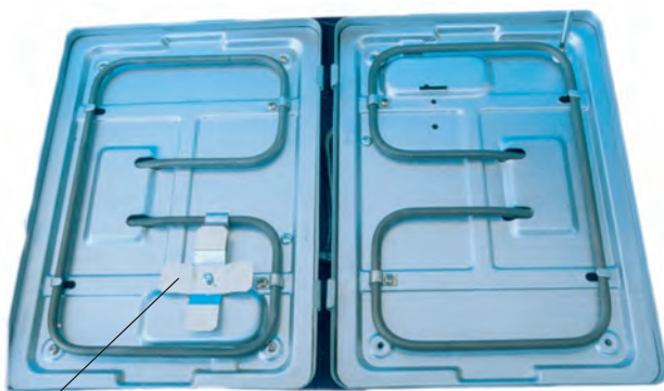
شکل ۱۹-۲ عضو حس کننده‌ی درجه حرارت ترموستات
