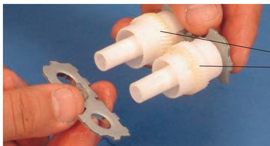
▲ قبل از نصب و مونتاژ چرخ‌دنده‌ها تمام قسمت دندانه‌های چرخ‌دنده‌ها را گریس کاری کنید (شکل ۳-۲۲۰).
