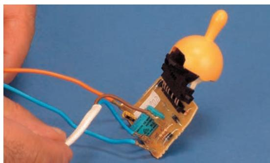
▲ هنگام مونتاژ مدار الکتریکی از نقشه‌ی مونتاژ مدار که در مراحل باز کردن ترسیم کرده‌اید استفاده کنید و ترمینال‌های مربوط به سیم رابط دستگاه و موتور را جابه‌جا نکنید (شکل ۳-۲۲۲).
