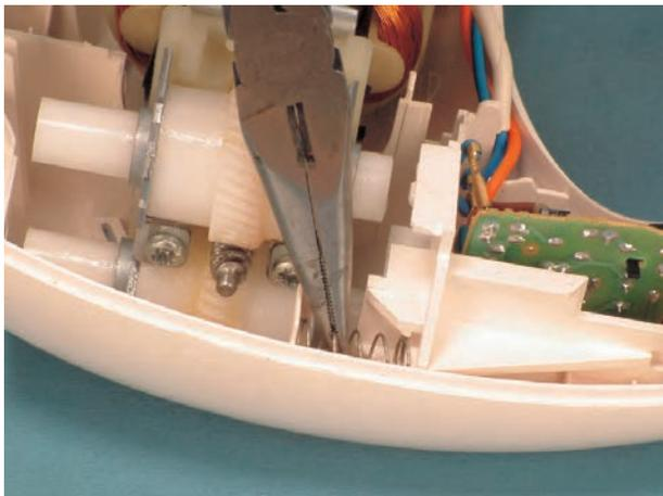
▲ به وسیله‌ی دم‌باریک فتر مربوط به قطعه‌ی پلاستیکی را که محور چرخ‌دنده‌ها روی آن نصب می‌شود در محل خود بگذارید تا قطعه‌ی پلاستیکی هنگام حرکت چرخ‌دنده‌ها انعطاف لازم را داشته باشد (شکل ۳-۲۲۵).
