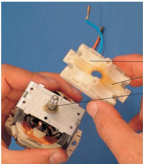
▲ قسمت دندانه‌دار محور آرمیچر و محل قرارگرفتن چرخ‌دنده‌ها را که در شکل ۳-۲۱۹ نشان داده شده است را گریس کاری کنید.
