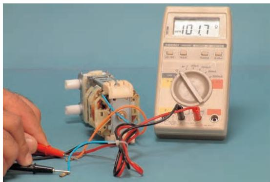
▲ قبل از سوار کردن موتور روی دستگاه به وسیله‌ی اهم‌متر از صحت مدار الکتریکی و عملکرد موتور مطمئن شوید (شکل ۳-۲۲۱).
