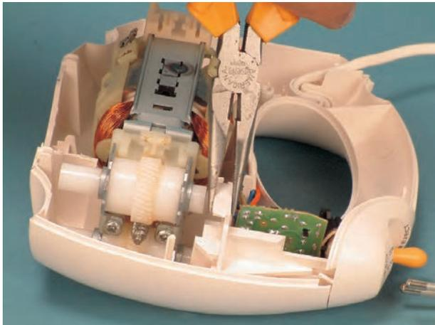
▲ پس از نصب موتور و کارت کنترل سرعت روی قاب بدنه قطعه‌ی پلاستیکی را که محور چرخ‌دنده‌ها روی آن سوار می‌شود به طور صحیح در محل خود قرار دهید (شکل ۳-۲۲۴).
