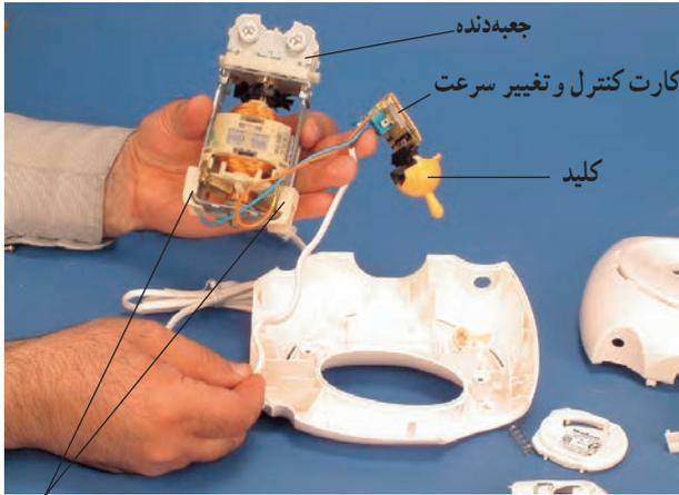
▲ قبل از نصب موتور و اجزای الکتریکی و الکترونیکی مدار روی قاب بدنه، لاستیک‌های لرزه‌گیر را روی موتور نصب کنید (شکل ۳-۲۲۳).
