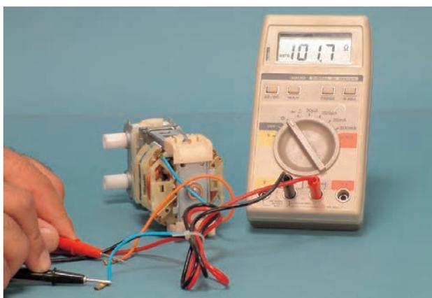
• در شکل ۳-۲۵۹ مقاومت کل مدار موتور شامل
