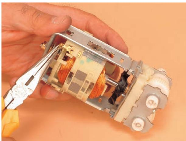
• قبل از باز کردن موتور یونیورسال، بست فلزی
