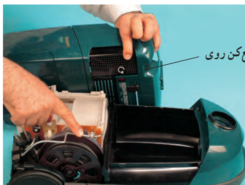
رابط میله‌ای اهرم ضامن سیم‌جمع‌کن شکل ۶-۲۰۷
