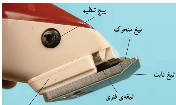
قاب پلاستیکی نگه‌دارنده‌ی تیغ ثابت
