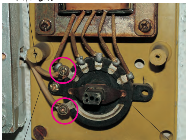
سیم رابط فاز ورودی به کلید
