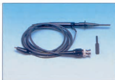
شکل ۸۵-۱ کاربرد کابل کواکسیال در پراب اسیلوسکوپ
