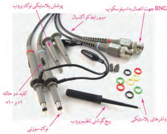
شکل ۵-۶ پروب و اجزای آن
