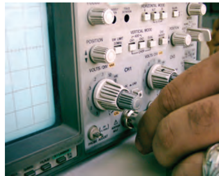
شکل ۶-۶ نحوه‌ی اتصال BNC به اسیلوسکوپ
