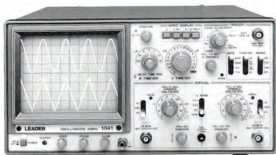
شکل ۳۵-۶ نمایش همزمان دو شکل موج توسط اسیلوسکوپ
