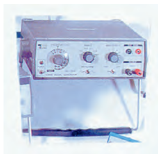
شکل ۳-۳۱- دستگاه سیگنال ژنراتور AF
