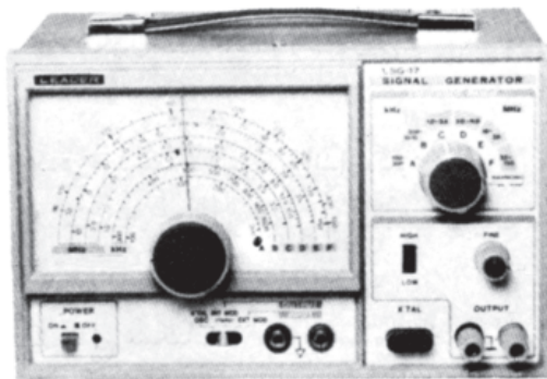
شکل ۲-۳۱ دستگاه سیگنال ژنراتور RF
