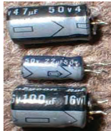
شکل ۳۸-۱ خازن‌های الکترولیتی با ظرفیت بالا
