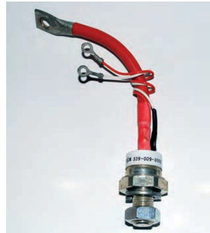
شکل ۳-۱- یک تریستور نوع استود
