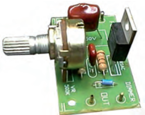
شکل ۵۵-۳- مدار ظاهری یک دایمر روشنایی
