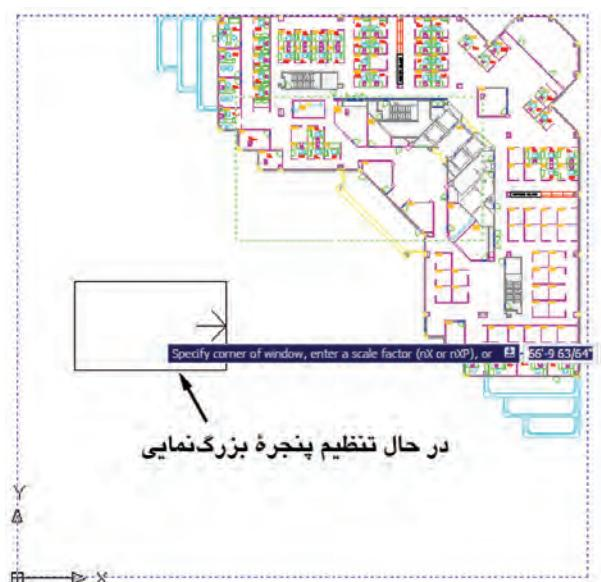
با کلیک دوم اندازه‌ی پنجره تنظیم می‌شود. حال، ماوس را حرکت می‌دهیم و بر روی بخشی از نقشه، که باید بزرگ‌نمایی شود، قرار می‌دهیم. سپس راست کلیک می‌کنیم. در پنجره‌ی بازشده، Enter را انتخاب می‌نماییم تا آن قسمت بزرگ‌نمایی شود.
