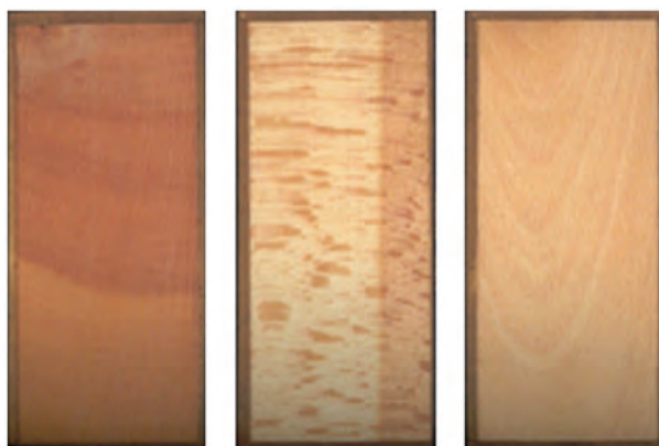
عرضی شعاعی مماسی شکل ۱۰-۱ چوب راش در سه برش عرضی، شعاعی، مماسی
