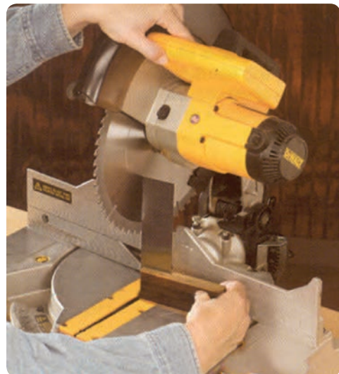
شکل ۷-۲ تنظیم عمود بودن تیغه پشت به صفحه
