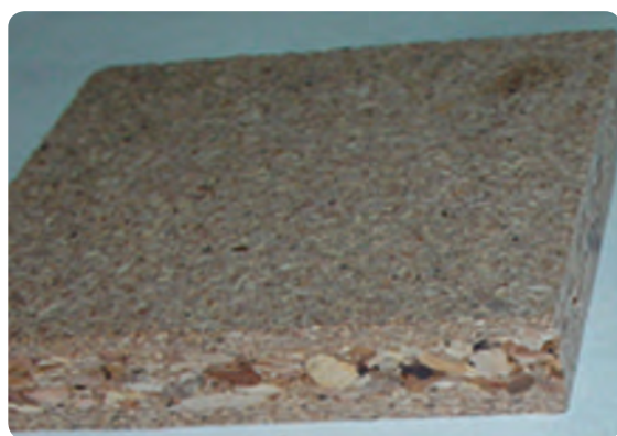
شکل ۱-۳۳ تخته خرده چوب سه لایه
