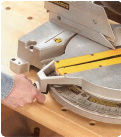
شکل ۸-۲ تنظیم زوایای مختلف برش
