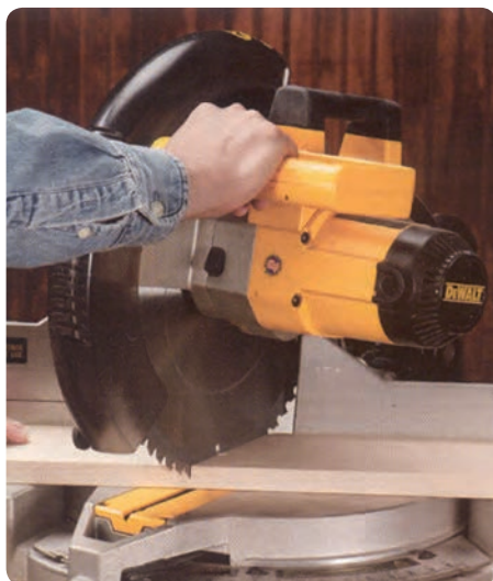
شکل ۲-۵ حرکت اهرمی در اره گرد فارسی بر
