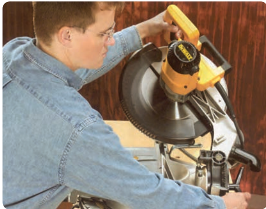
شکل ۹-۲ تنظیم زاویه چرخش اهر گرد
