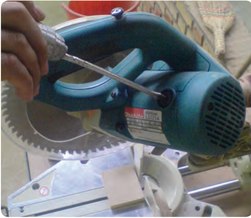
شکل ۲-۱۷ - بازدید زغال کلکتور موتور در ماشین اره گرد فارسی بر
