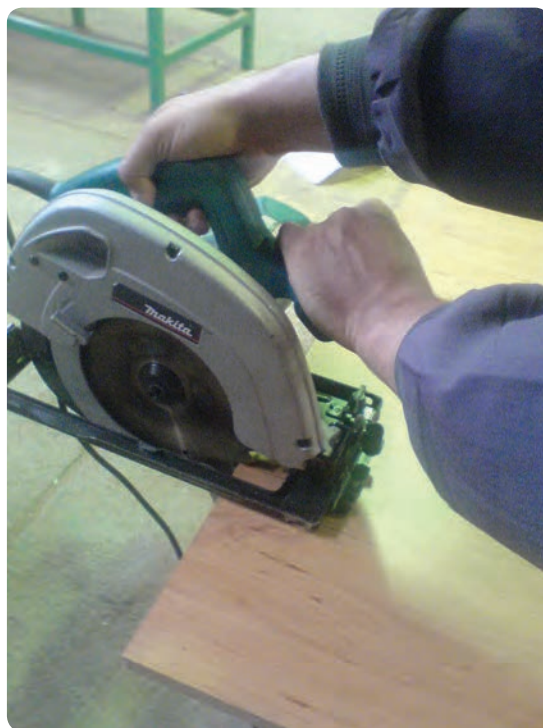
شکل ۲-۲۹ بیانگر رعایت نکردن اصول ایمنی در بکارگیری دستگاه که عامل بروز حادثه است
