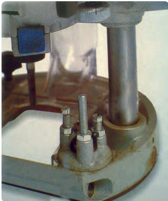
شکل ۲-۴۴ پیچ‌های تنظیم ارتفاع اور فرز دستی برقی
