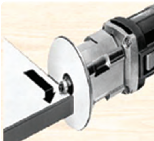
شکل ۱۵۵-۲ پرداخت لبه‌های اضافی روکش مصنوعی
