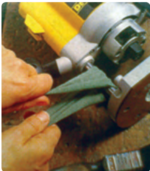
شکل ۲-۶۶ تمیز کردن میله‌های کنسویی اورفرز
