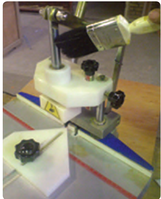
شکل ۱۱۶-۲ تمیز کردن مفصل‌های حرکتی ماشین دم چلچله‌زن
