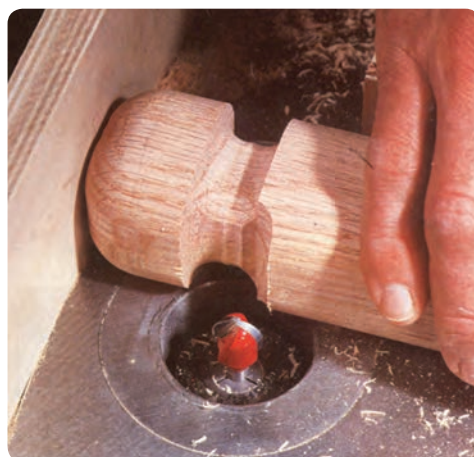
شکل ۲-۶۴ فرز زدن گلوبی یک پایه
