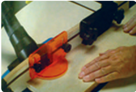
شکل ۲-۷۵ رعایت حفاظت ایمنی در فرزکاری
