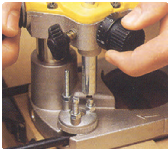
شکل ۷۲-۲ پیچ‌های تنظیم دستگاه
