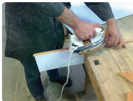
شکل ۱۴۷-۲ اتوکشی نوار روکش لبه چسبان
