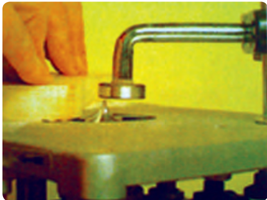
شکل ۲-۶۵ بلبرینگ هدایت برای قطعات قوس‌دار
