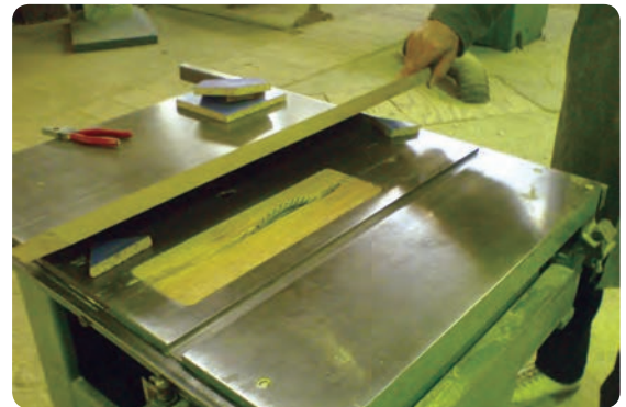
شکل ۳-۳۹ قراردادن دوعدد زیرسری برای ساخت گونیا
