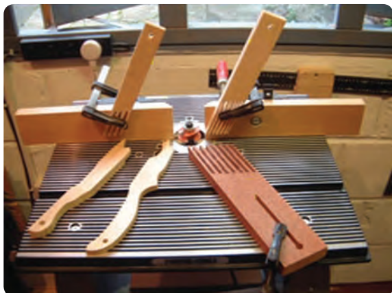
شکل ۳-۲۸ شانه‌های حفاظتی به صورت عمودی
