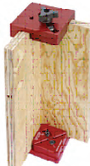
شکل ۳-۳۶ مونتاژ پانل‌های عمودی
