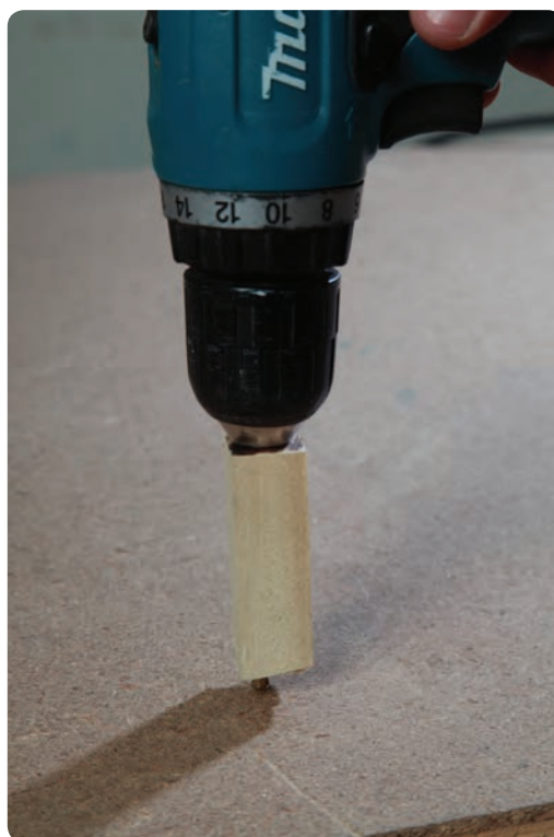
شکل ۳-۳۲ سوراخ دریل قطعه کنترل اندازه عمق
