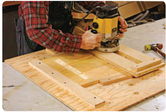
شکل ۳-۲۹ شابلون تسریع کننده و حفاظتی اورفرز
