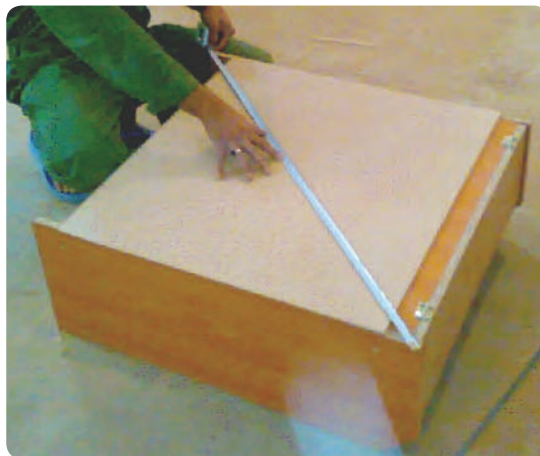
شکل ۱۳۰-۶ کنترل دویدگی کابینت
