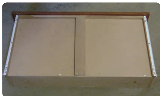
شکل ۶-۱۱۳ نصب قید کمرکش در کنسولهای بزرگ
