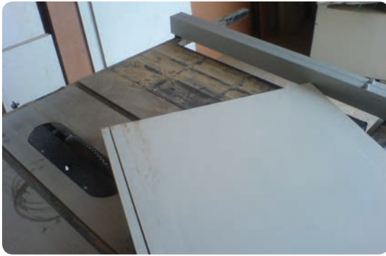
شکل ۶-۶۹- کنشکاف زدن جهت پشت بند
