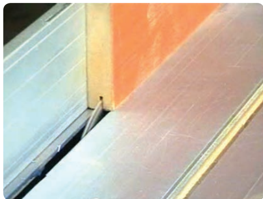
شکل ۶-۹۰ دو راهه کردن با ماشین اره مجموعه‌ای
