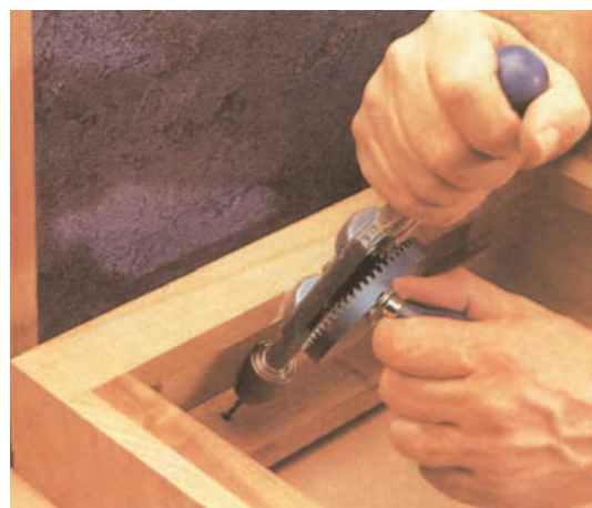
شکل ۶-۱۶۱ مونتاژ صفحه میز به قاب دراور
