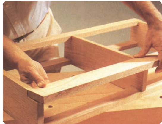
شکل ۶-۱۵۵ مونتاژ کلاف قاب دراور
