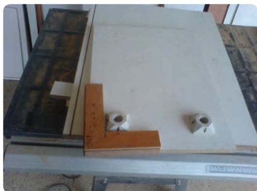
شکل ۶-۱۱۴ شابلون گونیايي جهت نصب پایه کابینت
