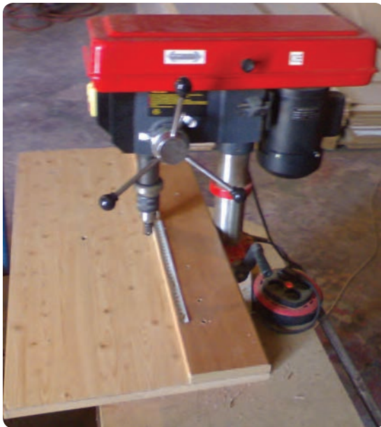
شکل ۶-۷۰- دریل ستونی همراه با شابلن جهت سوراخ‌کاری
