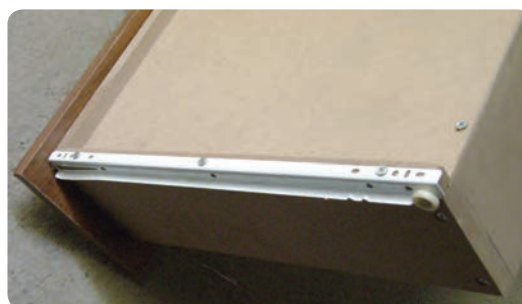
شکل ۶-۱۱۲ نصب ریل مکانیکی در زیر بدنه جعبه
