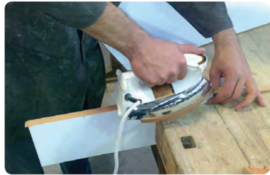
شکل ۶-۸۱ لبه چسبانی روکش مصنوعی با اتو
