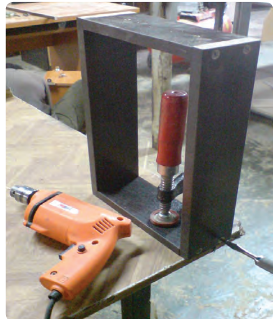
شکل ۶-۱۰۸ مونتاژ دستی جعبه کشو
