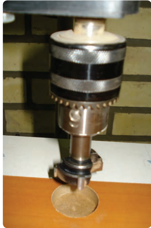
شکل ۶-۷۱ مته کابینت جهت سوراخ کردن جای لولا
