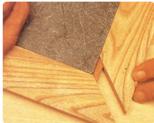
شکل ۶-۱۵۲ مونتاژ صفحه میز
