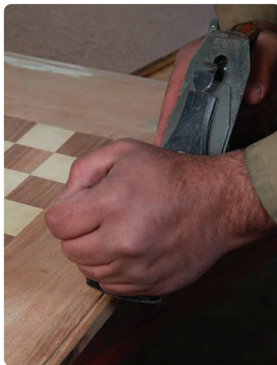
شکل ۶-۷۹ رنده کردن زهوار چوبی
