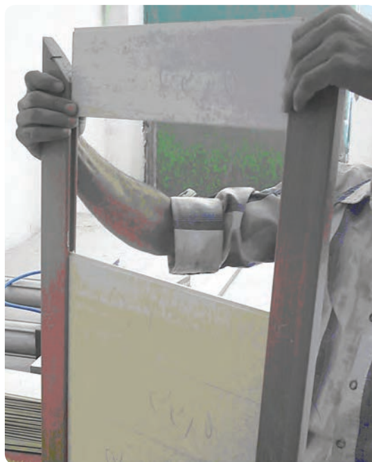
شکل ۶-۹۵ مونتاژ در قابدار با تنگ لته‌ای
