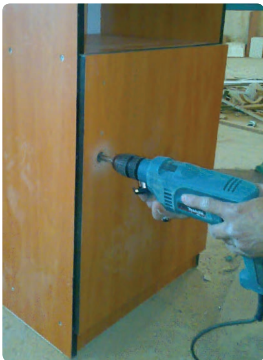
شکل ۱۲۳-۶ در آوردن جای قفل سوئیچی
