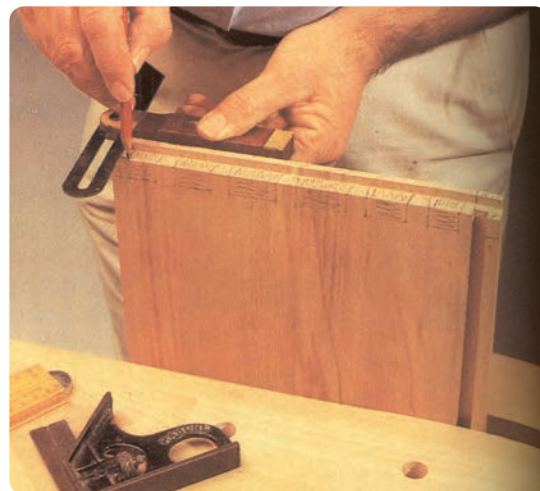
شکل ۶-۱۳۶ خط‌کشی اتصال دم‌چلچله دورو مخفی
