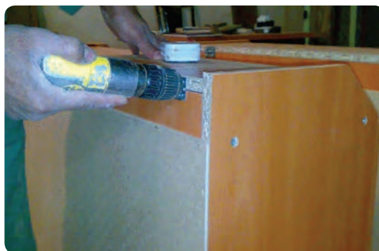
شکل ۱۳۱-۶ نصب لولای محفظه جاواکسی
