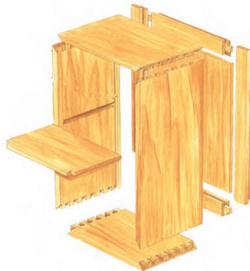
شکل ۶-۱۳۳ پرسپکتیو انفجاری کابینت
