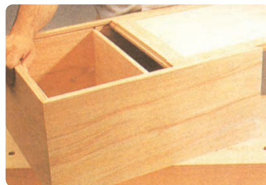
شکل ۱۴۳-۶ قرارگیری پشت بند در کنشکاف بدنه کابینت
