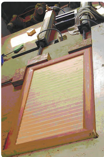
شکل ۶-۹۷ تنگ نیوماتیکی جهت مونتاژ در قابدار کابینت
