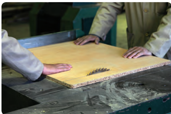
شکل ۶-۷۷ برش در ساده کابینت
