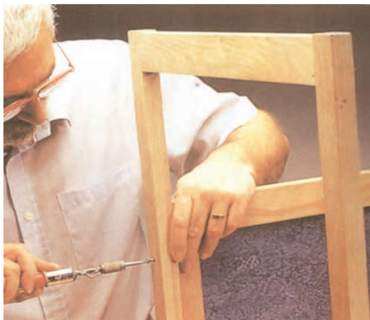
شکل ۶-۱۶۰ مونتاژ قاب پشت با قاب کناری
