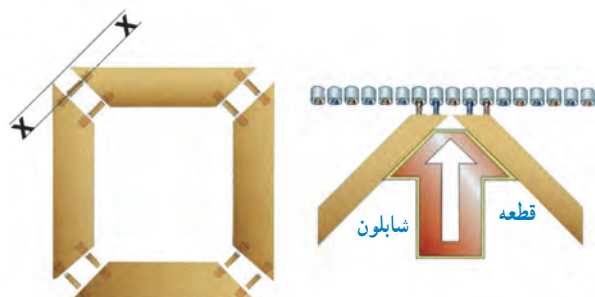
شکل ۱۶-۲- ب- روش ساخت اتصال قاب فارسی، به وسیله دویل زن ماشینی
