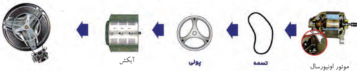
شکل ۱-۱۴۵-الباسشویی اتوماتیک با انتقال نیروی غیرمستقیم
