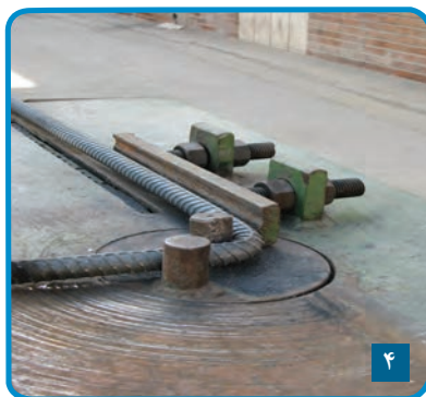
شکل ۳-۶۴ خم کردن میلگرد
