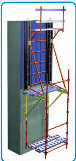
شکل ۲۰-۳- قالب رونده (لغزنده)
