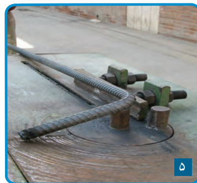
شکل ۳-۶۴ خم کردن میلگرد
