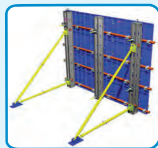
شکل ۳-۱۲- اجزاء قالب‌بندی
