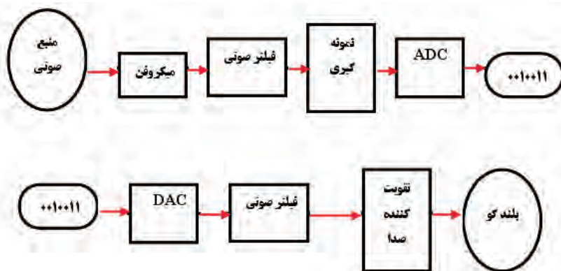
شکل ۵-۸ عملکرد ADC و DAC
