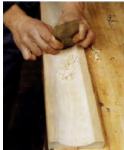
شکل ۲-۵- کاربرد لیسه با لبه‌ی نیم گرد.
