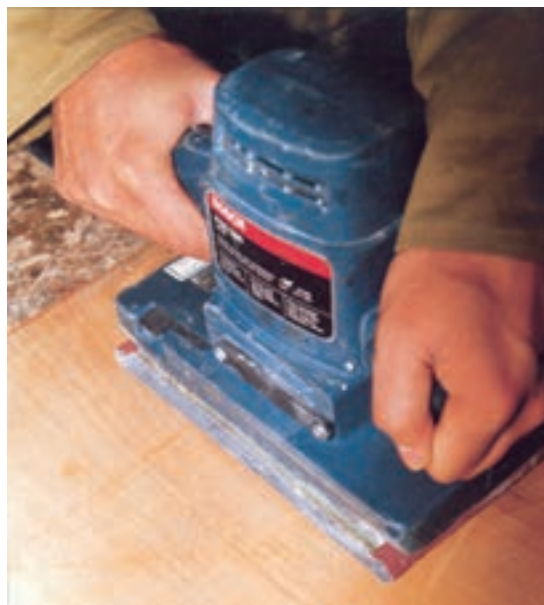
شکل ۷-۱۱. سنباده کاری در جهت الیاف.
