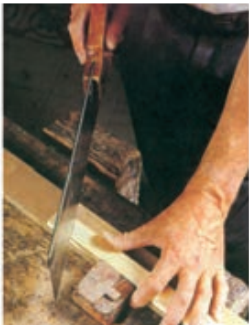
شکل ۱۱-۱۰. برش زهوار، با زاویه‌ی ۴۵ درجه.
