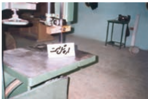
شکل ۵-۹- وقتی تیغه اره شل است، ممتماً از تابلوی مربوطه استفاده کنید.
