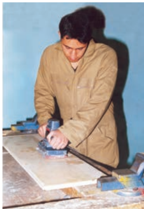
شکل ۷-۱۰. پیچونگی کنترل دستگاه سنباده لرزان.
