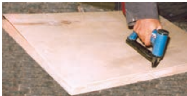
شکل ۶-۲۱- ثابت کردن (روکش روی صفمه‌ی کار) توسط منگنه.
