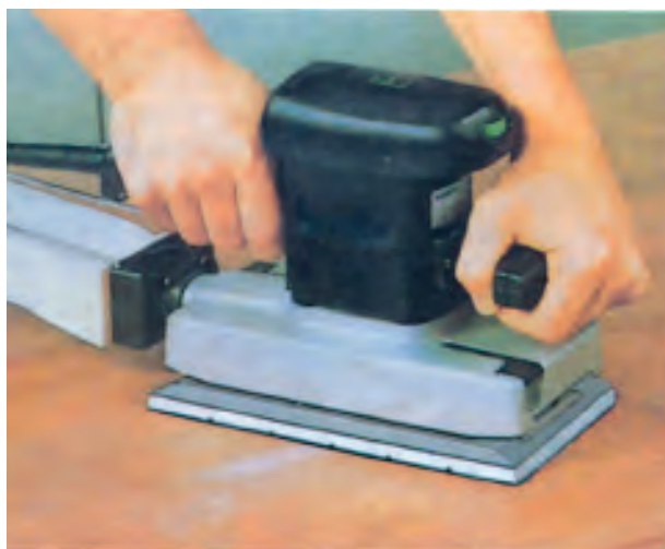
شکل ۳-۱۴- سنباده‌زنی با یک دستگاه سنباده لرزان کامل.
