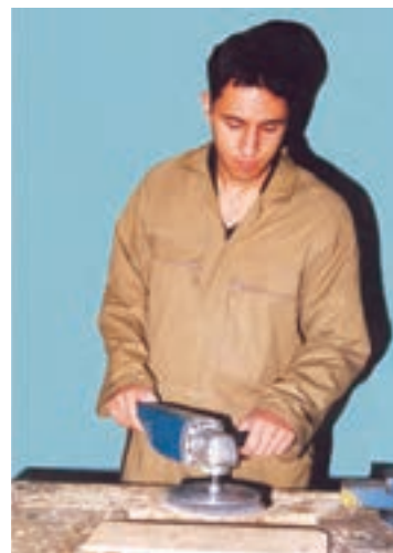
شکل ۷-۴۰- هدایت و کنترل صمغ دستگاه سنباده.
