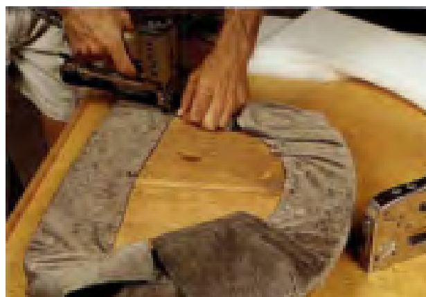
شکل ۸-۵. کاربرد منگنه در (رویه‌کوبی).
