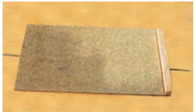
شکل ۹-۶۷- پسباندن زهوار به لبه‌ی کف جعبه.
