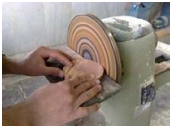
شکل ۱۹۱-۱۲. پرداخت قطعه چوب دایره شکل.
