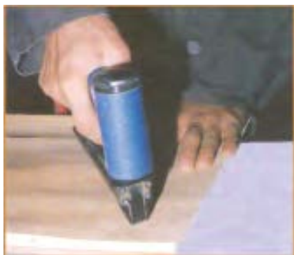
شکل ۵-۳۳. کار با دستگاه منگنه
