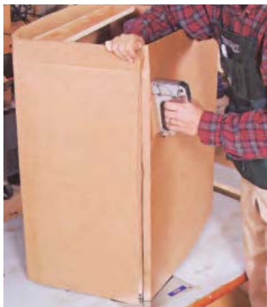
شکل ۸-۲۲- کاربرد منگنه‌ی دستی در بسته‌بندی کالاها.
