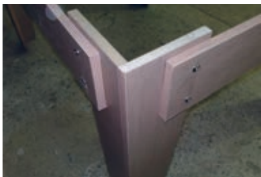
شکل ۱۲-۱۶- اتصال پایه به قید توسط پیچ فیکس.
