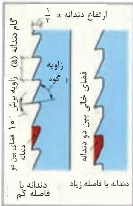
شکل ۱- تیغ اره نواری مناسب برش های طولی
