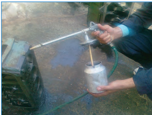
شکل ۱-۳- باز کردن مخزن پیستوله شستشو
