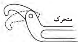
شکل ۵۹-۳- نحوه استفاده از آچار مهره‌ای گرد
