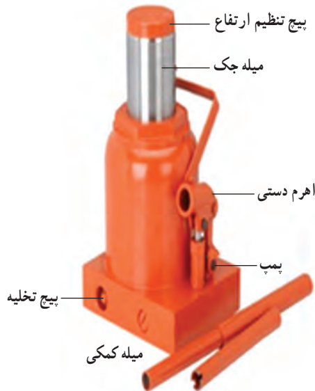
شکل ۹-۴- اجزای جک روغنی
